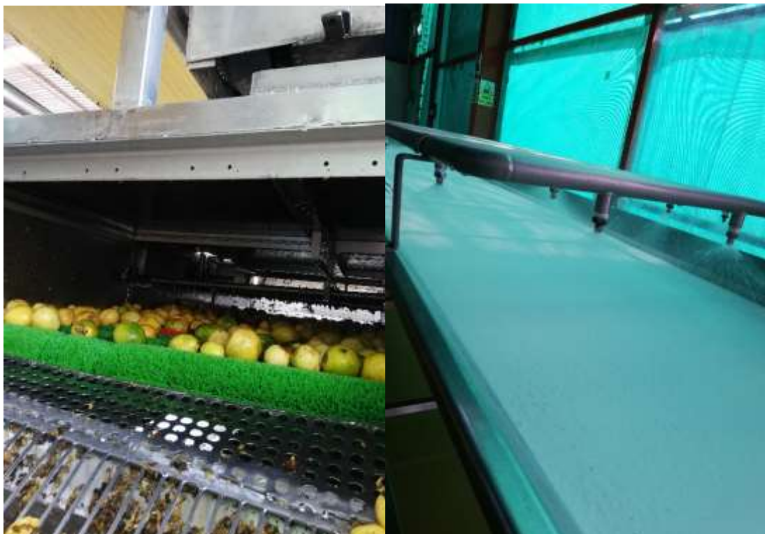
Figura 15. Sistema de cepillado y enjuague de materia prima. Fuente: Quicornac SAC
