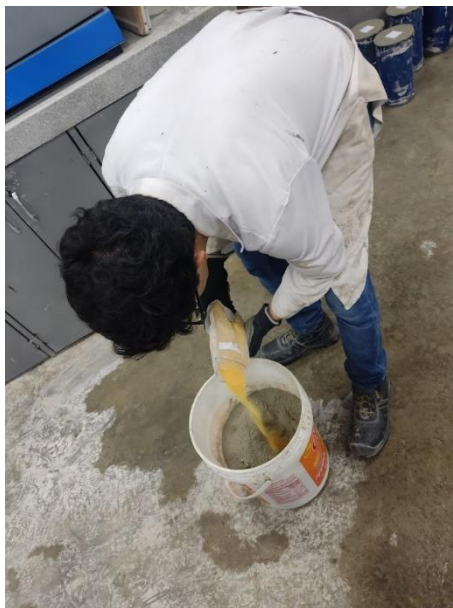
Ilustración 28: Mezclado de la adicción con el cemento para la mezcla
