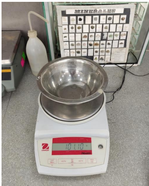
Ilustración 5: Peso del recipiente del agregado fino
