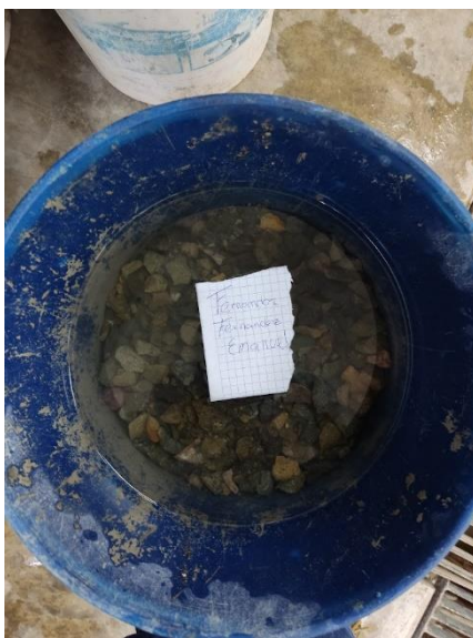
Ilustración 17: Agregado grueso reposando durante 24 horas
