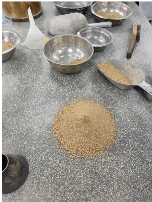
Ilustración 14: Agregado en estado saturado superficialmente seco
