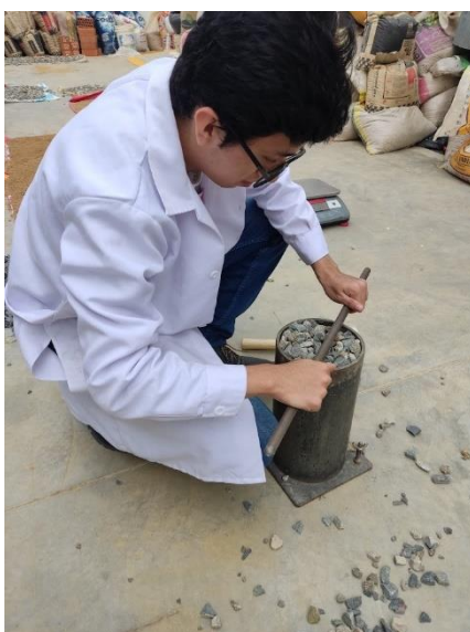
Ilustración 22: Enrasado de la muestra
