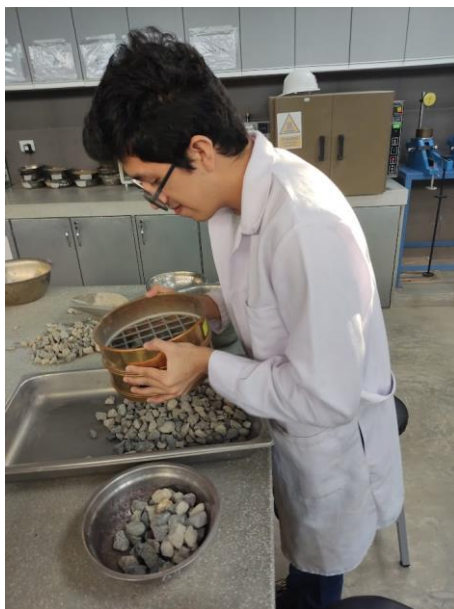
Ilustración 9: Tamizado del agregado grueso
