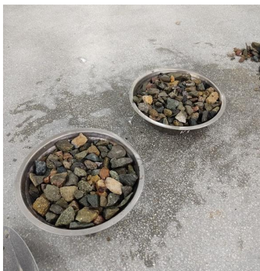
Ilustración 18: Muestras de agregado saturado superficialmente seco
