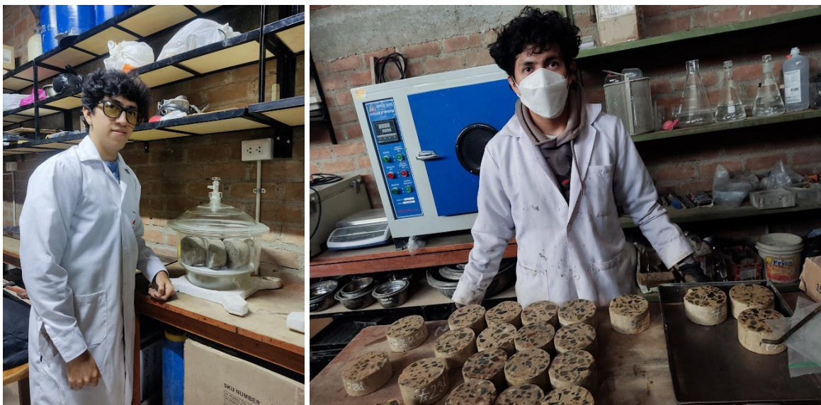
Ilustración 42: Acondicionamiento de la muestra para la velocidad de absorción
