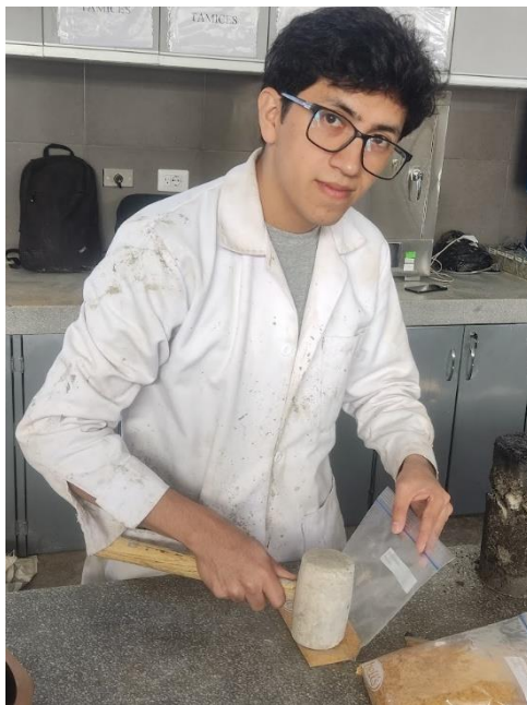
Ilustración 26: Pulverización de la cera de carnauba
