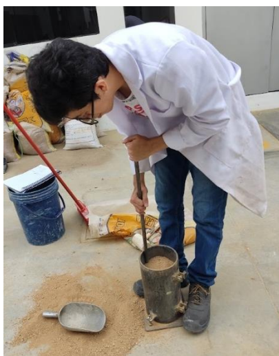
Ilustración 24: Compactación del agregado fino
