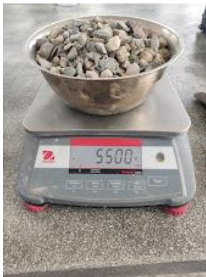
Ilustración 8: Peso del agregado grueso para granulometría
