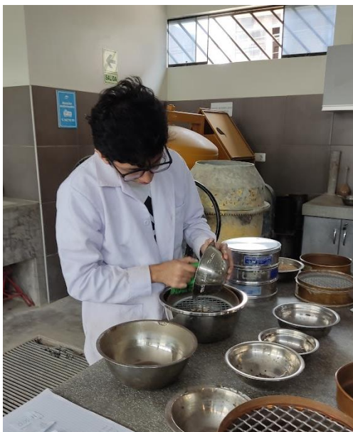
Ilustración 6: Tamizado del agregado fino
