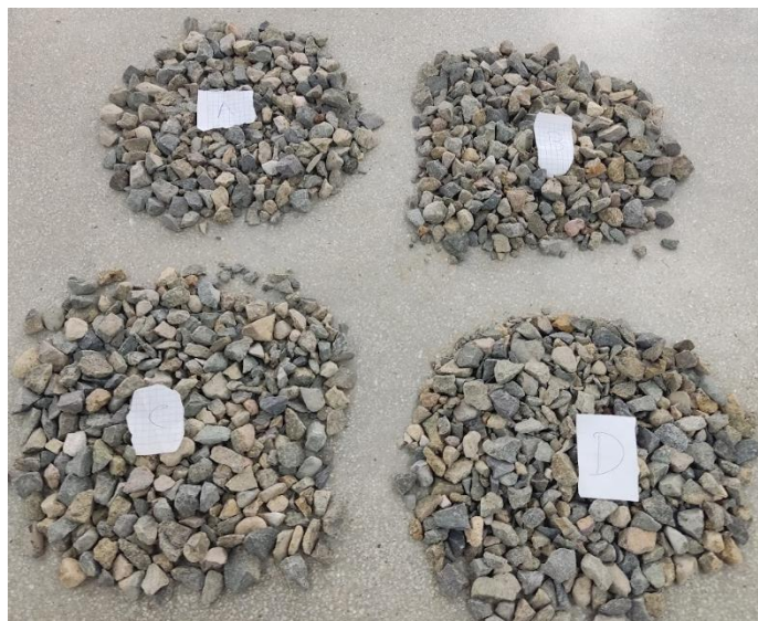
Ilustración 7: Cuarteo del agregado grueso
