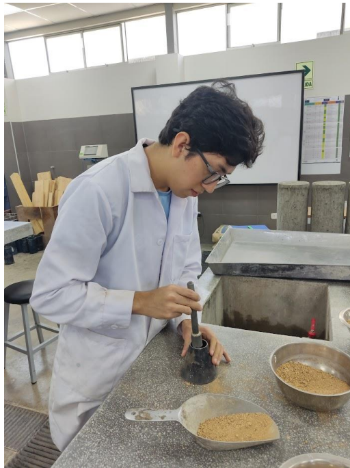
Ilustración 13: Prueba del humedad superficial
