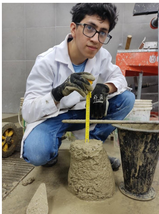
Ilustración 30: Medición del asentamiento de la mezcla
