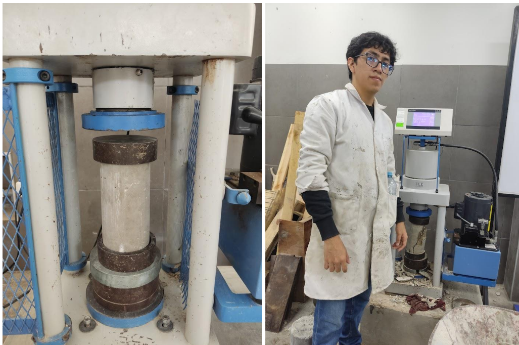
Ilustración 37: Colocación y rotura de la probeta en la prensa
