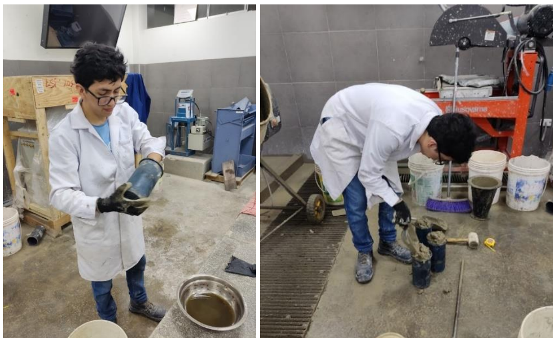
Ilustración 35: Aplicación de desmoldante y compactación de la mezcla
