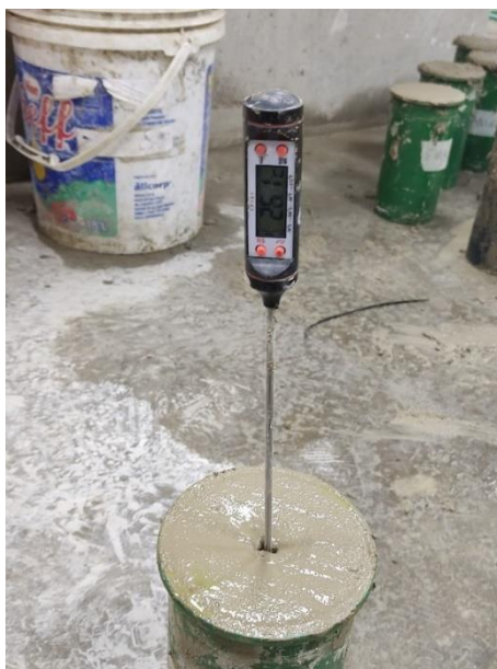
Ilustración 34: Medición de la temperatura de la mezcla
