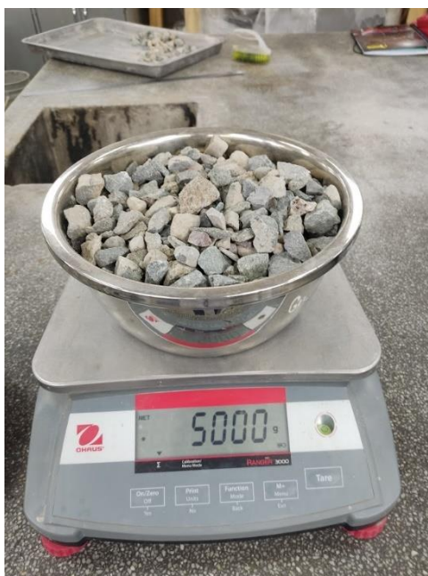
Ilustración 11: Peso de agregado grueso para el ensayo de contenido de humedad
