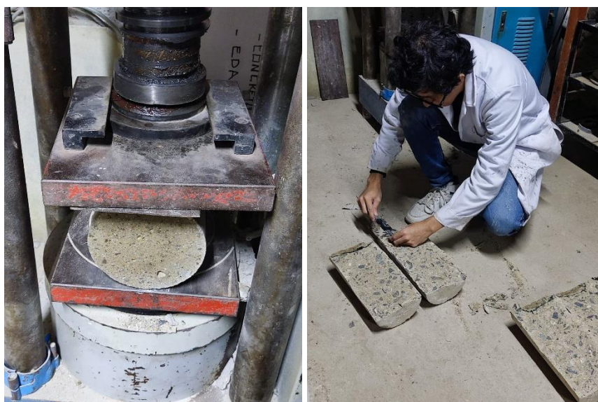
Ilustración 41: Rotura y medición de muestras
