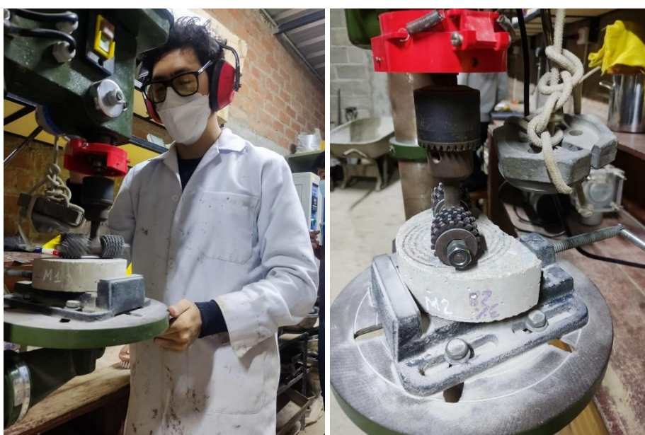
Ilustración 38: Aplicación del taladro de desgaste
