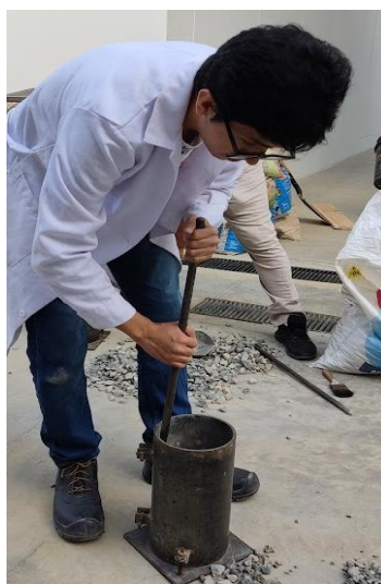
Ilustración 23: Compactación del agregado grueso
