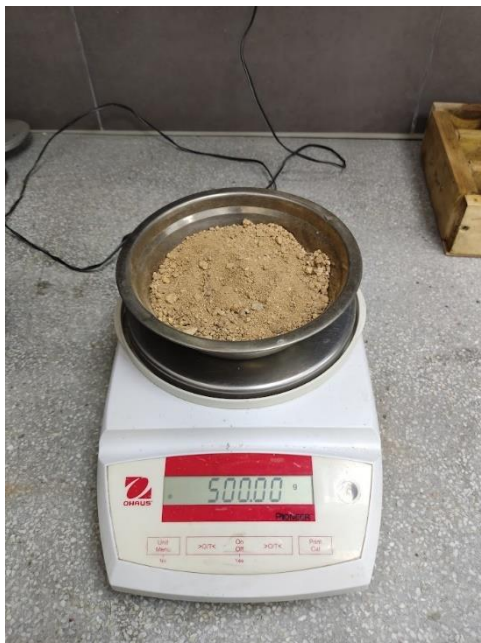
Ilustración 10: Peso de agregado fino para el ensayo de contenido de humedad
