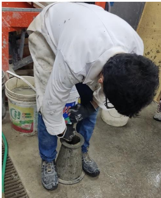
Ilustración 29: compactación de la mezcla
