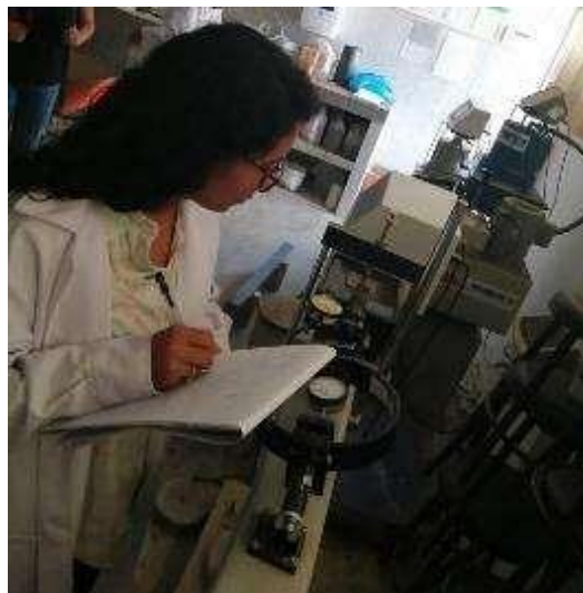
Fotografía 19. Ensayo de Corte Directo
