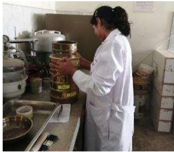
Fotografía 15. Ensayo de granulometría realizado con tamizado
