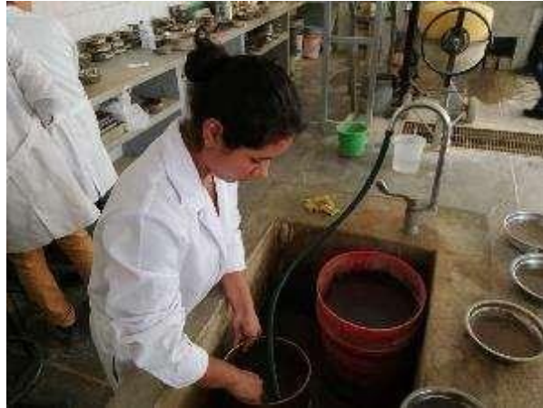
Fotografía 14. Lavado de muestras para ensayo de granulometría
