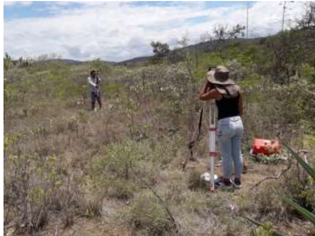
Fotografía 6. Levantamiento de puntos haciendo uso de estación total y prisma
