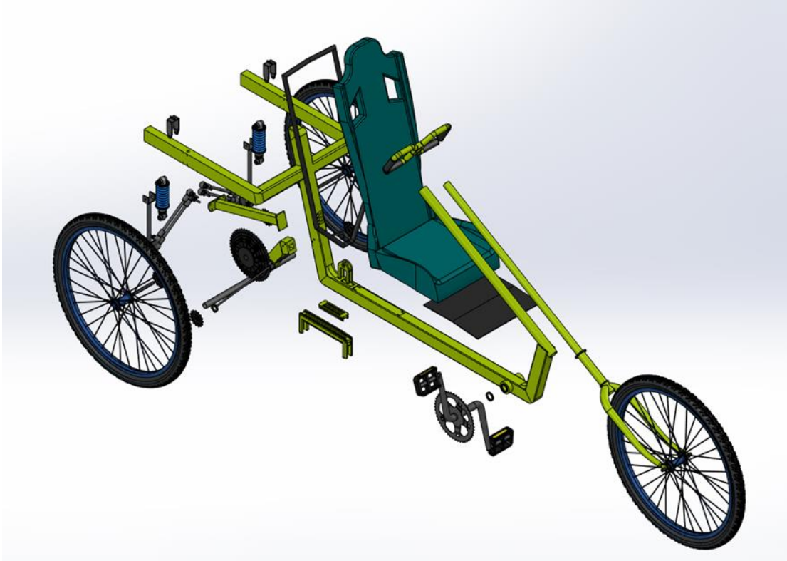
Fig. 28: Vista explosionada con subsistemas
