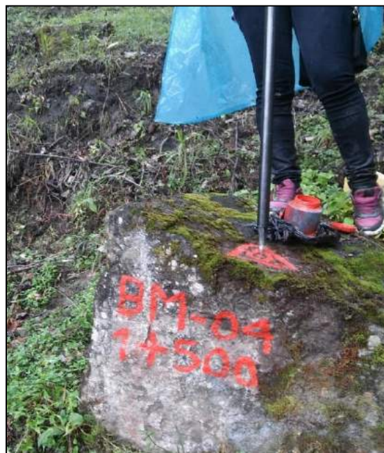
FIGURA N° 56 Ubicación de BM-03 y BM-04 en roca con su respectiva descripción
