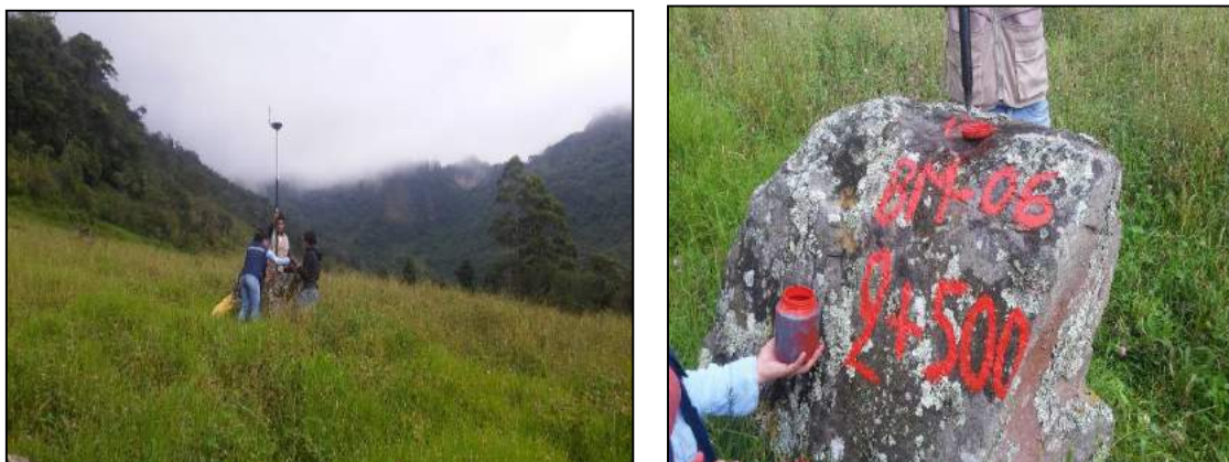
FIGURA N° 58: Ubicación de BM-06 en roca con su respectiva descripción
