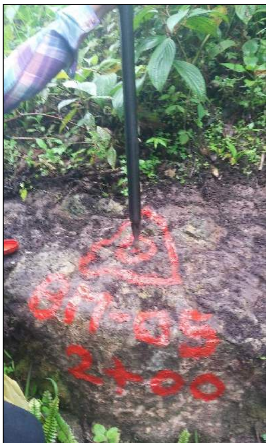
FIGURA N° 57: Ubicación de BM-05 en roca con su respectiva descripción
