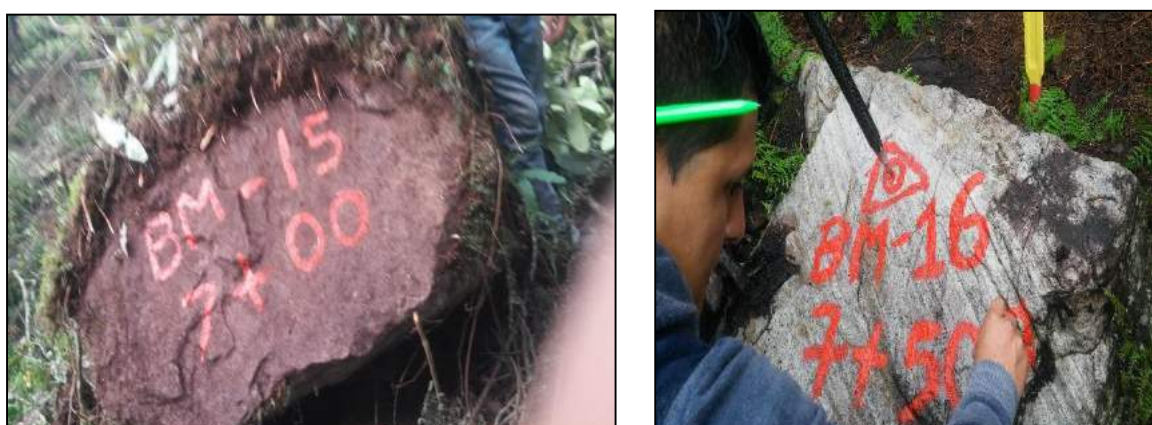
FIGURA N° 63: Ubicación de BM-015 y BM-16 en roca con su respectiva descripción
