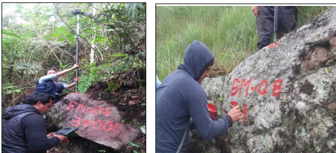
FIGURA N° 59: Ubicación de BM-07 y BM-08 en roca con su respectiva descripción
