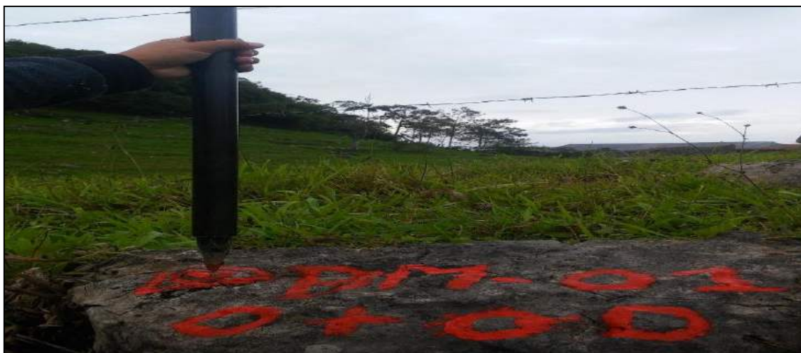
FIGURA N° 53: Ubicación de BM-01 en roca con su respectiva descripción
