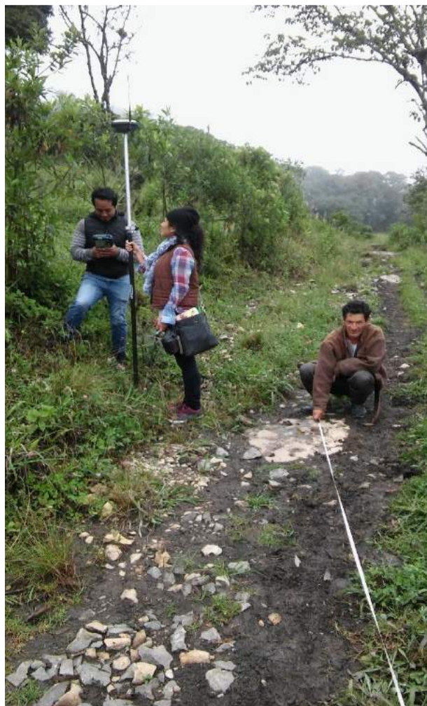
FIGURA N° 75: Toma de Puntos con GPS y considerando las pendientes con eclímetro
