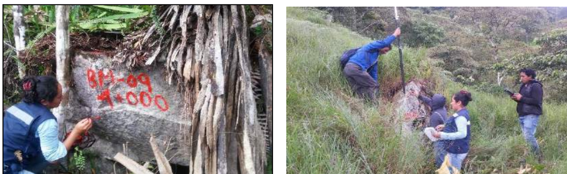
FIGURA N° 60: Ubicación de BM-09 y BM-10 en roca con su respectiva descripción
