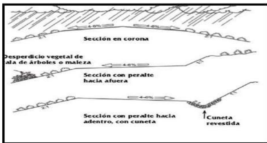
FIGURA N°3: Peralte hacia adentro y hacia afuera
