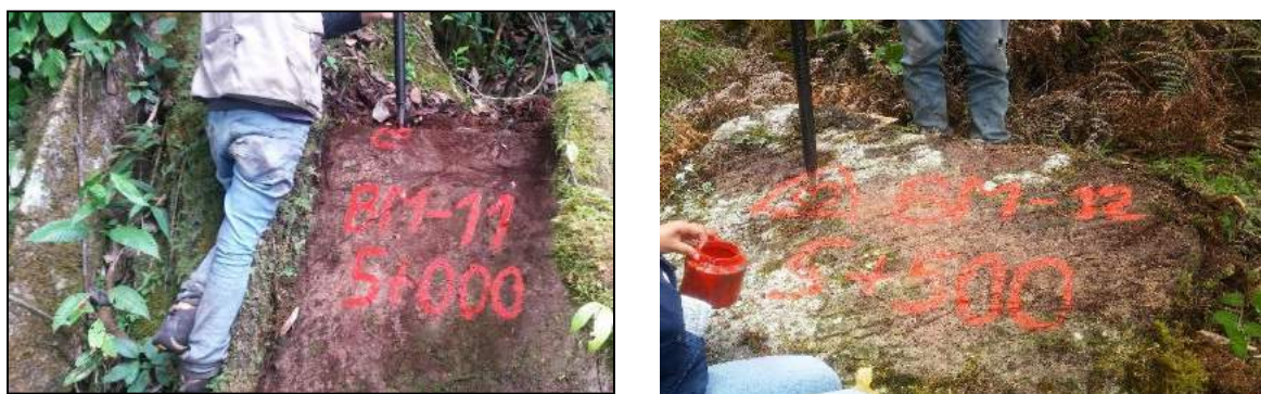
FIGURA N° 61: Ubicación de BM-011 y BM-12 en roca con su respectiva descripción
