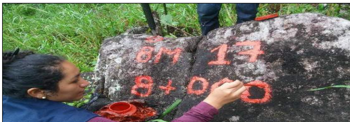
FIGURA N° 64: Ubicación de BM-017 en roca con su respectiva descripción
