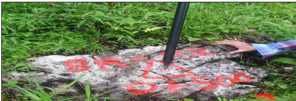
FIGURA N° 55: Ubicación de BM-02 en roca con su respectiva descripción
