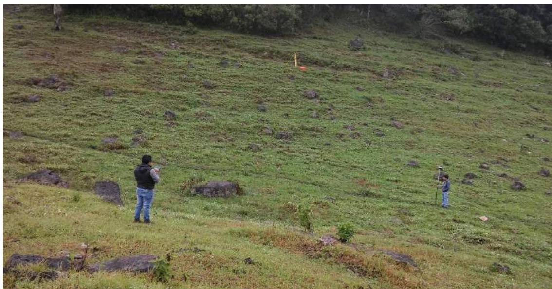
FIGURA N° 71: Toma de Puntos y seccionando con wincha cada 20m
