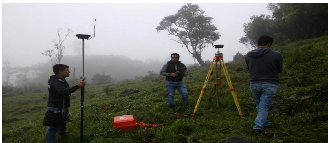
FIGURA N° 65: Estación N° 01 de GPS Diferencial
