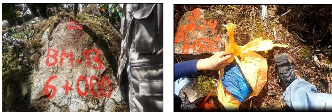
FIGURA N° 62: Ubicación de BM-013 y BM-14 en roca con su respectiva descripción
