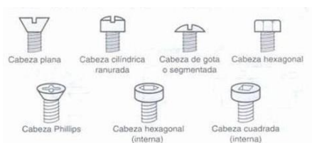
Figura 9. Estilos de Cabezas de Pernos
