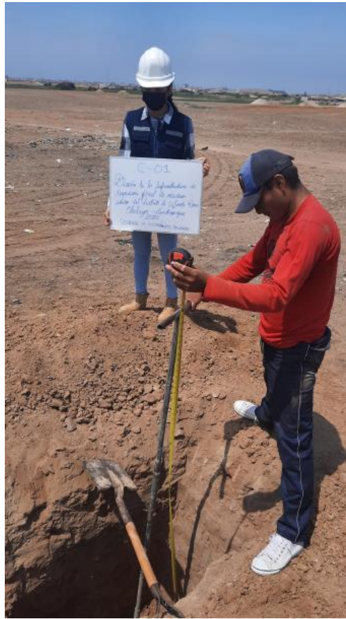
Fotografía 1. Calicata 01 ubicada en el área proyectada para la zona administrativa
