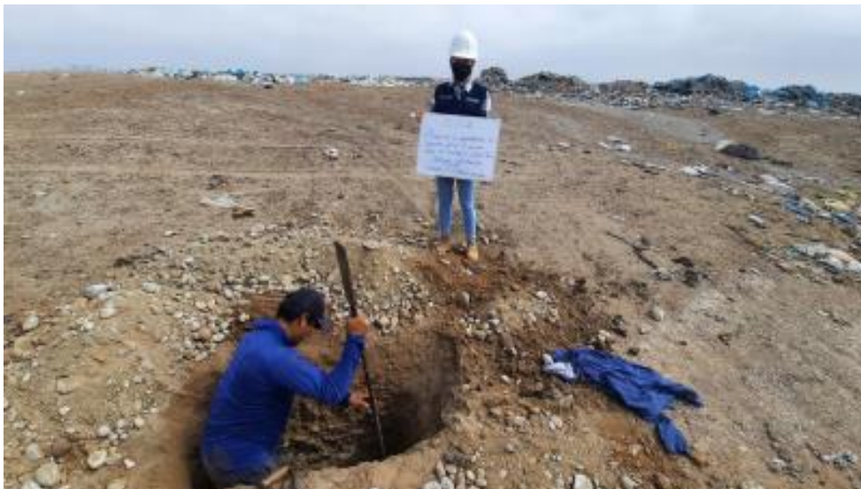
Fotografía 2. Calicata 02: Calicata ubicada en la trocha carrozable
