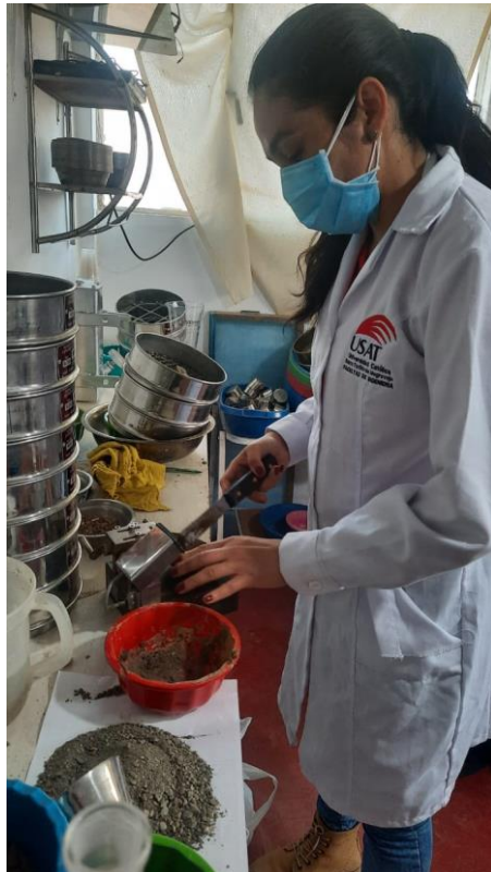
Fotografía 4. Ensayo de límites de Atterberg.
