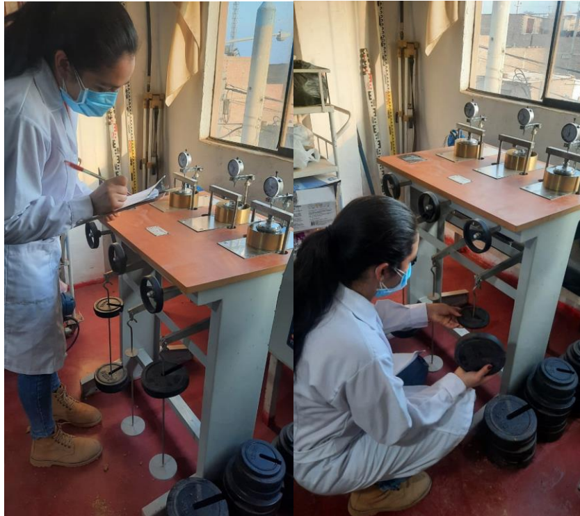
Fotografía 5. Ensayo de Consolidación.
