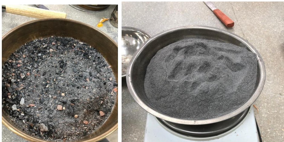
Ilustración 29: Tamizado de la ceniza de ladrillera
