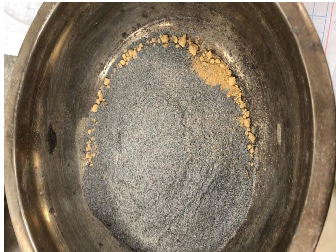
Ilustración 32: Mezcla de la ceniza con el suelo natural seco
