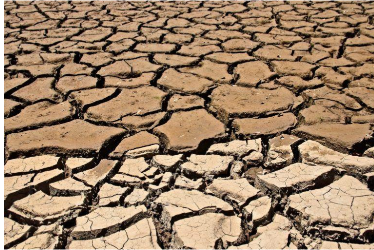
Ilustración 6: Características expansivas de suelo arcilloso.
