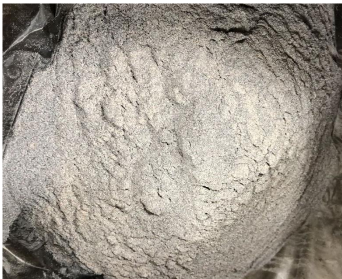
Ilustración 34: Ceniza tamizada por la malla N°100.
