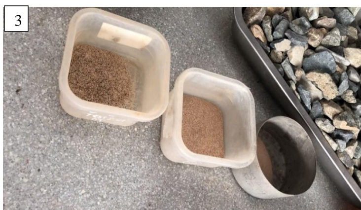
Ilustración 19: Ensayo de Granulometría en el laboratorio
