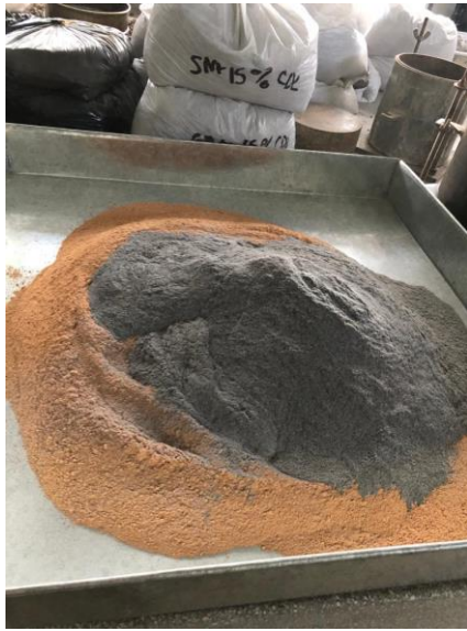
Ilustración 32: Mezcla de la ceniza con el suelo natural seco
