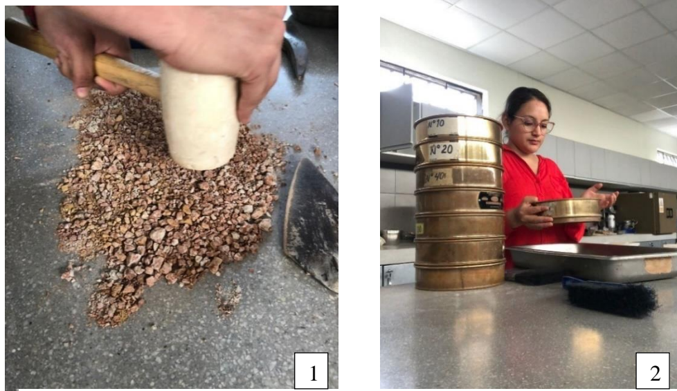
Ilustración 18: Ensayo de Granulometría en el laboratorio
