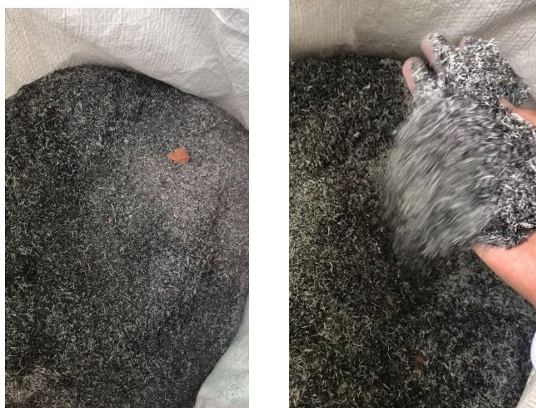
Ilustración 17: Ceniza procedente de ladrillera artesanal
