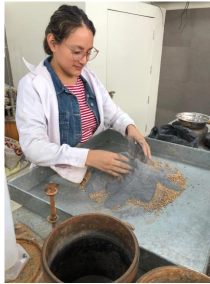
Ilustración 32: Mezcla de la ceniza con el suelo natural seco
