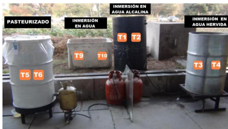
Figura 19. Tratamiento de desinfección de los sustratos.
