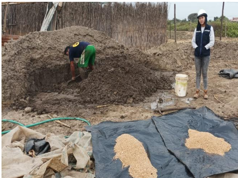
Figura 30. Separación de los porcentajes de micelio de hongo y separación de mezcla
