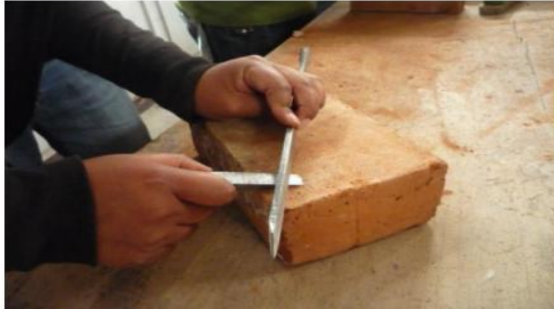
Figura 2. Determinación de la variación dimensional de un ladrillo macizo
