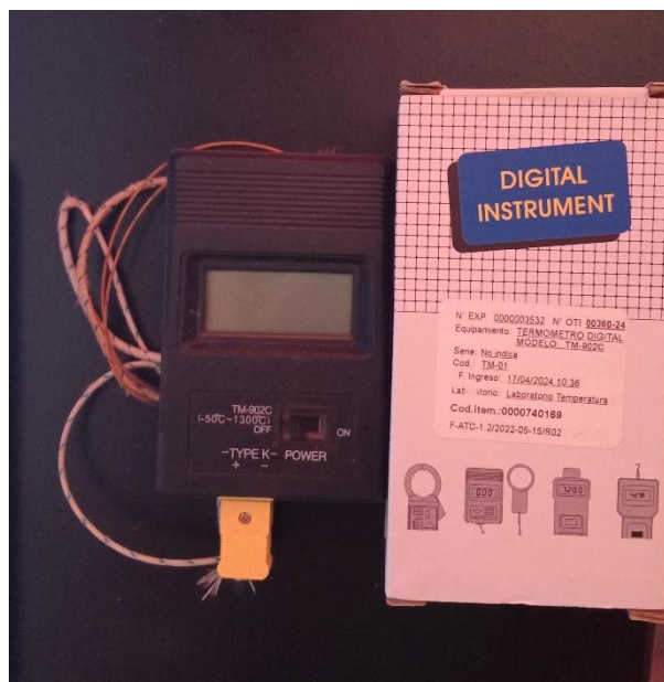
Figura 4 Termocupla tipo K para placa fría y placa caliente
