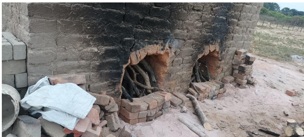
Figura 36 Colocación de leña para su posterior sellado.
