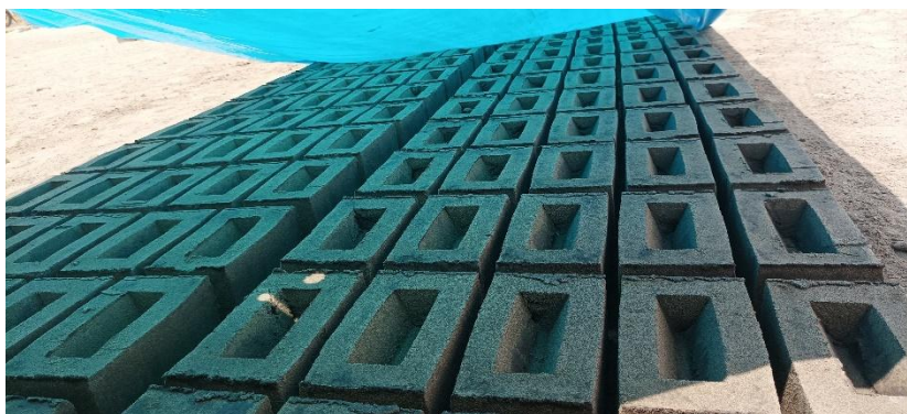
Figura 33. Se realizó el secado por aproximadamente 7 días para que el micelio se expanda y el ladrillo se encuentre seco.
