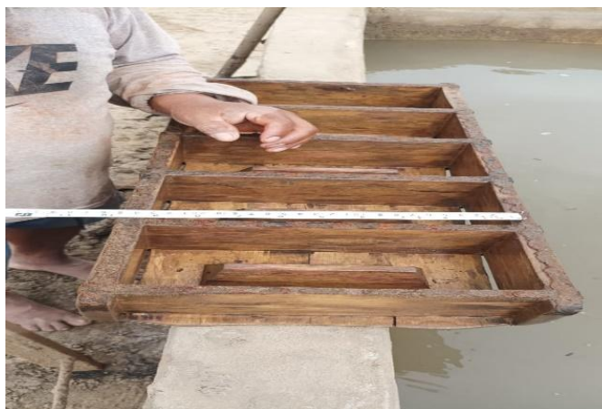
Figura 31. Moldes de madera (gavera) para el uso de bloques de arcilla macizos artesanales.
