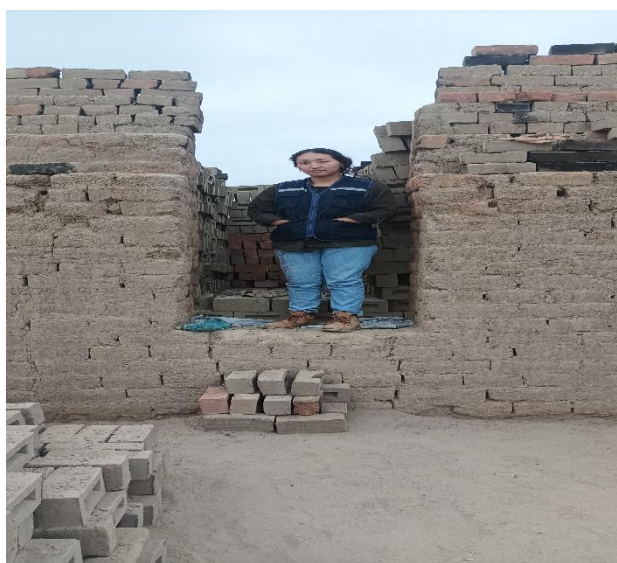
Figura 35 colocación de bloques de arcilla para la cocción respectiva.
