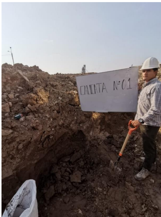
Ilustración 7_Extracción de la muestra de suelo, C-01
