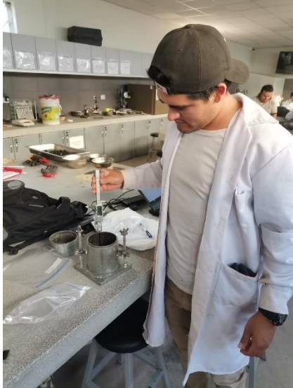
Ilustración 34_Toma de mediciones del molde Proctor
