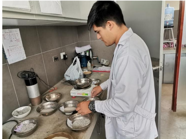
Ilustración 26_Tamizado de muestras
