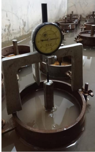
Ilustración 22_Inmersión de la muestra compactada
