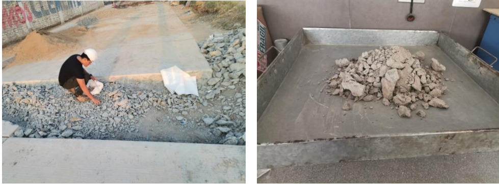
Ilustración 24_Recolección de muestras de RCD-C
