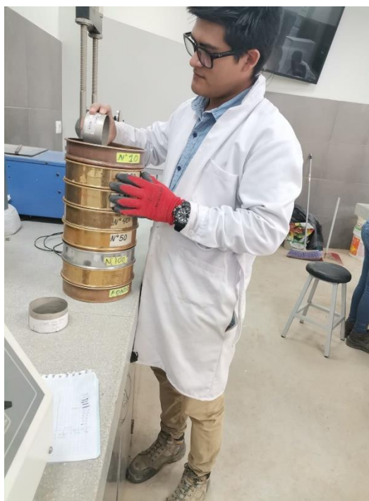
Ilustración 15_ Tamizado de las muestras
