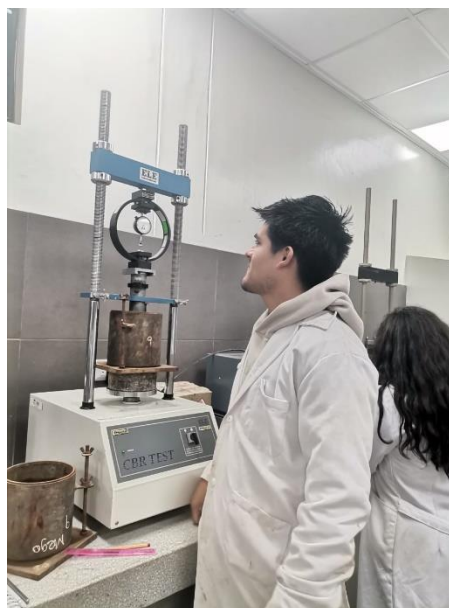
Ilustración 38_ Toma de resultados Fase de Penetración
