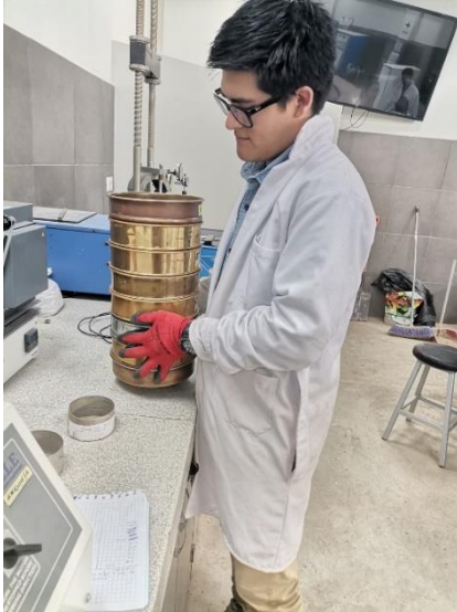
Ilustración 26_Tamizado de muestras
