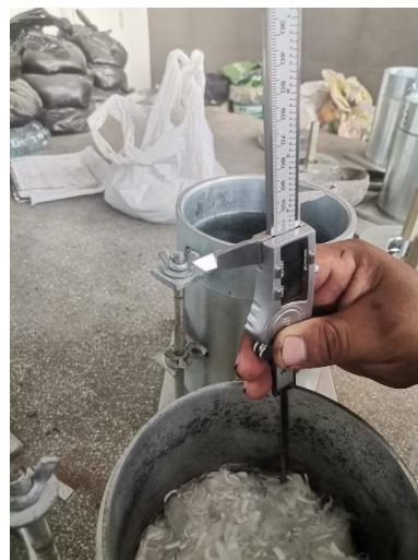
Ilustración 36_Medición de altura óptima para Fibra de polipropileno
