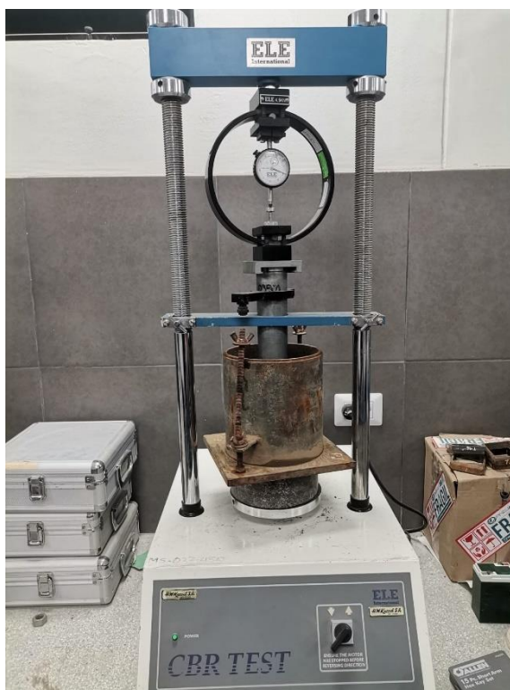
Ilustración 23_Penetración de muestra
