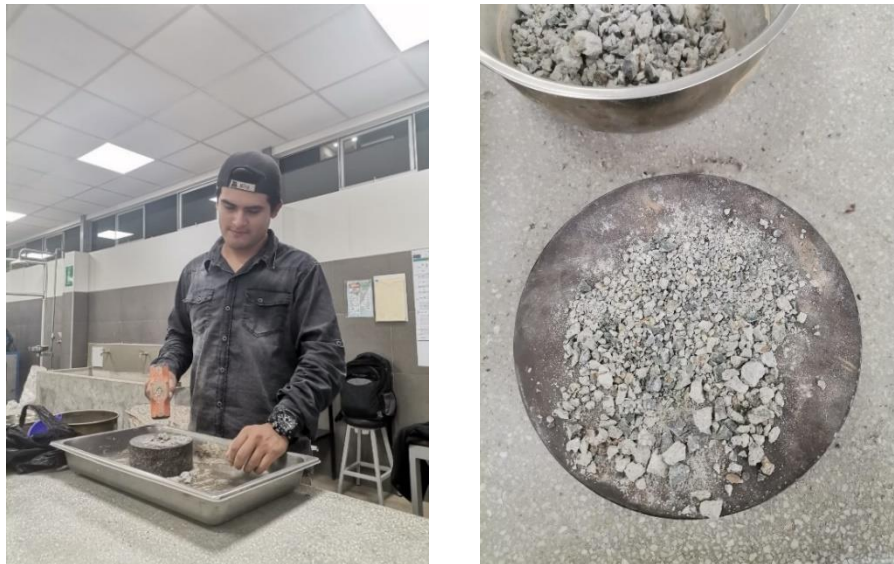
Ilustración 25_Trituración manual de RCD-C
