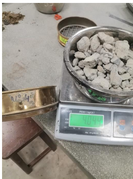
Ilustración 28_Peso de muestra pasado por tamiz N°4
