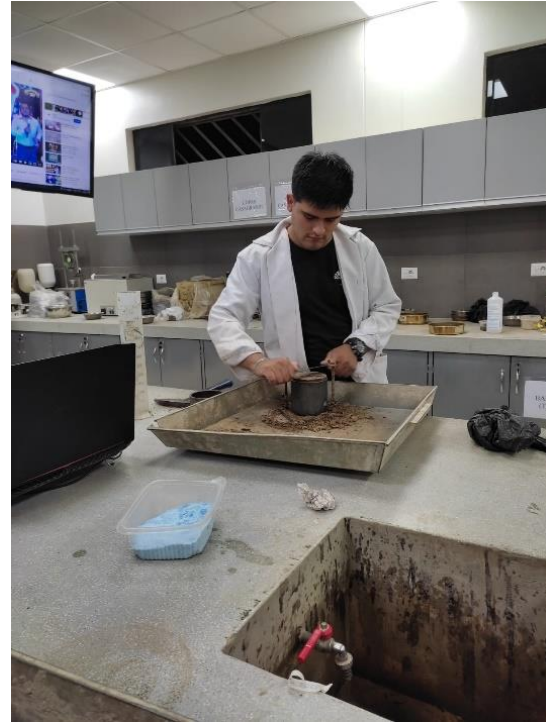
Ilustración 18_ Enrasado de la muestra
