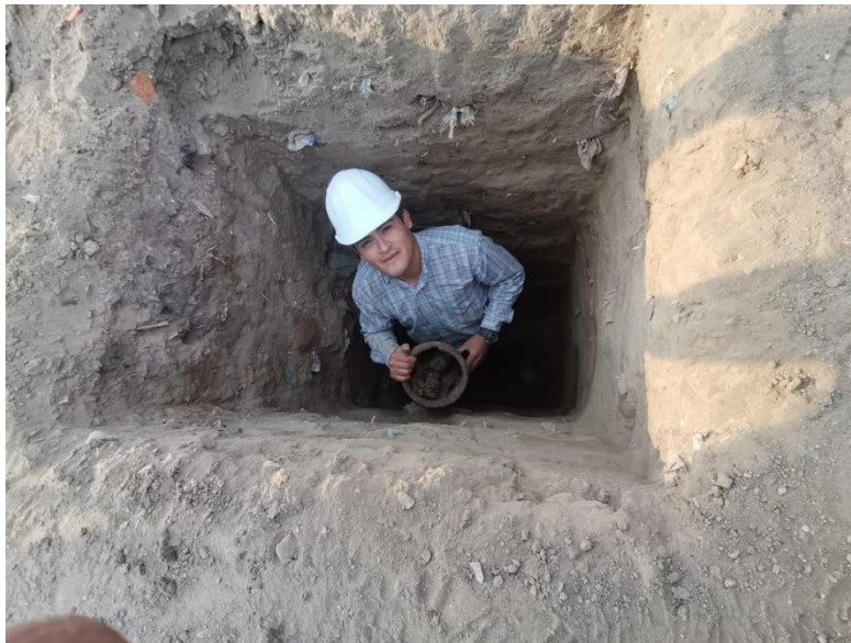
Ilustración 8 _Extracción de la muestra de suelo, C-03
