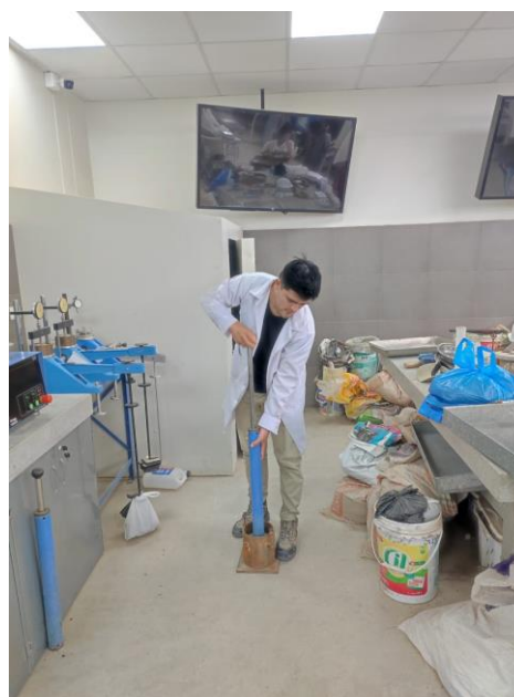
Ilustración 20_Compactación de la muestra
