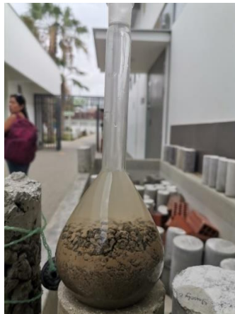
Ilustración 27_Realización de Ensayo Gravedad Específica
