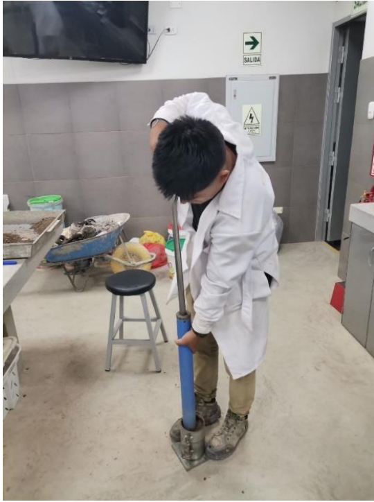
Ilustración 19_ Compactación de la muestra
