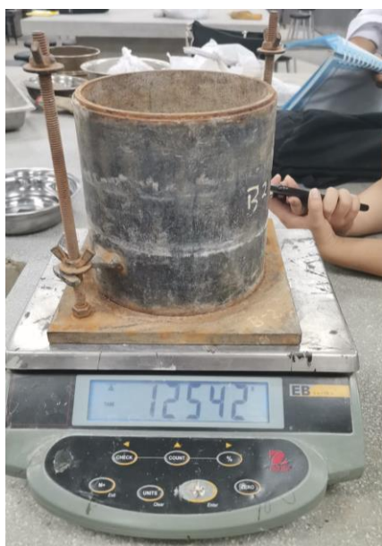
Ilustración 21_Peso de la muestra compactada
