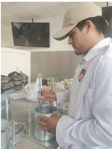
Ilustración 37_Medición de molde de CBR
