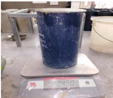
Figura 30: Peso fresco del concreto con 40% de PVC
