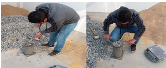
Figura 21: Peso volumétrico suelto del agregado grueso
