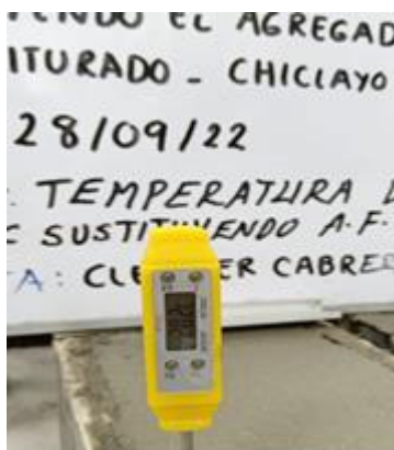
Figura 28: Temperatura del concreto con 20% de PVC triturado
