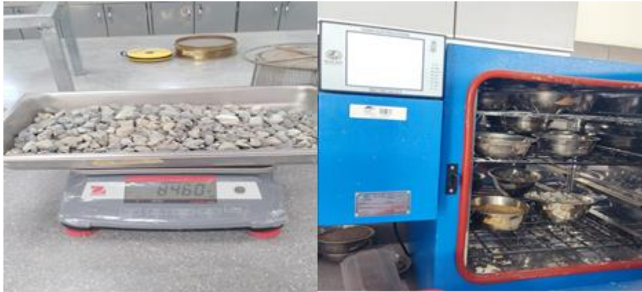
Figura 15: Contenido de Humedad del agregado grueso
