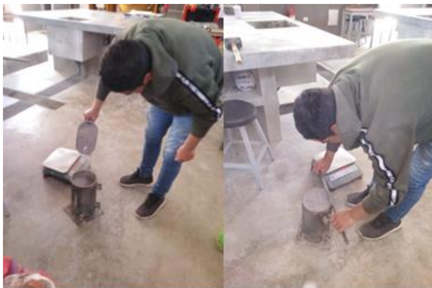
Figura 26: Peso volumétrico suelto del PVC triturado
