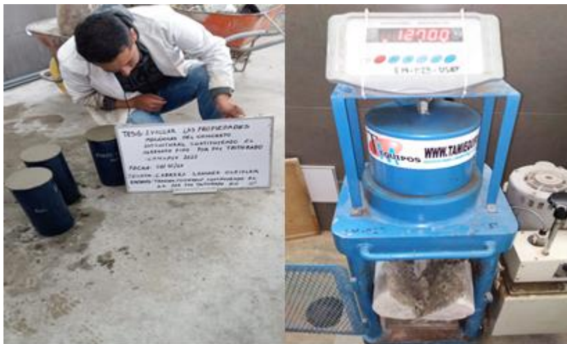
Figura 33: Probetas ensayadas a resistencia a la tracción.
