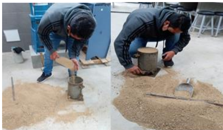
Figura 23: Peso volumétrico suelto del agregado fino
