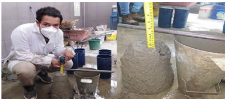
Figura 27: Asentamiento del concreto patrón
