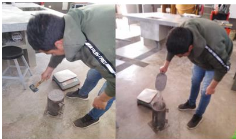
Figura 25: Peso volumétrico compactado del PVC triturado
