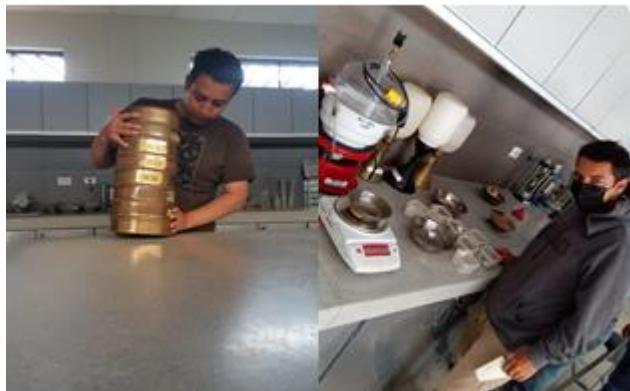
Figura 14: Análisis granulométrico del PVC triturado.
