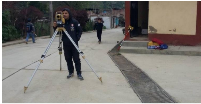
FOTOGRAFÍA N° 6: Levantamiento Topográfico en terreno para líneas de conducción
