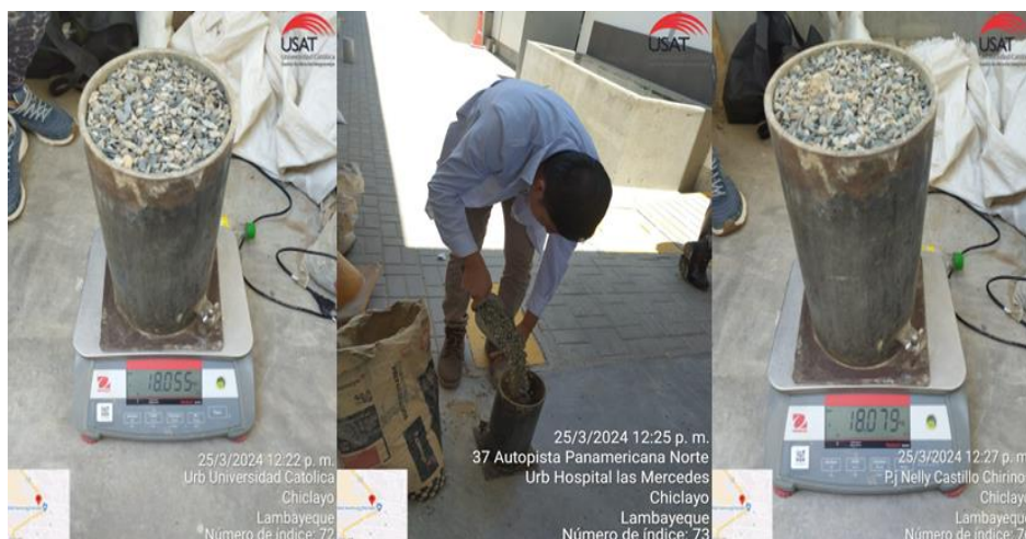
Ilustración 21: Peso unitario suelto del confitillo
