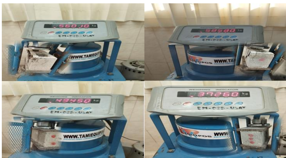
Ilustración 42: Ensayo de capacidad de carga a compresión f'_b – 28 días
