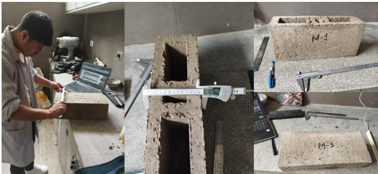
Ilustración 32: Prueba de variación dimensional diseño patrón
