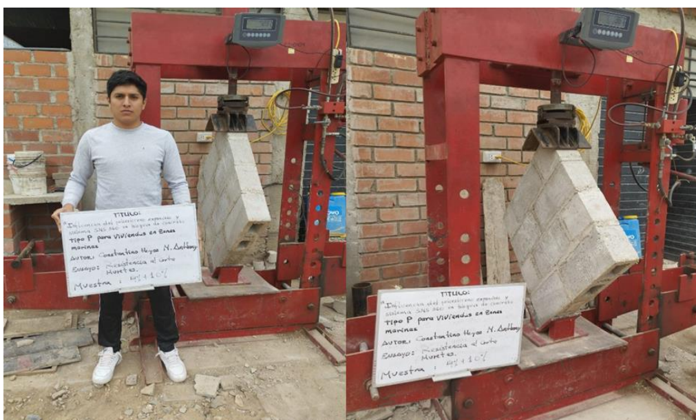
Ilustración 47: Ensayo de capacidad de carga a compresión de muretes diseño 10% EPS + 4% SNS 360 – Identificación de ruptura por deslizamiento
