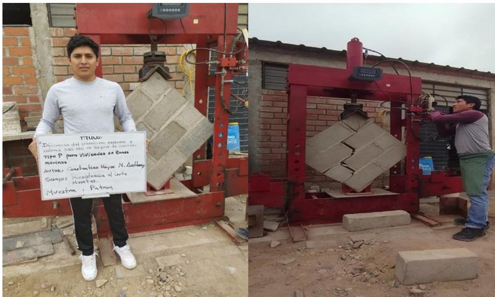
Ilustración 46: Ensayo de capacidad de carga a compresión de muretes DP – Identificación de ruptura por tensión diagonal de juntas
