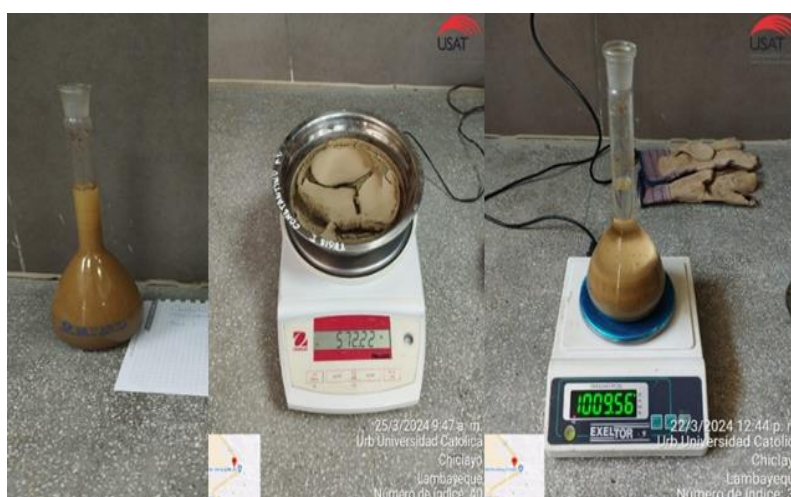
Ilustración 19: Absorción de arena gruesa Fuente: Perteneciente del ejecutor
