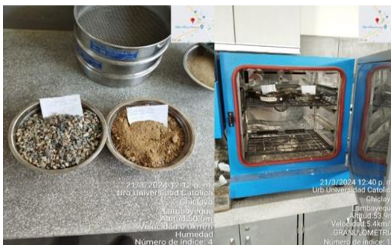
Ilustración 17: Colocación de muestras al horno
