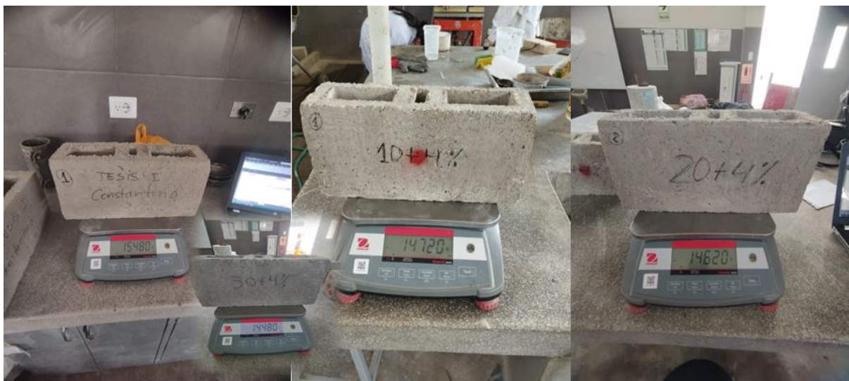
Ilustración 39: Pesaje de bloques superficialmente secas
