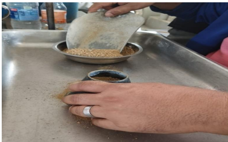
Ilustración 18: Prueba con el cono de absorción Fuente: Perteneciente del ejecutor
