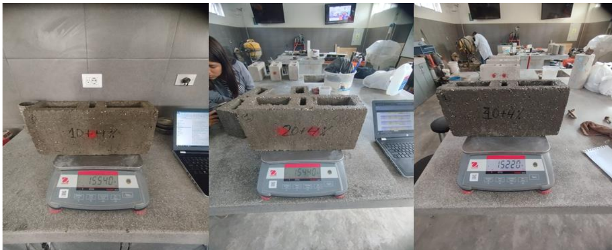
Ilustración 37: Pesaje de bloques luego de permanecer saturados Fuente: Pertenciente del ejecutor
