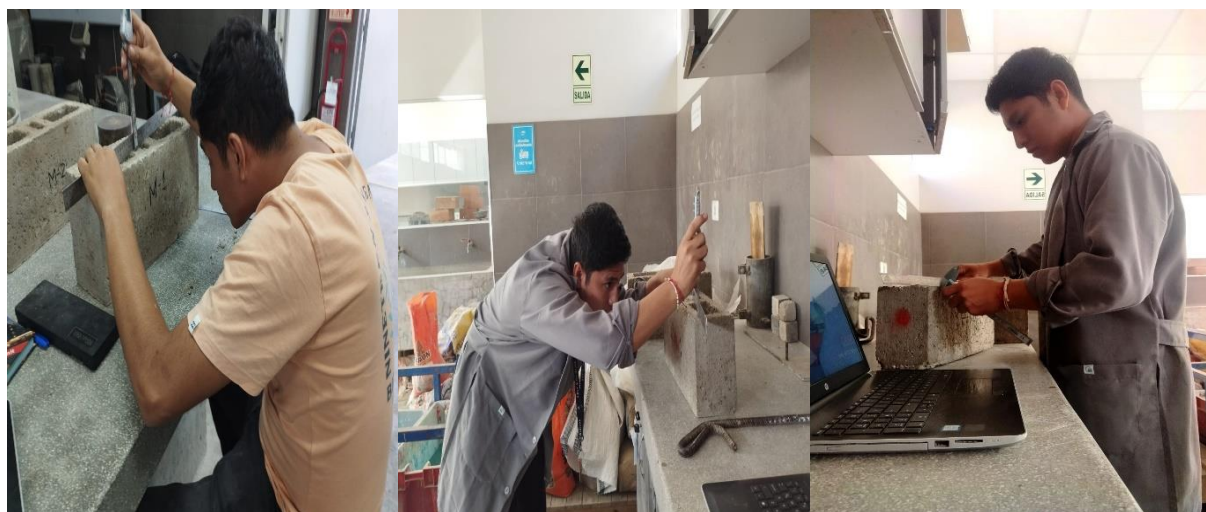
Ilustración 34: Prueba de alabeo en bloques con diseño patrón y modificados
