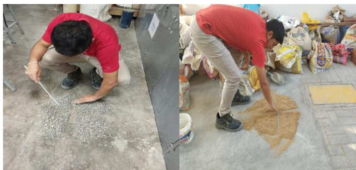
Ilustración 14: Selección de material proceso de cuarteo de agregados
