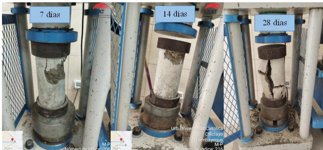
Ilustración 25: Prueba de capacidad de carga a compresión en probetas
