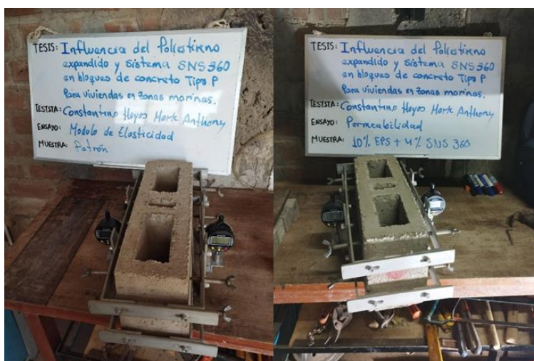
Ilustración 51: Preparación de unidades para prueba
