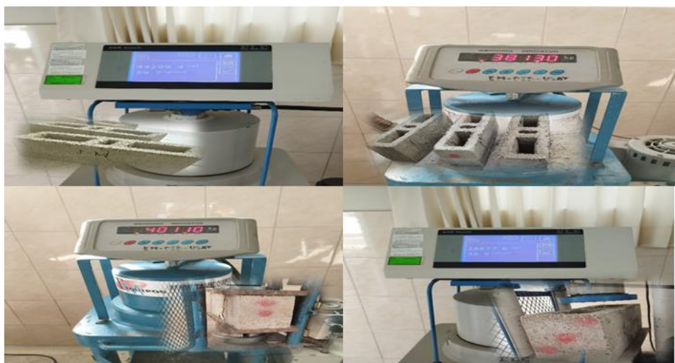
Ilustración 40: Prueba de capacidad de carga a compresión f'_c - 7 días
