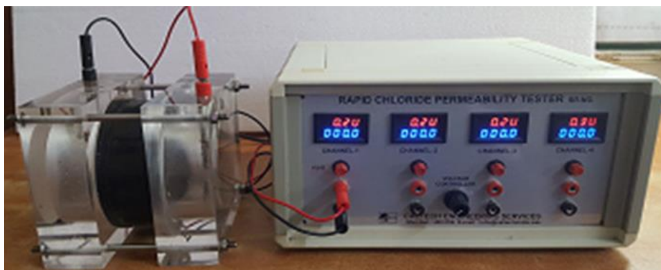
Ilustración 4: Prueba de Ión cloruro
