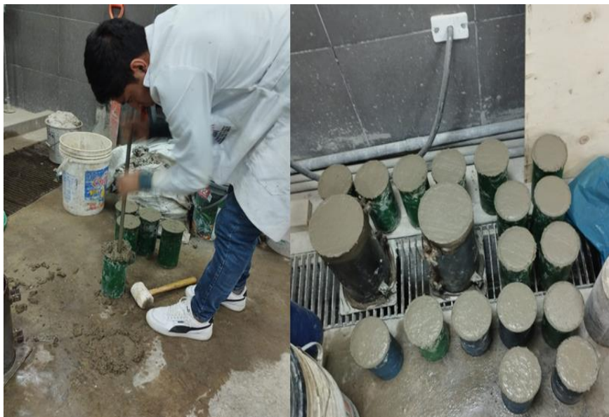
Ilustración 24: Realización de probetas
