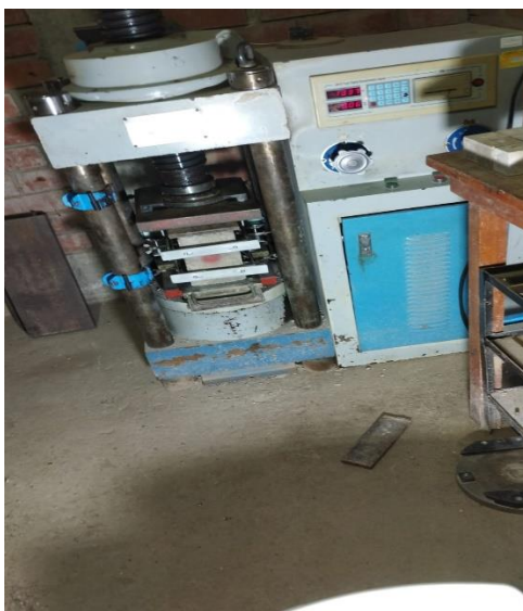
Ilustración 50: Muestra sometida a carga en prensa de compresión
