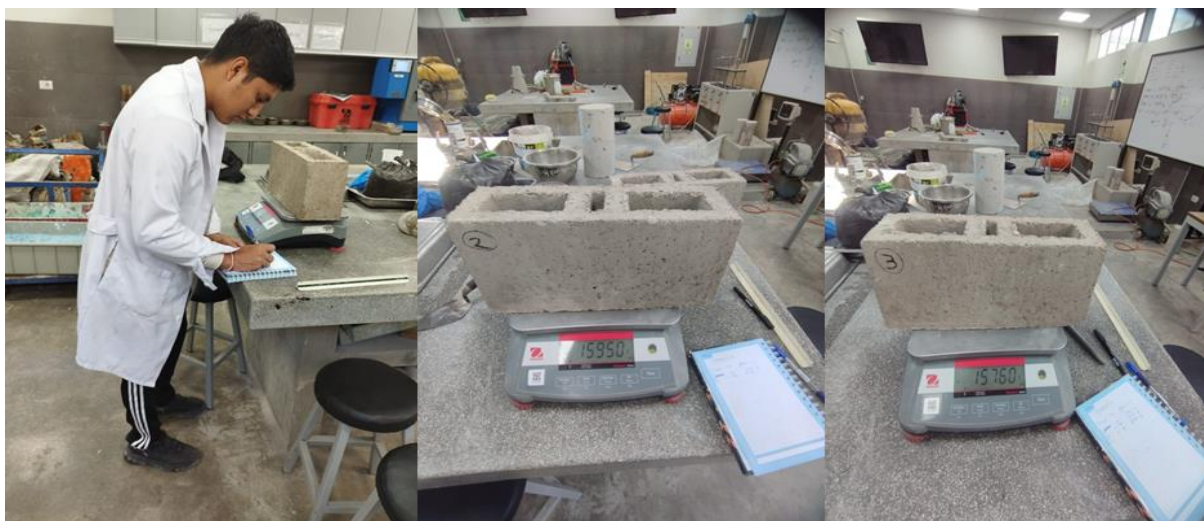
Ilustración 36: Prueba de absorción, pesado de muestras en estado natural.
