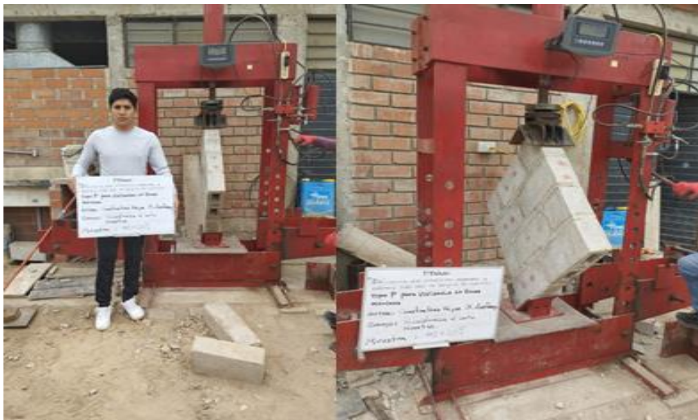
Ilustración 48: Ensayo de capacidad de carga a compresión de muretes diseño 20% EPS + 4% SNS 360 – Identificación de ruptura por tensión diagonal de juntas
