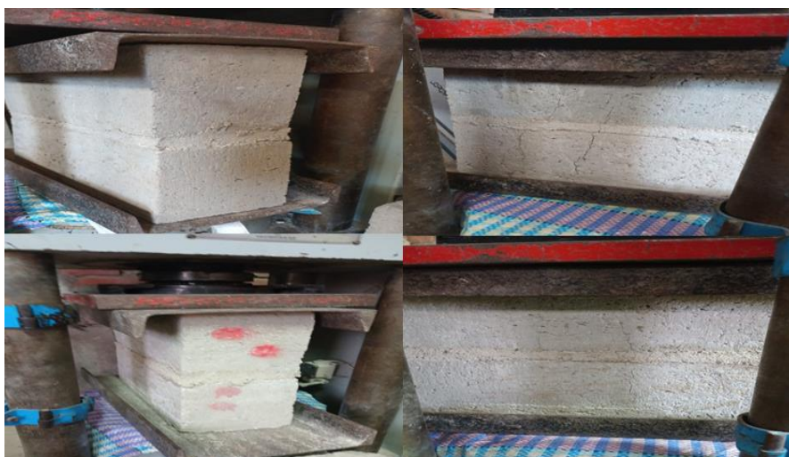
Ilustración 44: Prueba de capacidad de carga a compresión de prismas
