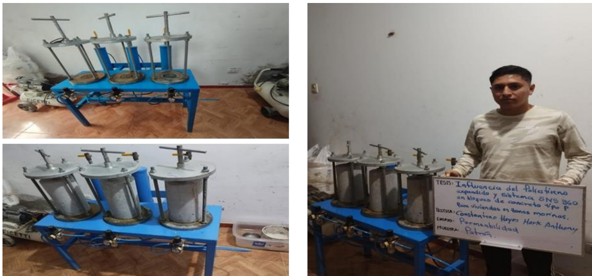
Ilustración 27: Prueba de permeabilidad en probetas diseño patrón
