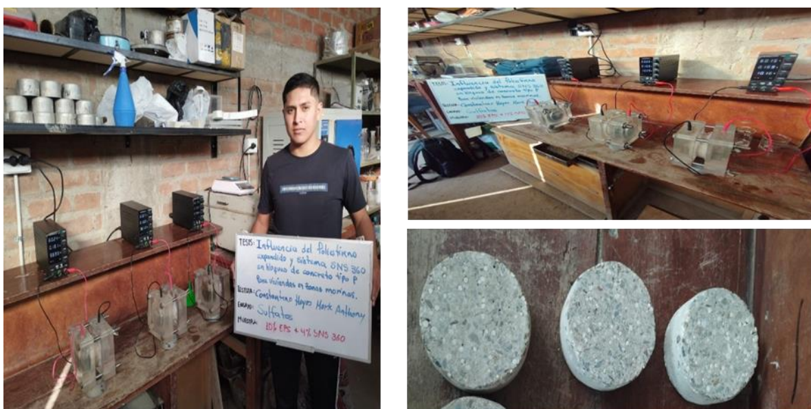
Ilustración 29: Prueba a resistencia de Ión cloruro de 10% EPS +4% SNS 360
