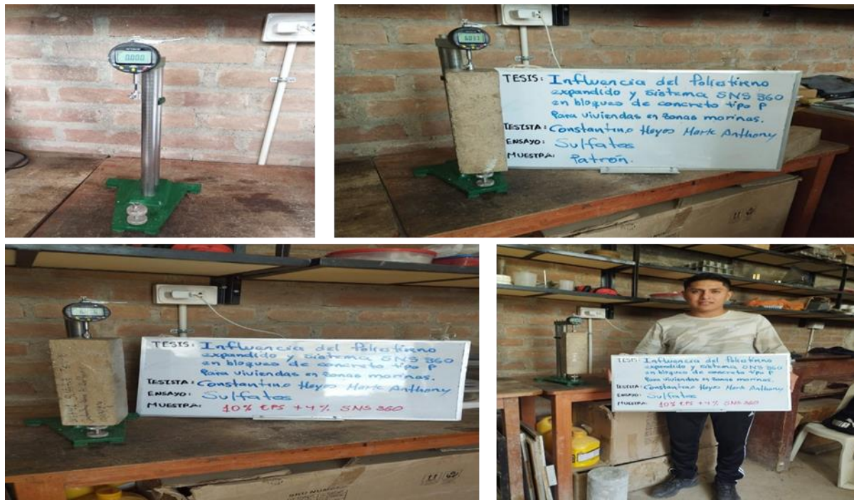
Ilustración 31: Prueba de resistencia a sulfatos
