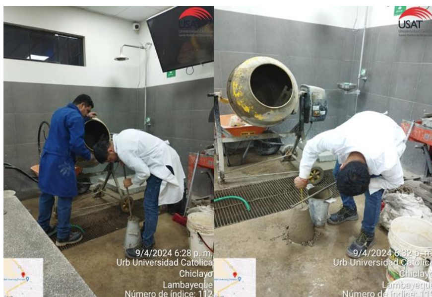
Ilustración 23: Prueba de slump Fuente: Pertenciente del ejecutor
