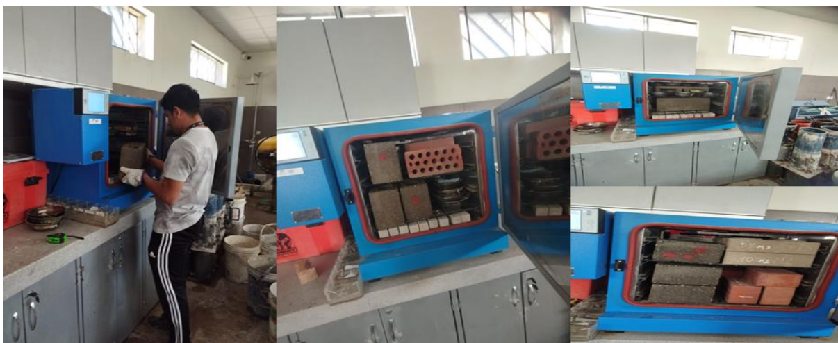
Ilustración 38: Puesta de bloques al horno Fuente: Pertenciente del ejecutor
