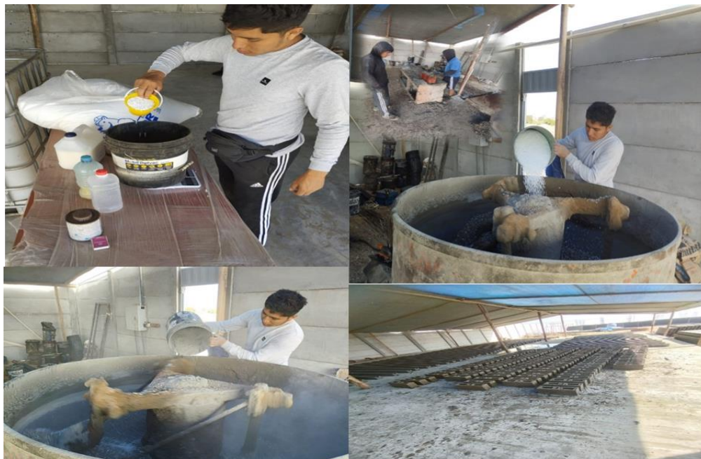
Ilustración 26: Producción de bloques patrón y bloques con adición
