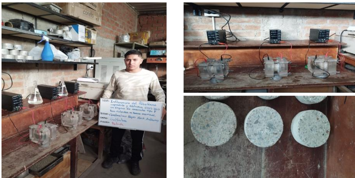
Ilustración 28: Prueba a resistencia de Ión cloruro diseño patrón
