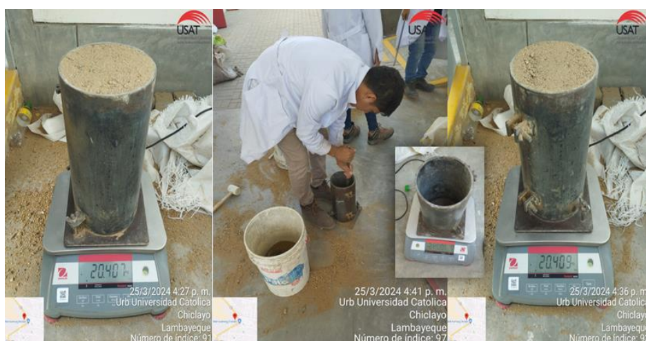
Ilustración 22: Peso unitario compactado de la arena
