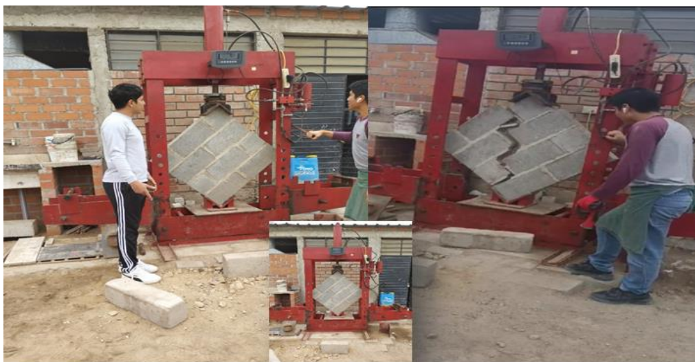
Ilustración 49: Ensayo de capacidad de carga a compresión de muretes diseño 30% EPS + 4% SNS 360 – Identificación de ruptura por tensión diagonal de juntas
