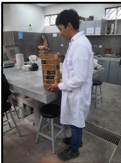
Fig. 24: Ensayo de granulometría
