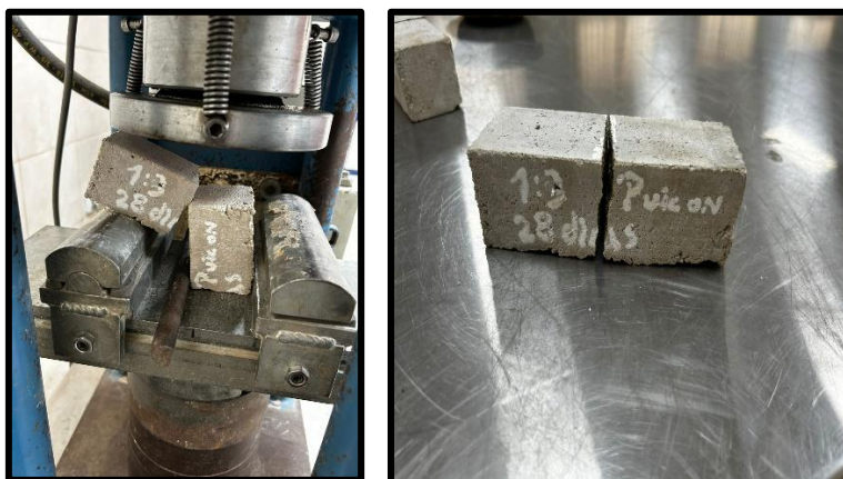
Fig. 31: Ensayo de resistencia a la flexión del mortero de cemento hidráulico
