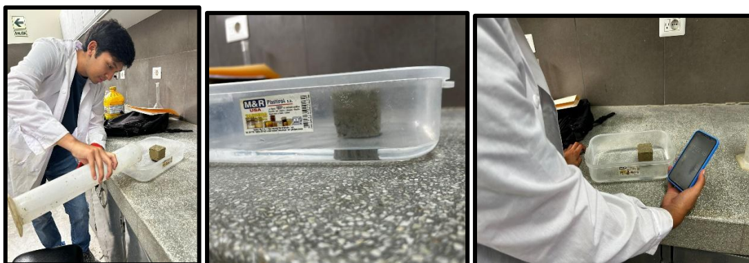
Fig. 32: Ensayo de absorción de agua de morteros de albañilería
