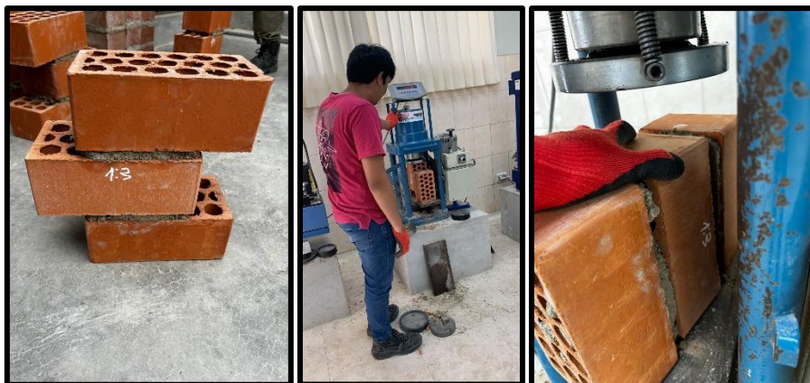
Fig. 33: Ensayo de adherencia por cizalle
