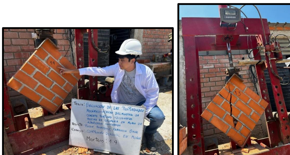
Fig. 30: Ensayo de compresión de muretes de albañilería
