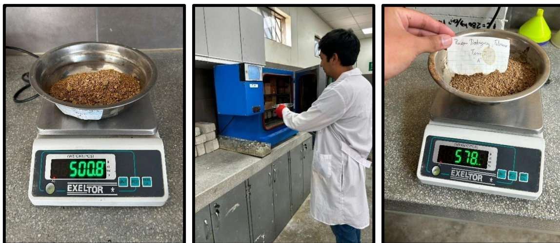
Fig. 26: Ensayo de humedad
