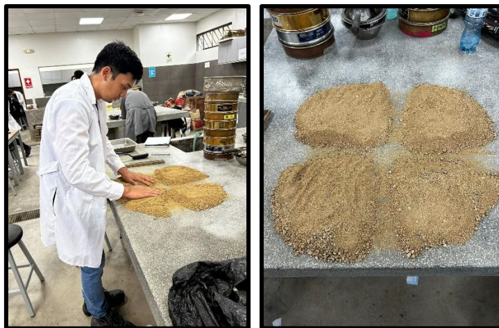
Fig. 23: Cuarteo del agregado fino
