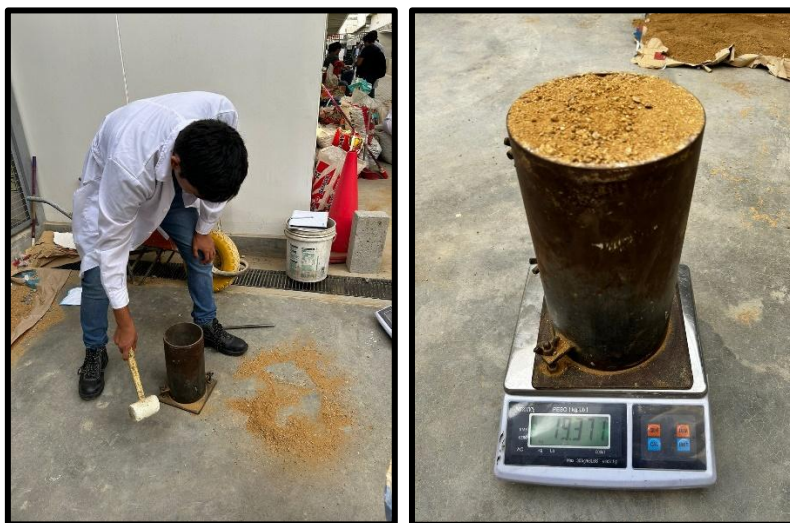
Fig. 28: Peso unitario compactado del agregado fino
