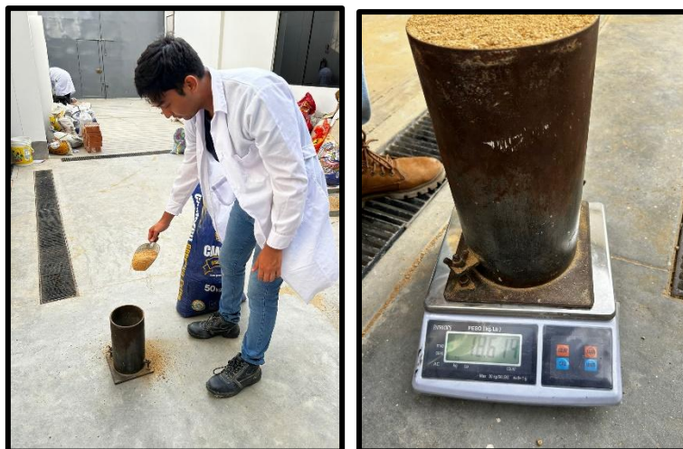
Fig. 27: Peso unitario suelto del agregado fino
