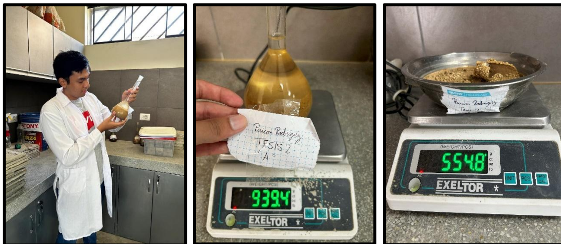
Fig. 25: peso de la fiola más la muestra y la muestra seca
