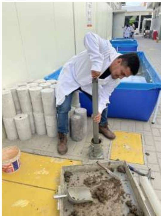
Ilustración 22: Continuación del ensayo de Proctor en Laboratorio USAT.
