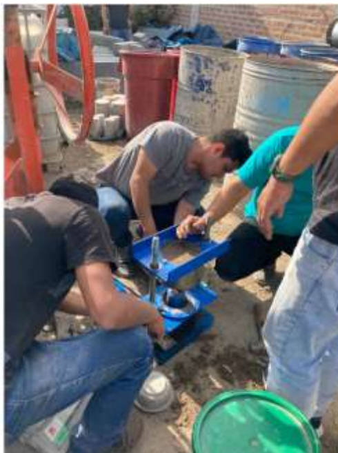
Ilustración 18: Armado del molde para ensayos de Proctor
