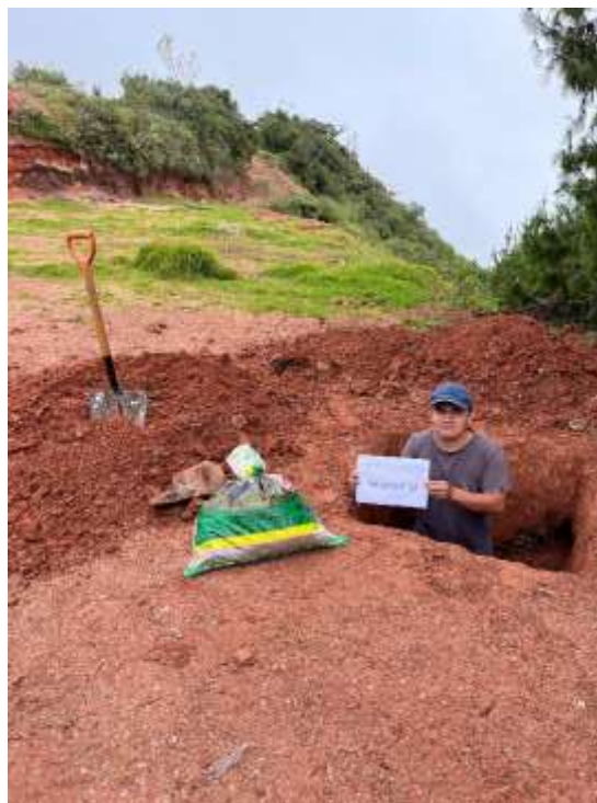
Ilustración 10: Calicatas excavadas a 1.50 m y listas para ser transportadas.
