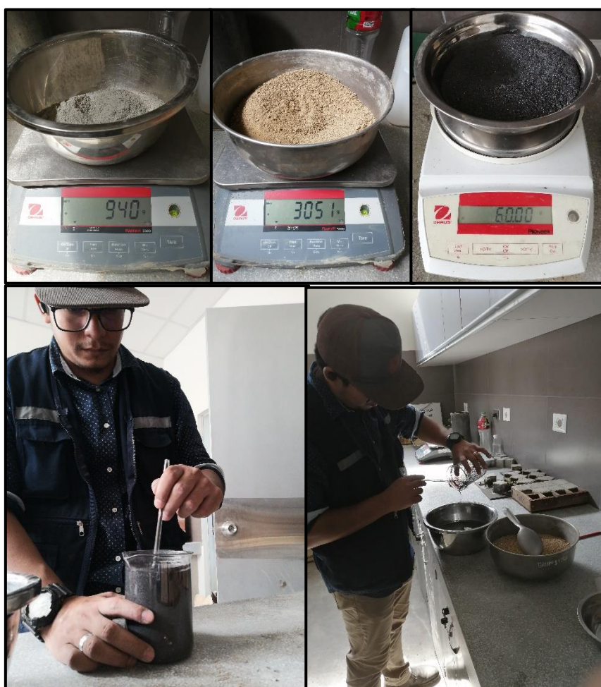
Imagen 32. Proceso de la mezcla y elaboración del mortero con sustitución de nanotubo de grafeno al 6% del cemento.
