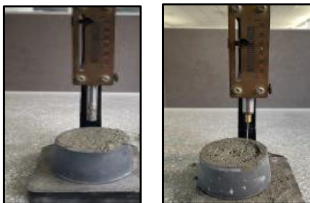
Imagen 37. Procedimiento realizado durante el tiempo de inicial y final de fraguado de la mezcla del mortero
