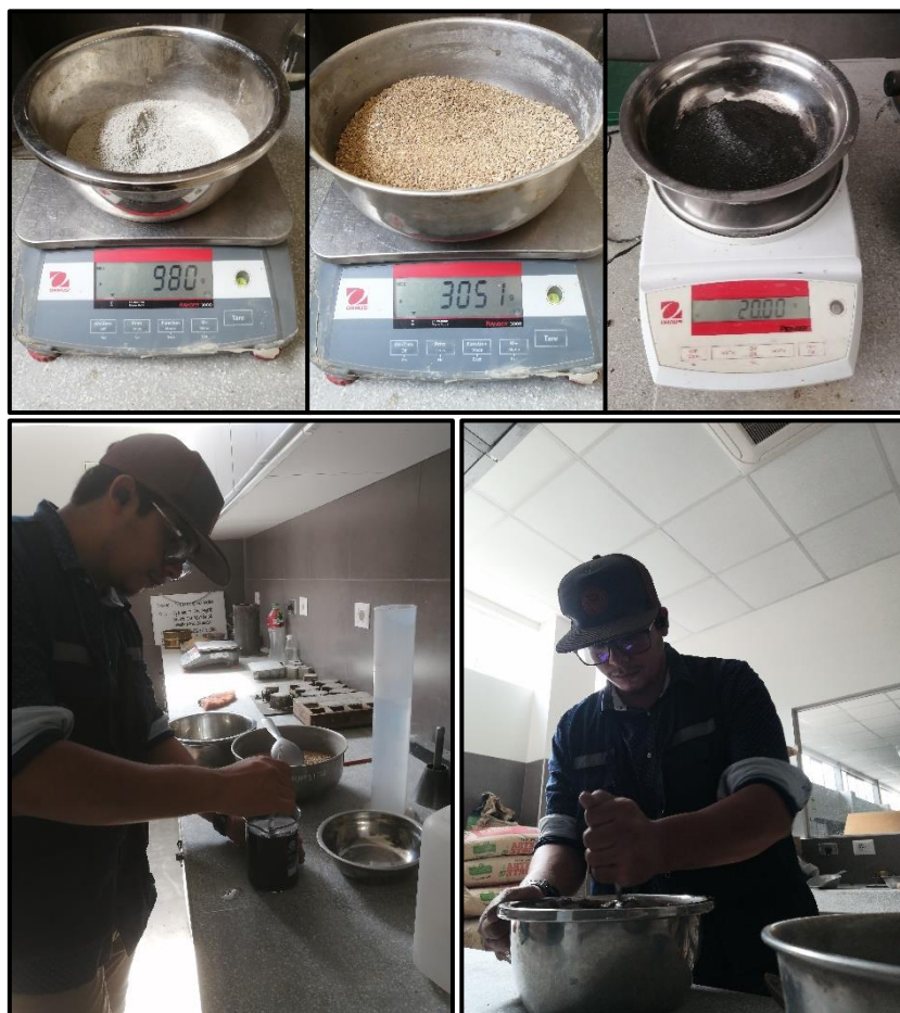
Imagen 30. Proceso de la mezcla y elaboración del mortero con sustitución de nanotubo de grafeno al 2% del cemento.
