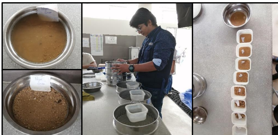
Imagen 13. Procedimiento para determinar la granulometría de la arena
