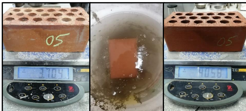
Imagen 19. Proceso para determinar el peso saturado del ladrillo.
