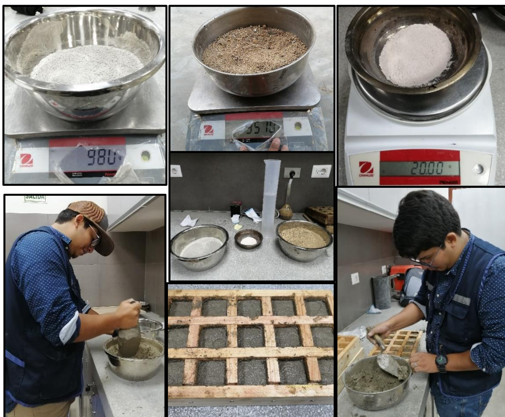
Imagen 27. Proceso de la mezcla y elaboración del mortero con sustitución de conchas de abanico pulverizadas al 2% del cemento.
