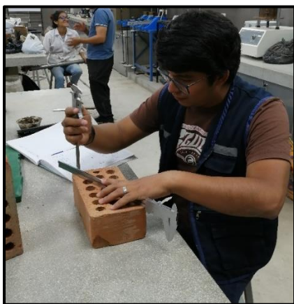
Imagen 17. Proceso de medición al ladrillo para determinar su alabeo (concavidad y convexidad).
