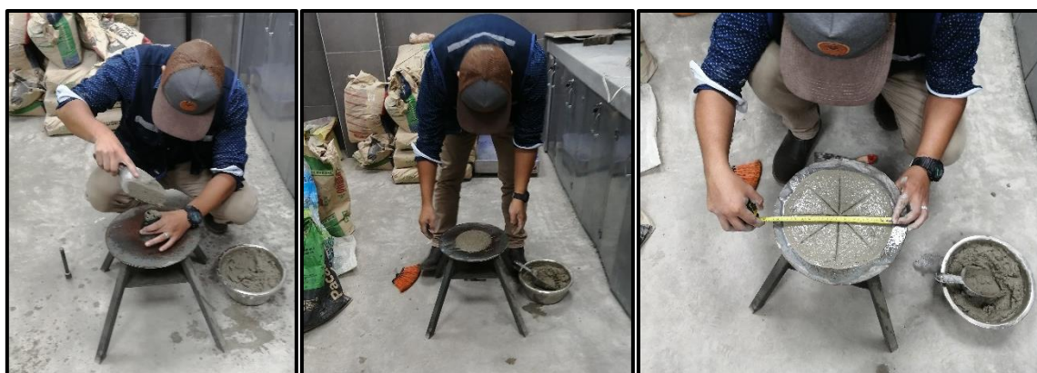
Imagen 34. Procedimiento para determinar la fluidez del mortero con sustitución de conchas de abanico pulverizadas al 2%, 4% y 6% del cemento.
