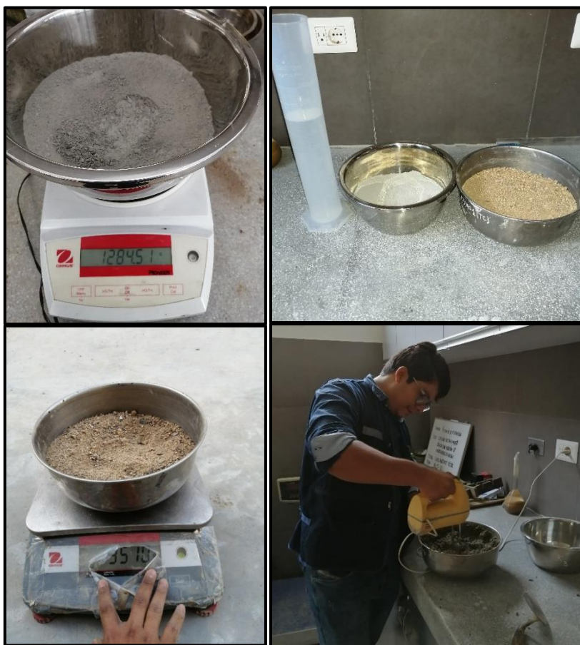
Imagen 26. Procedimiento de pesos y elaboración de la mezcla y mortero convencional.
