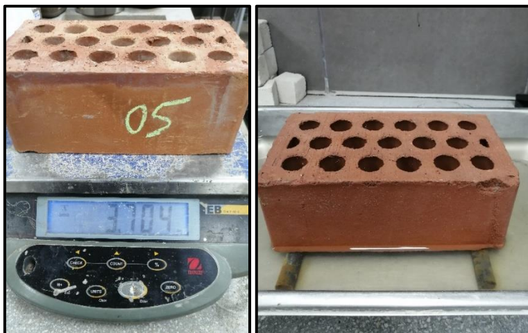
Imagen 22. Procedimiento para el ensayo de succión a la unidad de albañilería.
