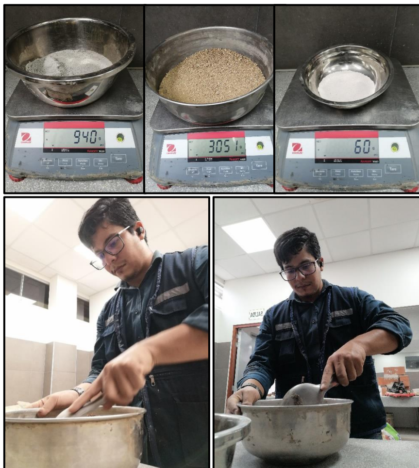
Imagen 29. Proceso de la mezcla y elaboración del mortero con sustitución de conchas de abanico pulverizadas al 6% del cemento.
