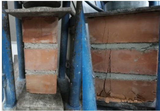
Imagen 40. Muestra de la falla que sufrió la pila de albañilería durante el proceso de resistencia a la compresión axial.
