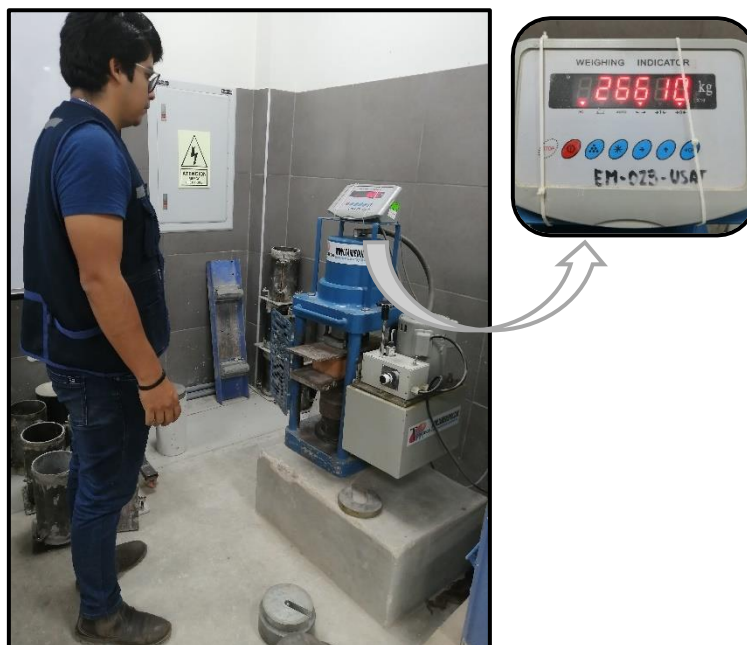
Imagen 24. Proceso para determinar la resistencia a la compresión de la unidad de albañilería.
