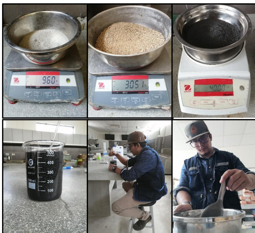
Imagen 31. Proceso de la mezcla y elaboración del mortero con sustitución de nanotubo de grafeno al 4% del cemento.
