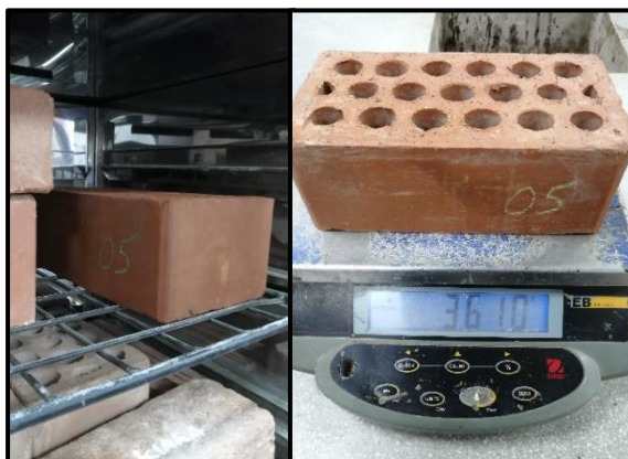
Imagen 20. Procedimiento para determinar el porcentaje de absorción de la unidad de albañilería.
