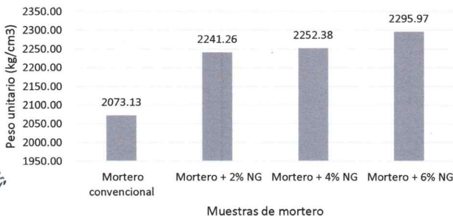
Peso unitario del mortero convencional y con adición de Nanotubo de grafeno
