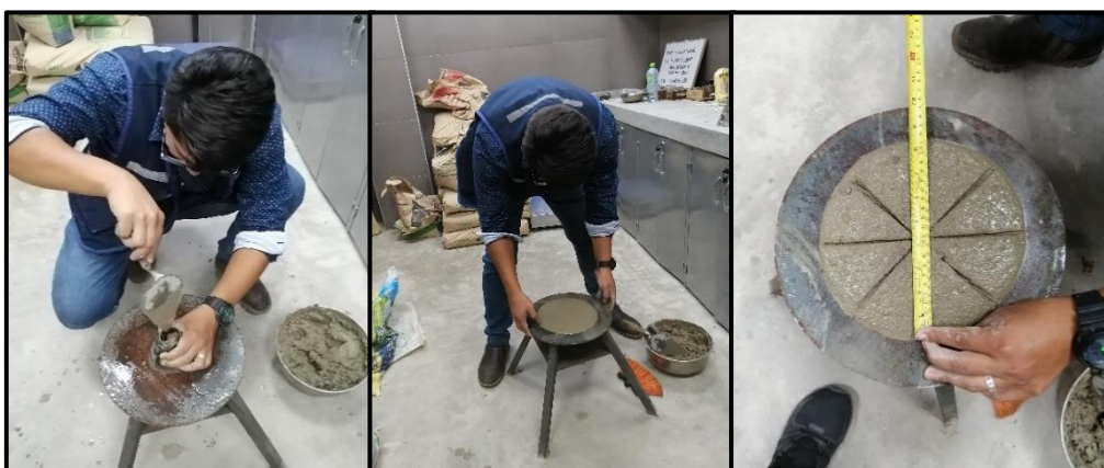
Imagen 33. Procedimiento para determinar la fluidez del mortero convencional.
