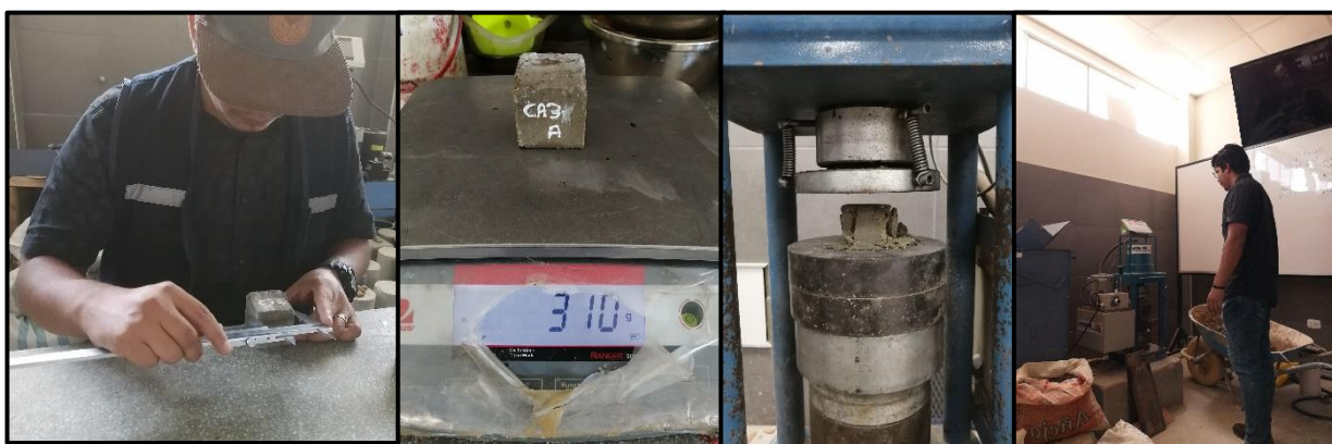
Imagen 38. Procedimiento del ensayo de resistencia a la compresión en muestras cúbicas.
