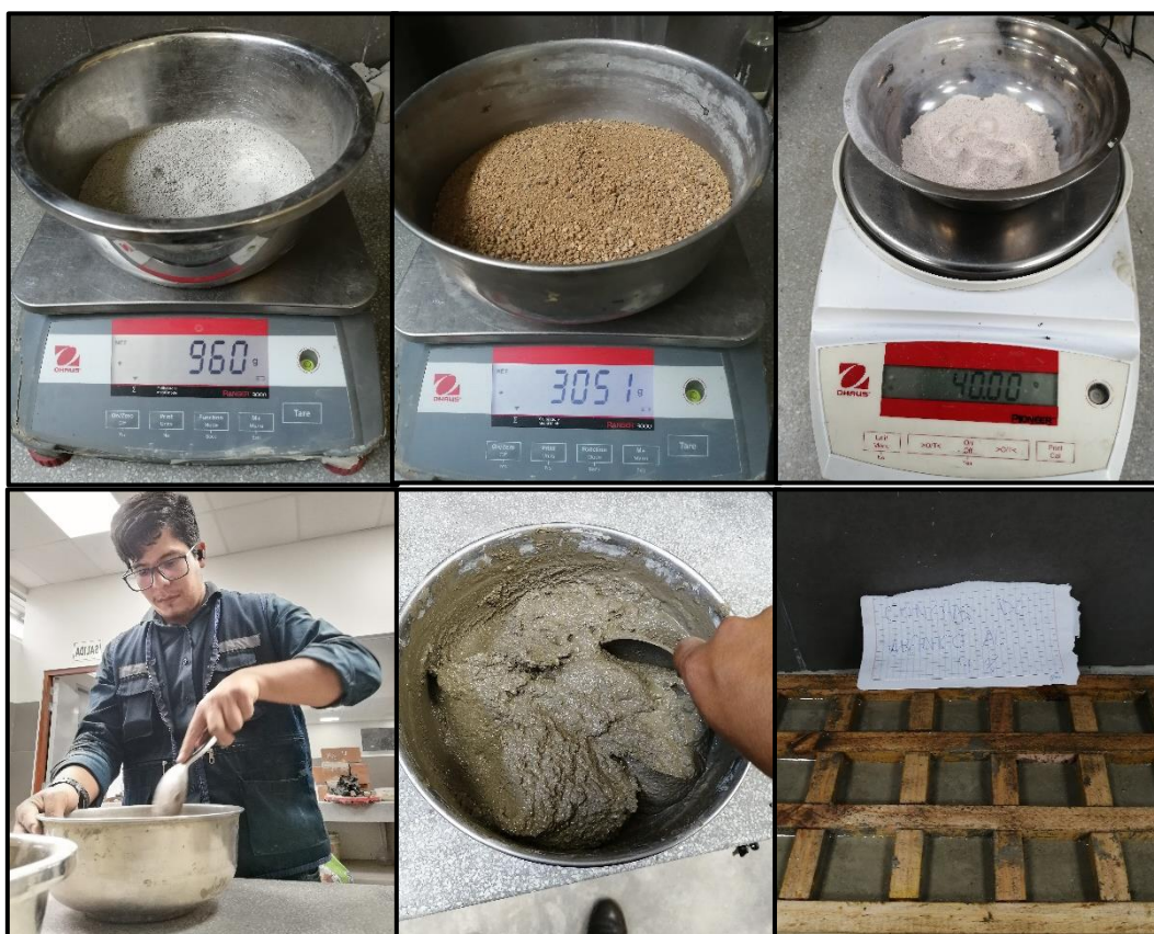
Imagen 28. Proceso de la mezcla y elaboración del mortero con sustitución de conchas de abanico pulverizadas al 4% del cemento.
