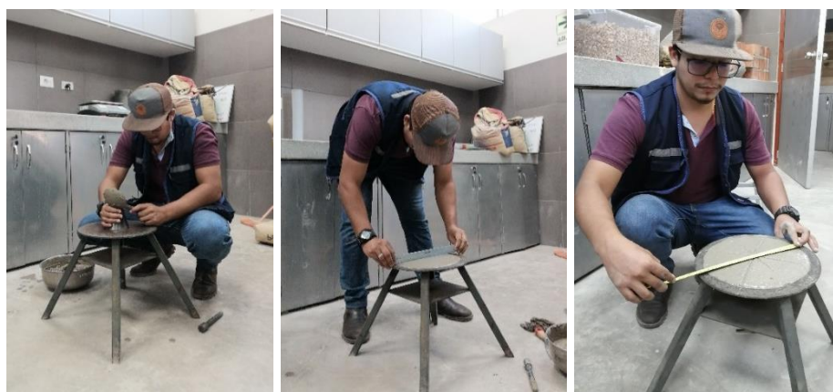
Imagen 35. Procedimiento para determinar la fluidez del mortero con sustitución de nanotubo de grafeno al 2%, 4% y 6% del cemento.
