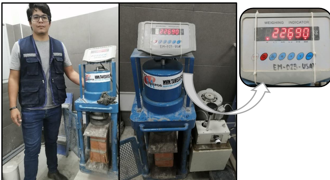
Imagen 39. Proceso para determinar la resistencia a la compresión axial de pila de albañilería.
