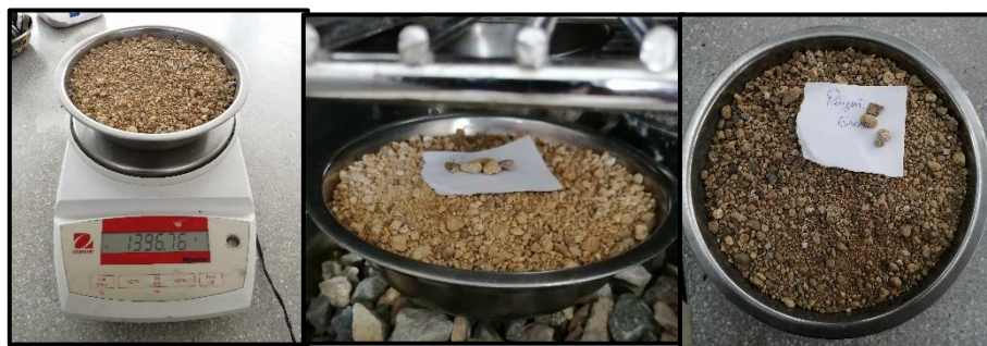
Imagen 12. Procedimiento para determinar la humedad del agregado
