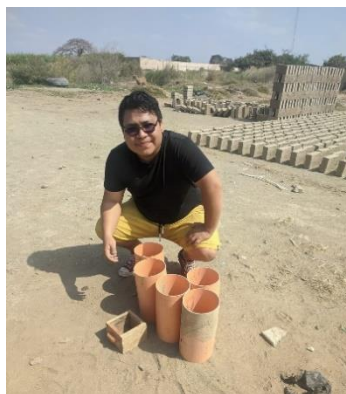
Ilustración 45: Moldes para las unidades de tierra.
