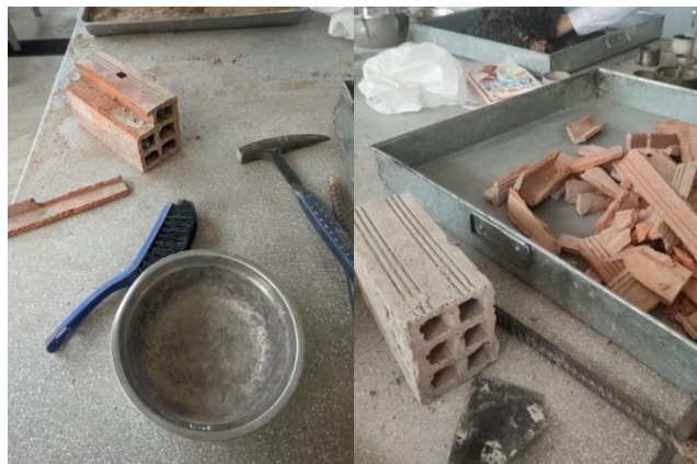
Ilustración 8: (a) Herramientas para limpieza del ladrillo, (b) trituración manual.
