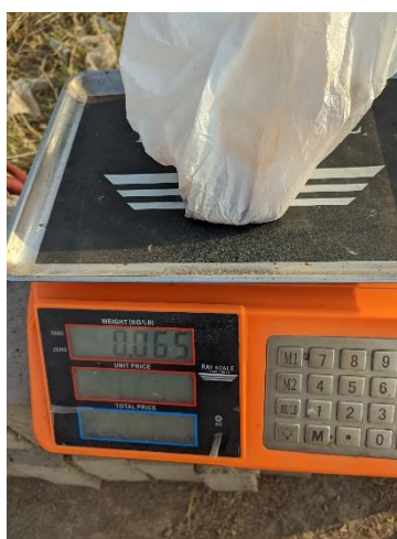
Ilustración 50: Dosificación al 5% de la muestra de 10x10x10.
