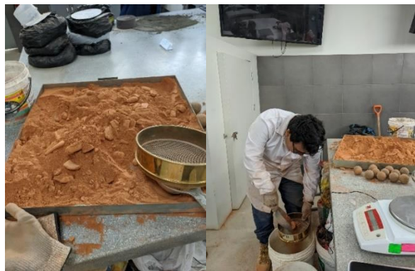
Ilustración 10: (a), (b), (c) y (d) Proceso del tamizado del ladrillo triturado.
