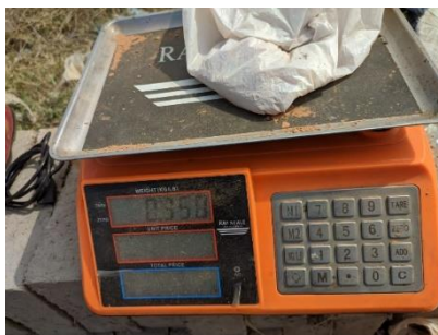
Ilustración 52: Dosificación al 5% de la muestra cilíndrica de 4x12”.
