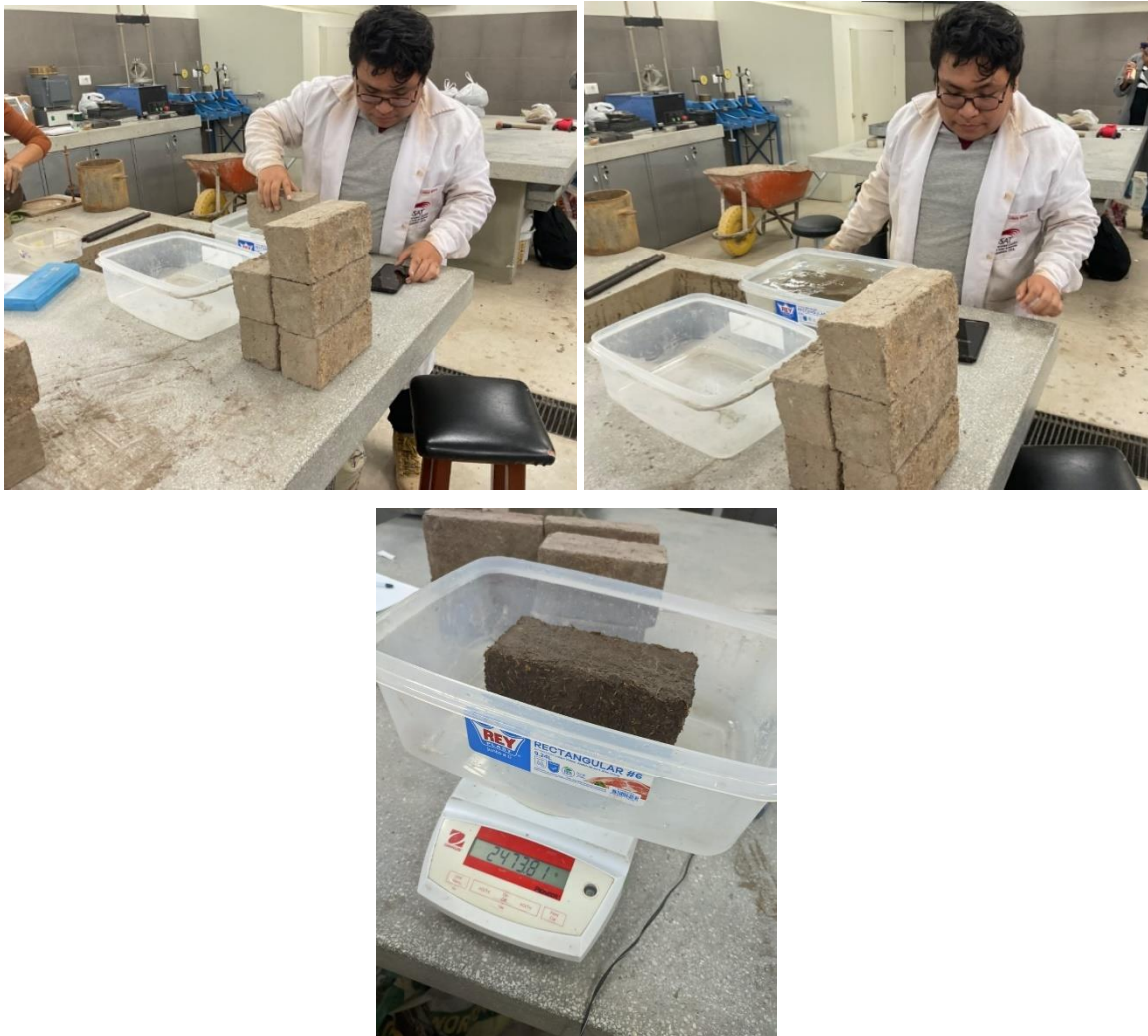
Foto 11: Ensayo de Absorción de las U.T.R
