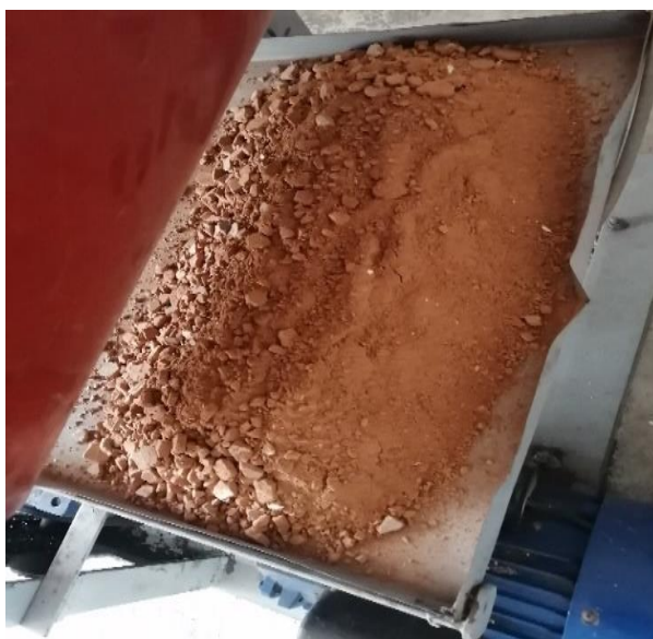
Figura 3. Baldosa cerámica triturada en la Máquina de los Ángeles
