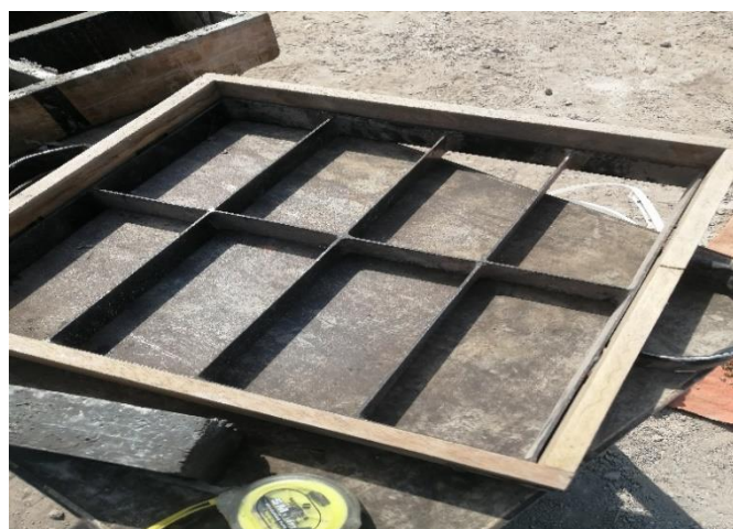
Figura 7. Molde metálico de adoquines de concreto tipo I.
