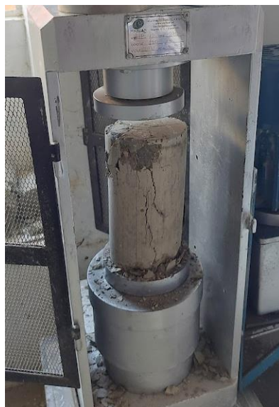
Figura 128: Falla del concreto a los 56 días para el GEB al 2% (3)
