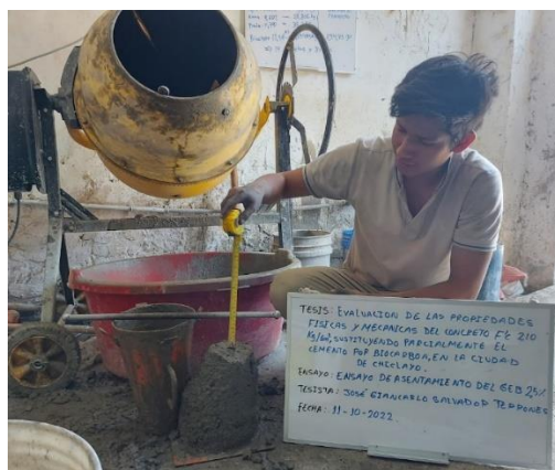
Figura 81: Asentamiento del GEB del 2.5%
