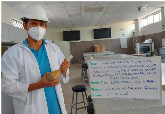
Figura 31: Ensayo de peso específico del agregado fino
