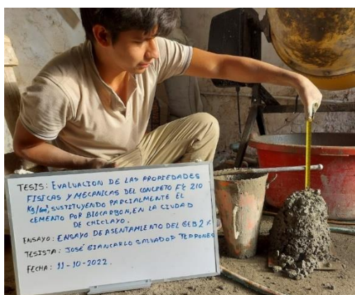
Figura 80: Asentamiento del GEB del 2%
