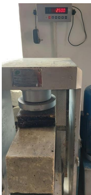
Figura 189: Capacidad de carga a flexión a los 28 días para el GEB al 2.5% (2)
