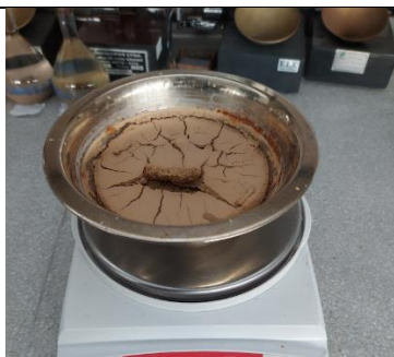
Figura 32: Agregado fino retirado del horno
