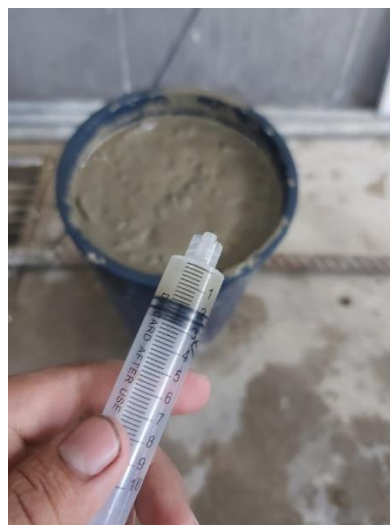
Figura 87: Tomando medidas del agua exudada de la mezcla
