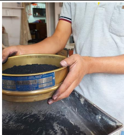
Figura 16: Biocarbón tamizado por la malla N° 50
