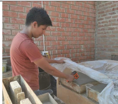
Figura 63: Tesista tomando lectura de la temperatura del concreto en estado fresco
