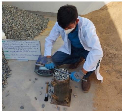
Figura 27: Ensayo de peso unitario suelto del agregado grueso
