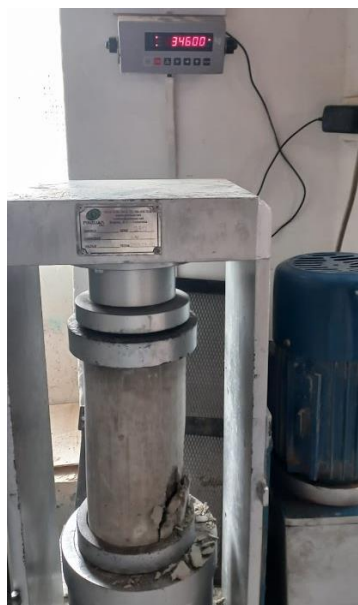
Figura 121: Capacidad de carga a los 14 días para el GEB al 2% (2)
