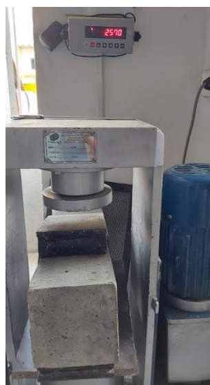
Figura 185: Capacidad de carga a flexión a los 7 días para el GEB al 2.5% (1)
