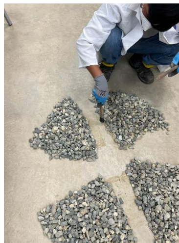
Figura 21: Cuarteo del agregado grueso
