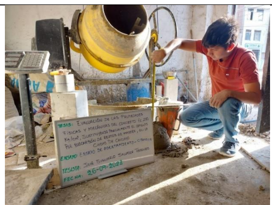
Figura 41: Ensayo de asentamiento
