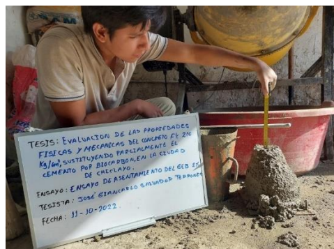
Figura 79: Asentamiento del GEB del 1%
