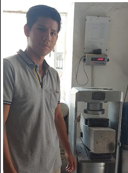
Figura 184: Falla de viga a los 56 días para el GEB al 2%
