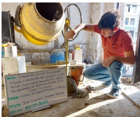
Figura 78: Asentamiento del concreto patrón
