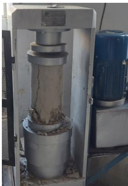
Figura 125: Falla del concreto a los 28 días para el GEB al 2% (3)
