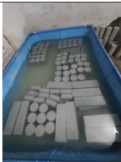
Figura 54: Curado de probetas y vigas de concreto
