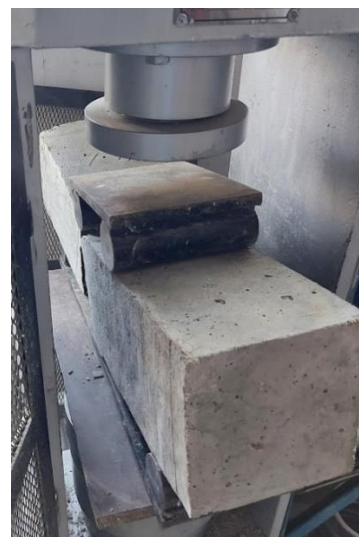
Figura 187: Falla de viga a los 7 días para el GEB al 2.5%
