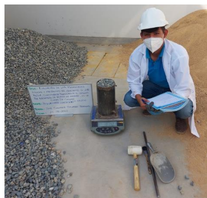
Figura 29: Ensayo del peso unitario compactado del agregado grueso
