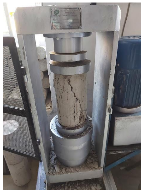
Figura 110: Falla del concreto a los 14 días para el GEB al 1% (3)
