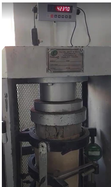
Figura 113: Capacidad de carga a los 28 días para el GEB al 1% (3)
