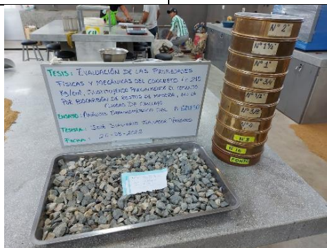
Figura 22: Tamices para el ensayo de agregado grueso
