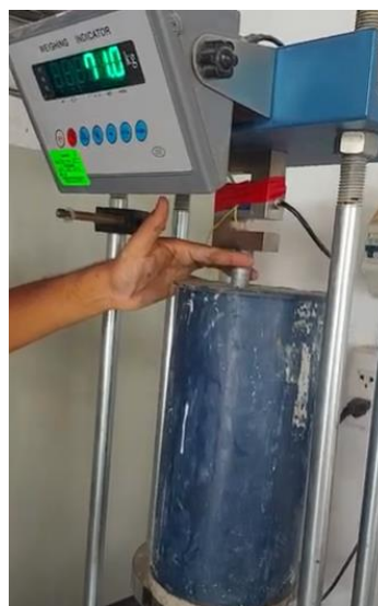
Figura 92: Acomodando la aguja que penetre de manera vertical la mezcla
