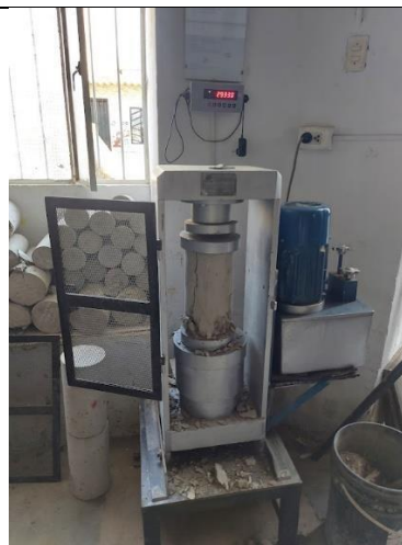
Figura 56: Ensayo de resistencia a compresión
