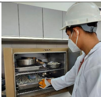
Figura 24: Tesista sacando los agregados del horno
