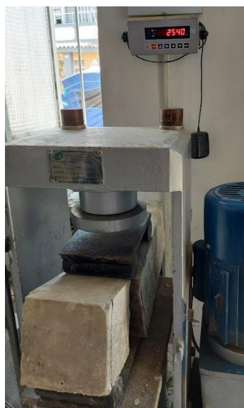
Figura 162: Capacidad de carga a flexión a los 7 días para el concreto patrón (2)
