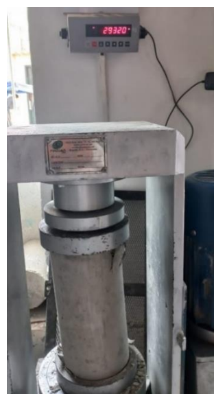
Figura 148: Capacidad de carga a los 14 días para el GEB al 1% (2)
