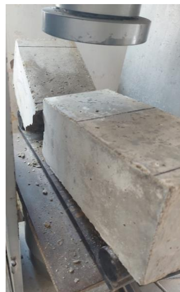
Figura 175: Falla de viga a los 56 días para el GEB al 1%
