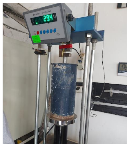
Figura 90: Penetración de la aguja al concreto
