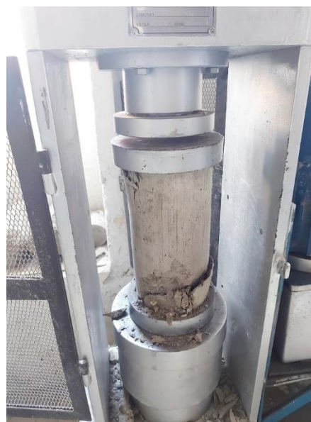
Figura 134: Falla del concreto a los 14 días para el GEB al 2.5% (3)
