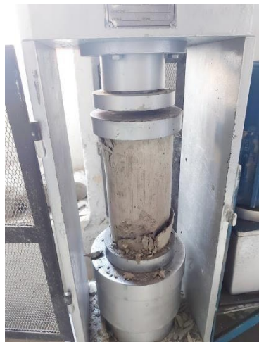
Figura 55: Rotura de probetas cilíndricas
