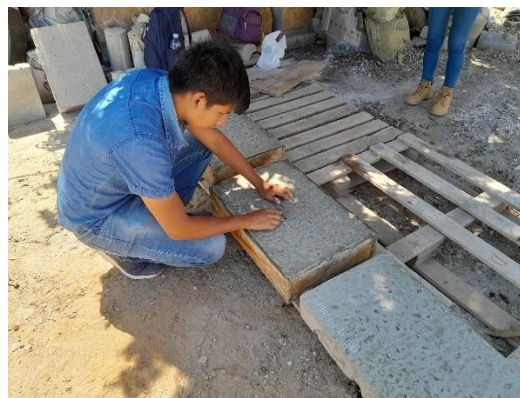
Figura 65: Tesista realizando las medidas de las fisuras.
