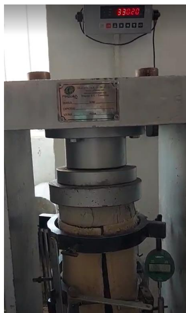
Figura 146: Capacidad de carga a los 28 días para el concreto patrón (3)
