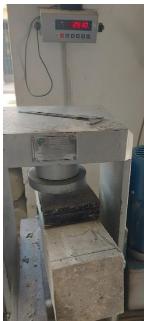
Figura 182: Capacidad de carga a flexión a los 56 días para el GEB al 2% (2)
