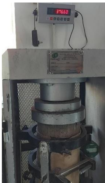
Figura 101: Capacidad de carga a los 28 días para el concreto patrón (3)
