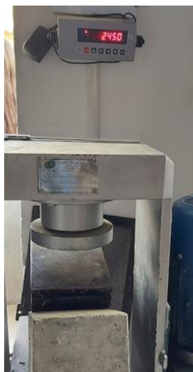
Figura 186: Capacidad de carga a flexión a los 7 días para el GEB al 2.5% (2)
