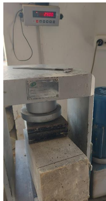
Figura 190: Capacidad de carga a flexión a los 56 días para el GEB al 2.5% (1)
