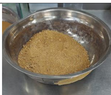
Figura 19: Muestra de agregado fino
