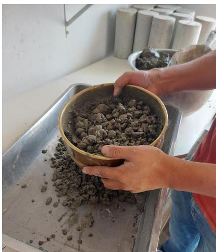
Figura 89: Tamizado de la mezcla de concreto
