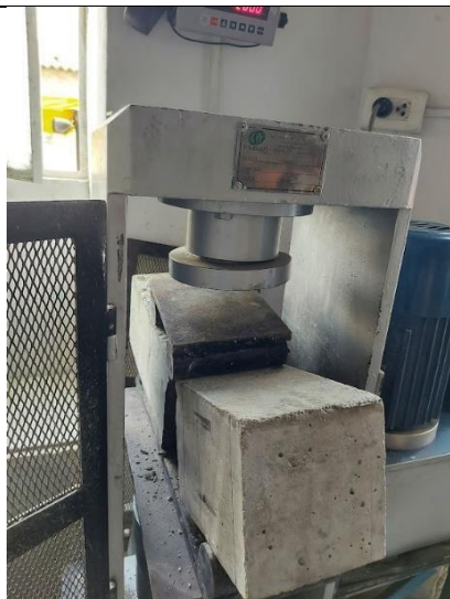
Figura 60: Ensayo de rotura a flexión de vigas
