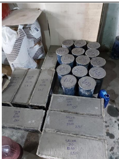
Figura 53: Desencofrado de vigas y probetas
