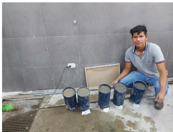
Figura 45: Ensayo de exudación de la muestra patrón y las dosificaciones con biocarbon
