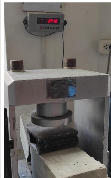
Figura 163: Capacidad de carga a flexión a los 7 días para el concreto patrón (3)
