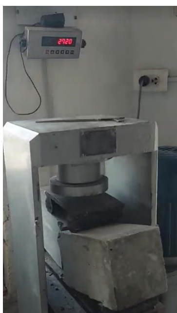
Figura 183: Capacidad de carga a flexión a los 56 días para el GEB al 2% (3)
