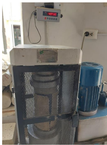
Figura 114: Capacidad de carga a los 56 días para el GEB al 1% (1)
