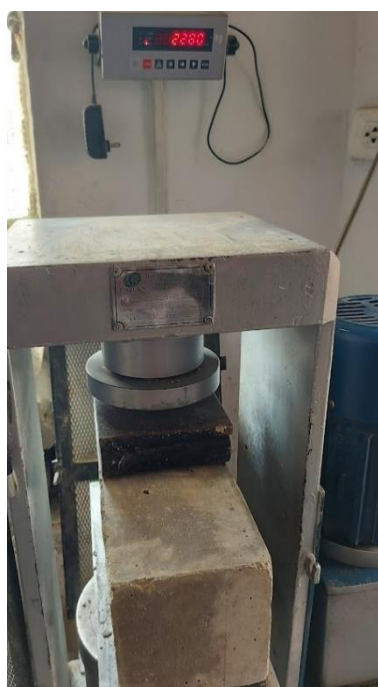
Figura 170: Capacidad de carga a flexión a los 28 días para el GEB al 1% (1)
