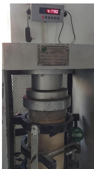
Figura 123: Capacidad de carga a los 28 días para el GEB al 2% (1)
