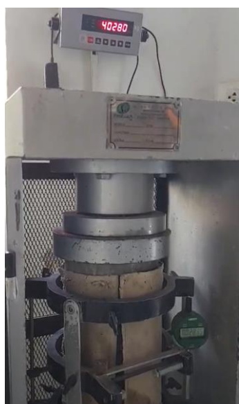
Figura 111: Capacidad de carga a los 28 días para el GEB al 1% (1)
