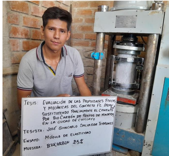
Figura 58: Tesista ensayando el módulo de elasticidad del concreto con biocarbon al 2.5%
