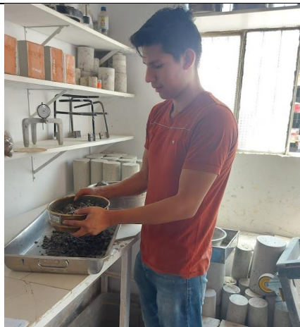
Figura 47: tamizando la mezcla por la malla N° 4
