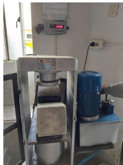
Figura 61: Rotura de vigas de concreto
