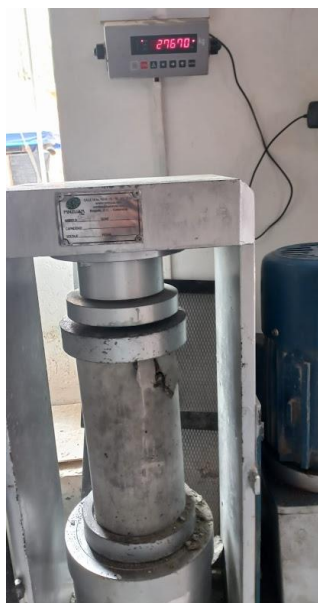
Figura 133: Capacidad de carga a los 14 días para el GEB al 2.5% (2)
