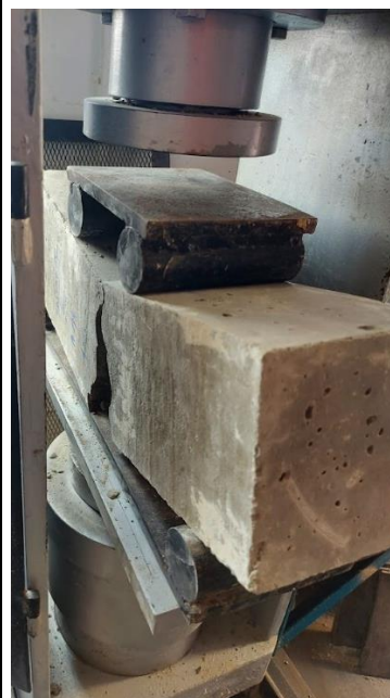
Figura 172: Falla de viga a los 28 días para el GEB al 1%
