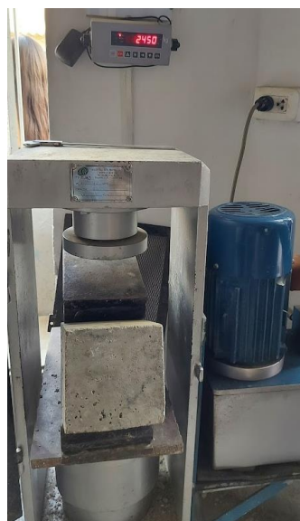
Figura 161: Capacidad de carga a flexión a los 7 días para el concreto patrón (1)
