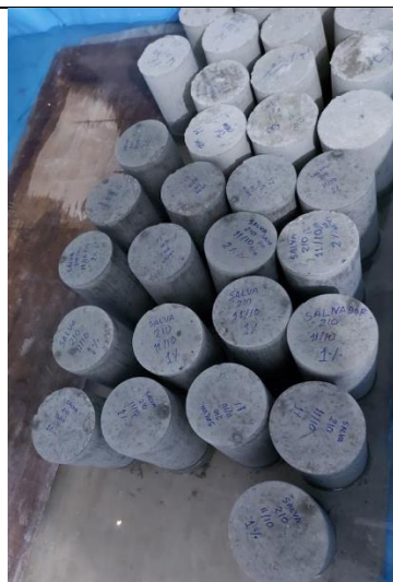
Figura 52: Probetas cilíndricas dentro de la piscina de curado
