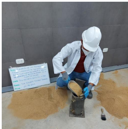
Figura 26: Ensayo de peso unitario suelto del agregado fino
