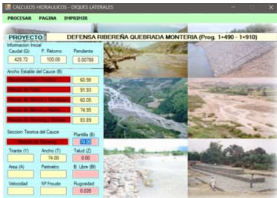
Figura 33. Ancho estable - progresiva 1+390 - 1+910
