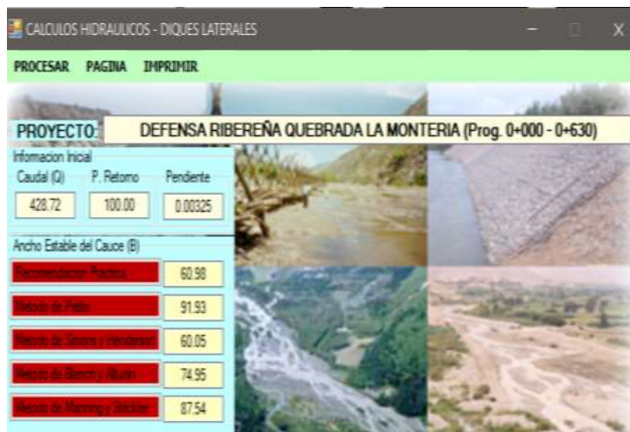
Figura 31. Ancho Estable - Progresiva 0+000 - 0+630
