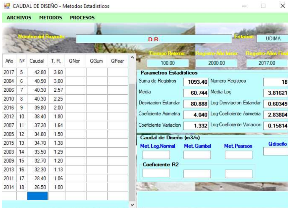
Figura 13. Cálculo de Caudal - Estación Udima
