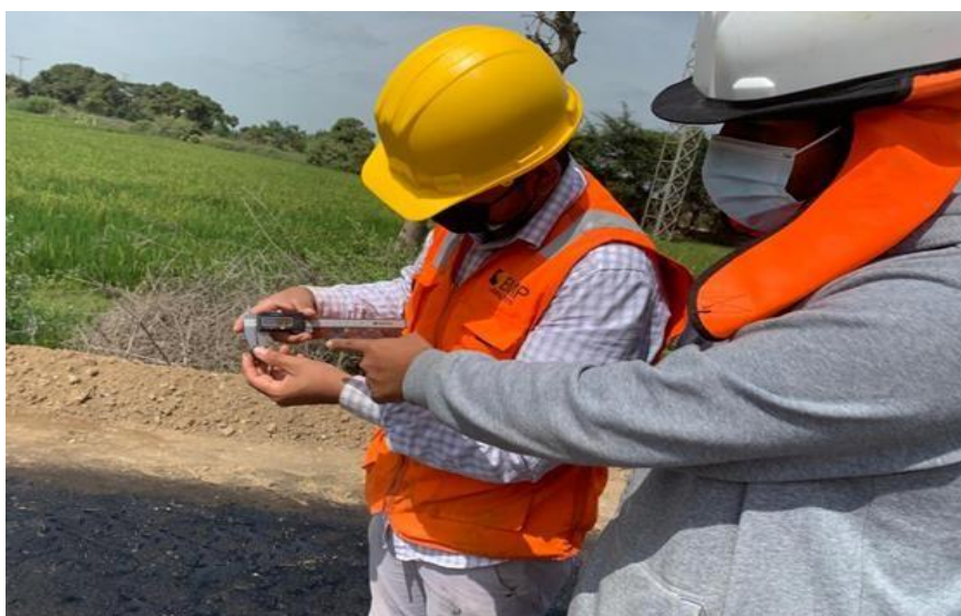
Anexo N°02.98: Penetración de 1.30mm, progresiva 0+020km
