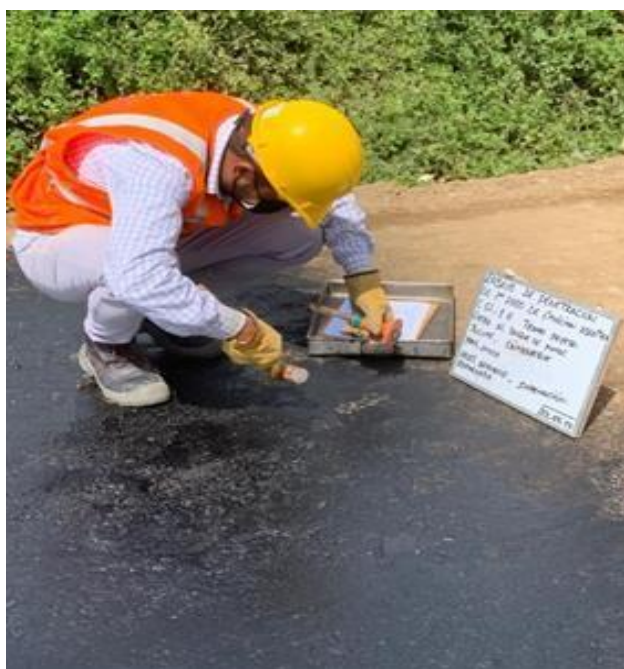
Ilustración 97: Ensayo de Penetración en emulsiones asfálticas
