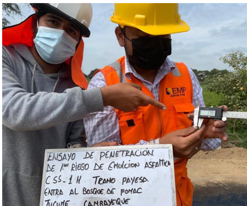
Ilustración 99: Penetración de 1.79mm, progresiva 0+070km
