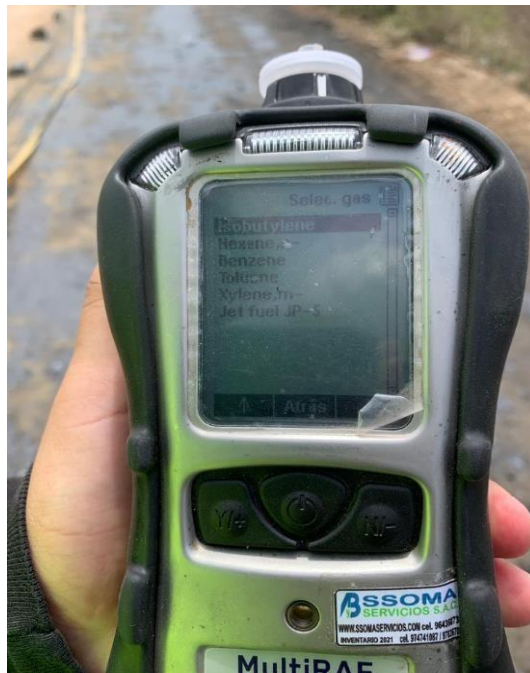
Ilustración 132: Gases que conforman el Compuesto Orgánico Volátil(Cov's)
