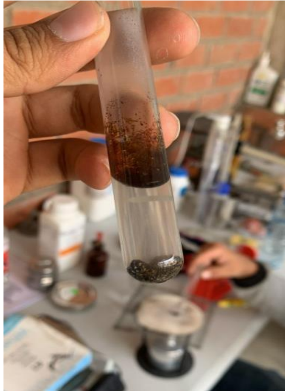
Anexo N°02.37: Desprendimiento total del MC-30 con el agregado, tras mantenerse calentado 1 minuto después del punto de ebullición
