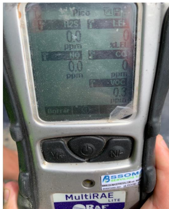
Ilustración 133: Valor máximo de Isobutileno obtenido (0.3 ppm)
