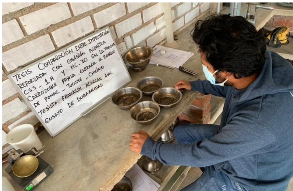
Ilustración 67: Colocación de sulfato de sodio y reposo del material por 18 horas
