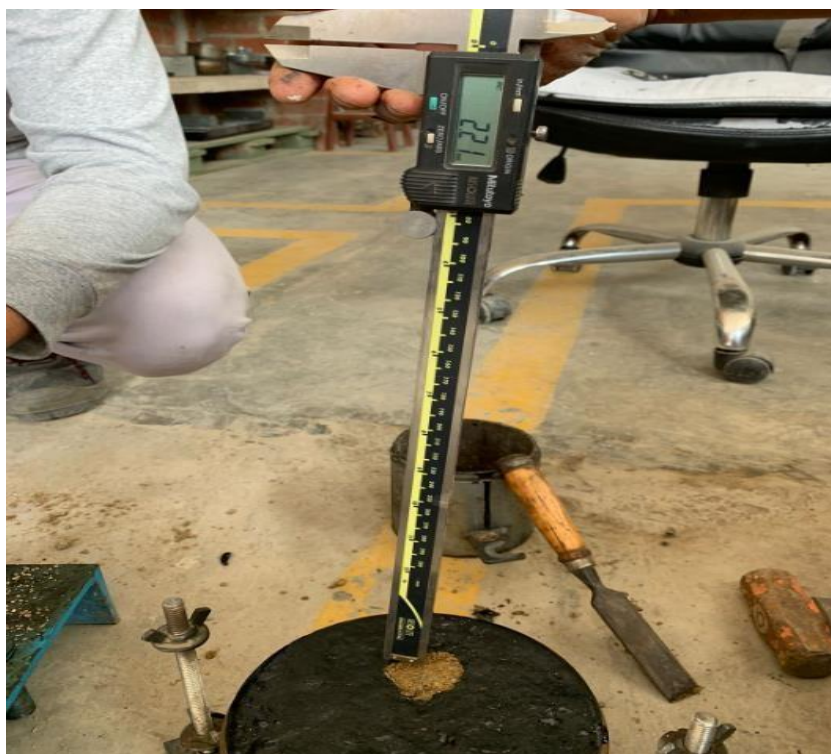
Anexo N°02.42: Penetración 2.21mm, 1er riego de imprimación reforzada con tasa de 1.70 lt/m 2
