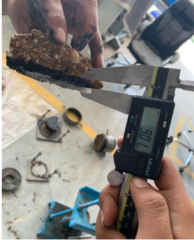
Anexo N°02.51: Primer Riego de imprimación con MC-30 con tasa de 1.70 lt/m 2
