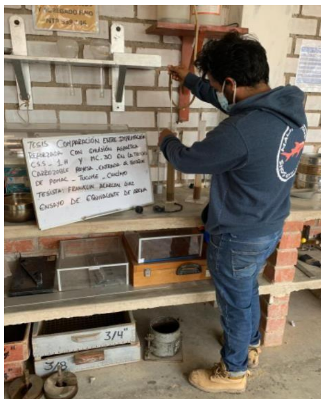
Anexo N°02.16 y 17: Lavado del material fino presente en las paredes de la probeta con el tubo irrigador
