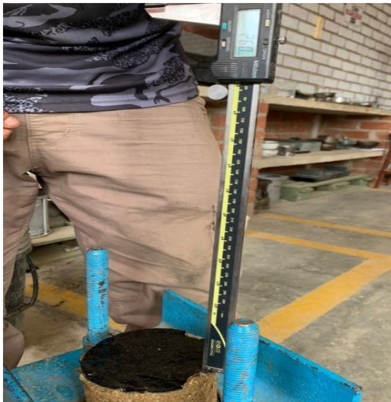
Anexo N°02.44: Penetración 2.60mm, 1er riego de imprimación reforzada con tasa de 1.85 lt/m 2
