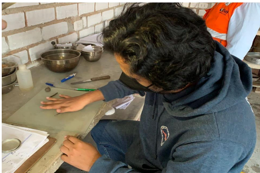
Ilustración 54: Moldeado de la muestra hasta darle forma elipsoide
