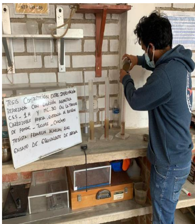
Ilustración 59 y 60: Colocación de material mediante el embudo a la probeta de plástico
