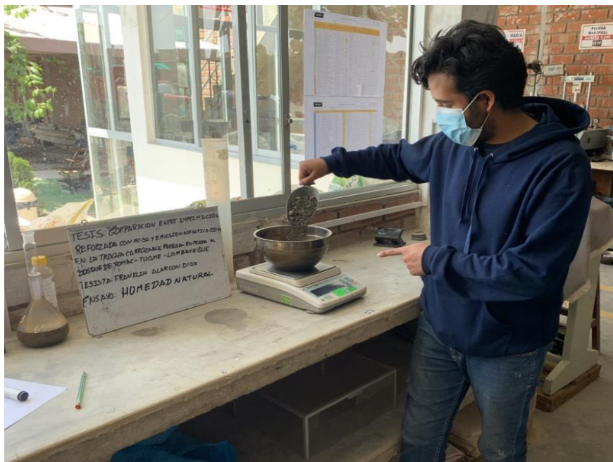
Ilustración 48: Pesado del material de humedad natural
