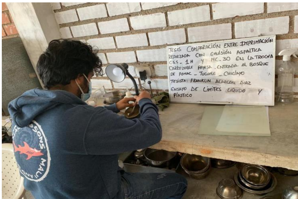
Anexo N°02.6: División de la muestra contenido en la cuchara de Casagrande mediante el acanalador
