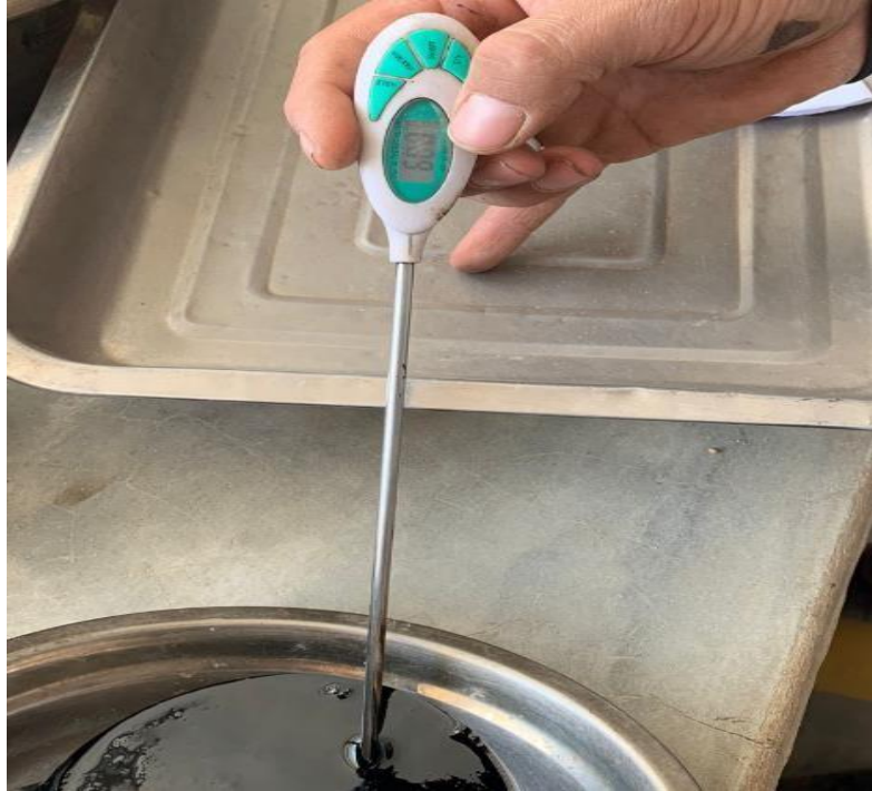
Anexo N°02.49: Calentado del MC-30 a 60.0°C
