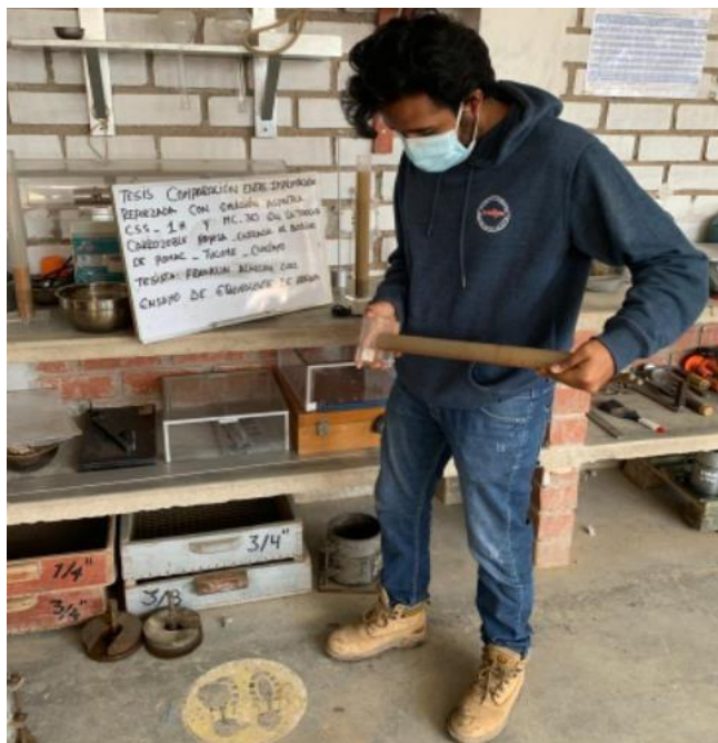
Ilustración 61: Agitación manual horizontal de la probeta
