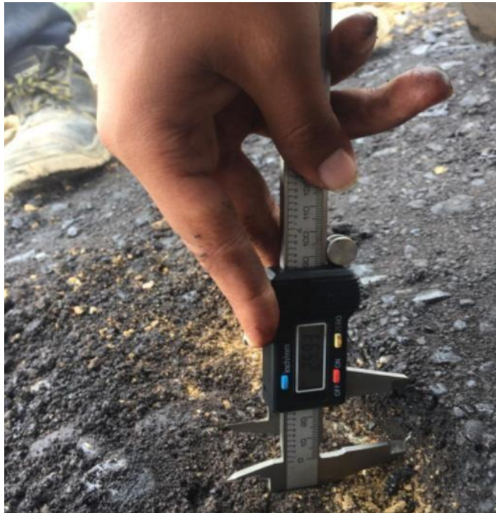
Ilustración 130: Penetración 25.93mm, progresiva 0+110km
