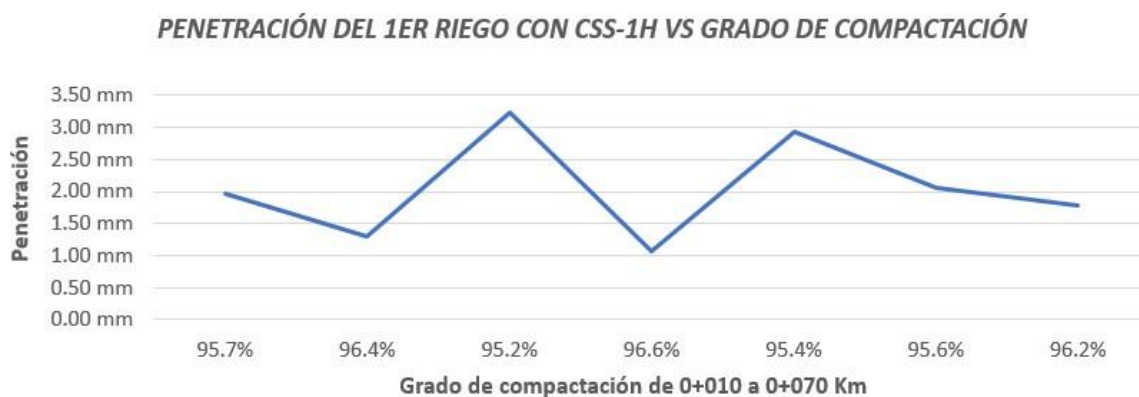
Cuadro N°36: Penetraciones del primer riego de imprimación reforzada con emulsión CSS-1h vs Grado de compactación del afirmado
