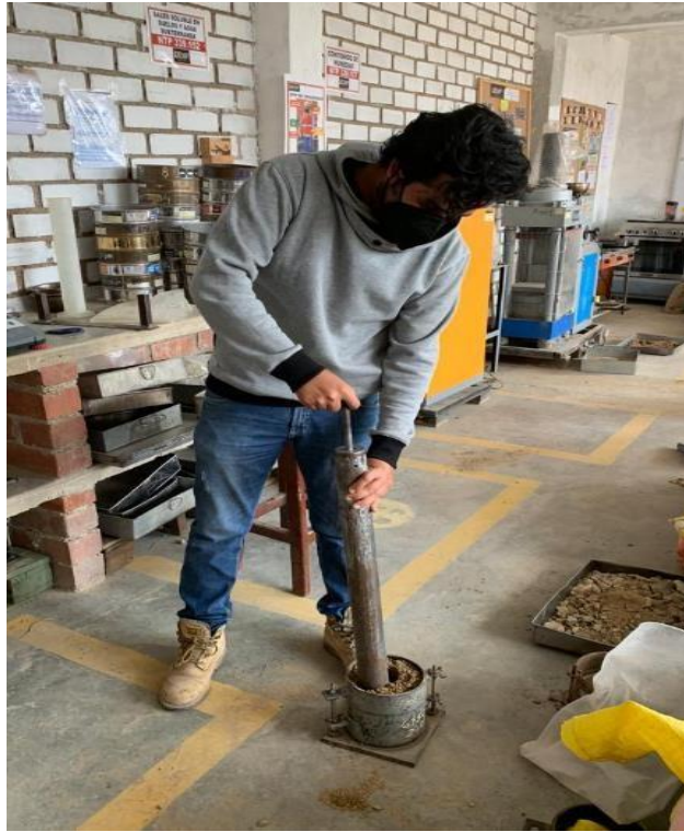
Anexo N°02.19: Compactación del material con el pisón o martillo
