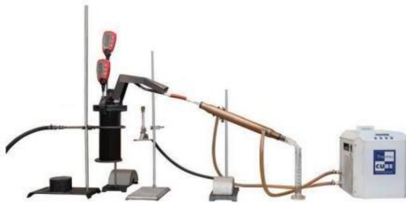
Ilustración N°34: Medición de Contenido de Asfalto [34]
