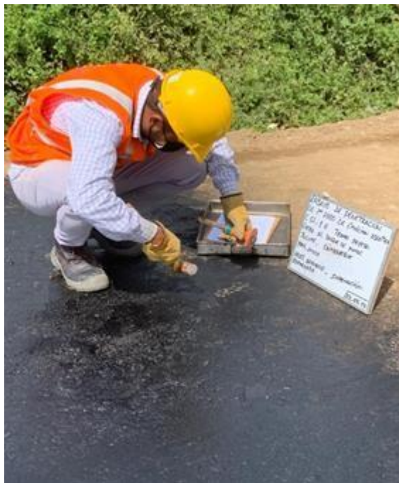
Anexo N°02.95: Ensayo de Penetración en emulsiones asfálticas
