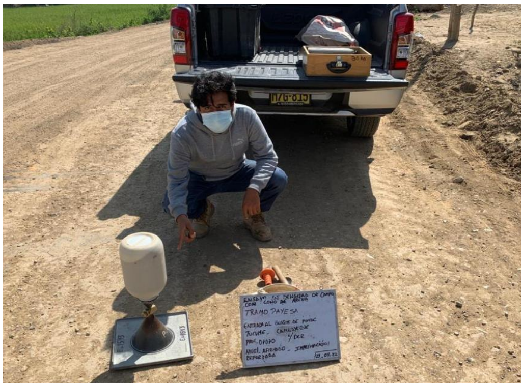
Ilustración 94: Ensayo de densidad de campo, progresiva 0+070km
