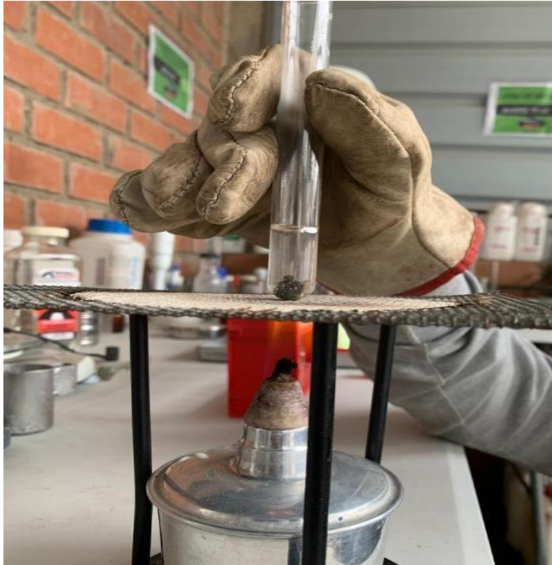
Anexo N°02.31: Calentado del tubo que contiene el agua y la mezcla hasta el punto de ebullición.
