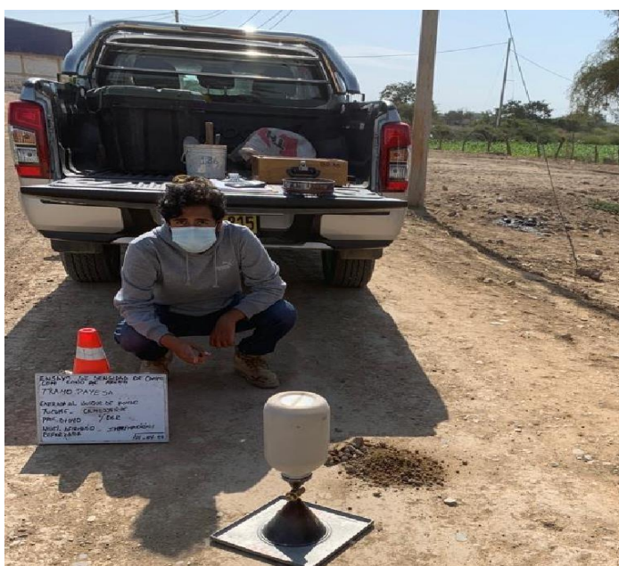
Anexo N°02.84: Ensayo de densidad de campo, progresiva 0+030km
