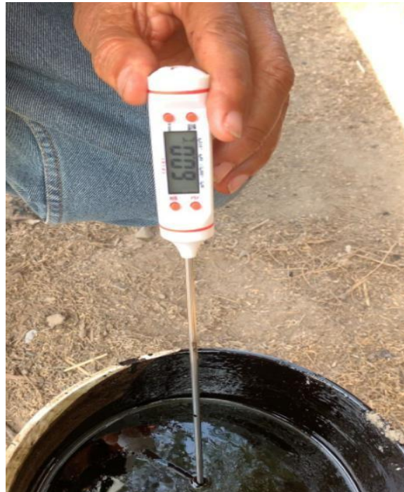
Ilustración 140: Medición de la temperatura tras ser calentada en la cocina asfáltica(60.0°C)
