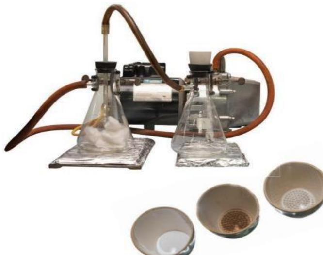
Ilustración N°41: Ensayo de solubilidad en tricloroetileno [34]
