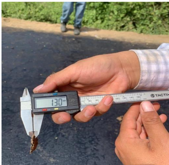
Anexo N°02.98: Penetración de 1.30mm, progresiva 0+020km
