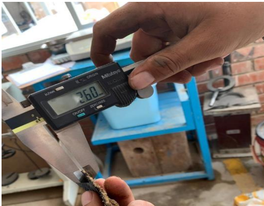
Anexo N°02.46: Penetración 2.60mm, 1er riego de imprimación reforzada con tasa de 1.85 lt/m 2
