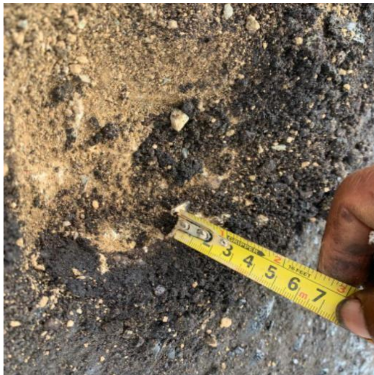
Ilustración 131: Penetración 36 mm, progresiva 0+140km
