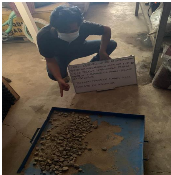
Ilustración 58: Descargue de material de la máquina de los Ángeles
