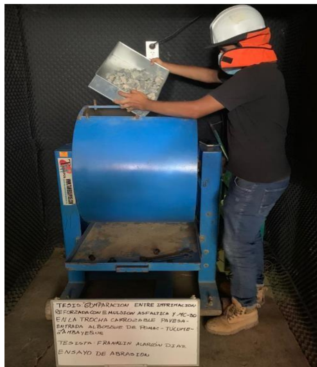
Anexo N°02.2: Colocación de 5000g de agregado grueso
