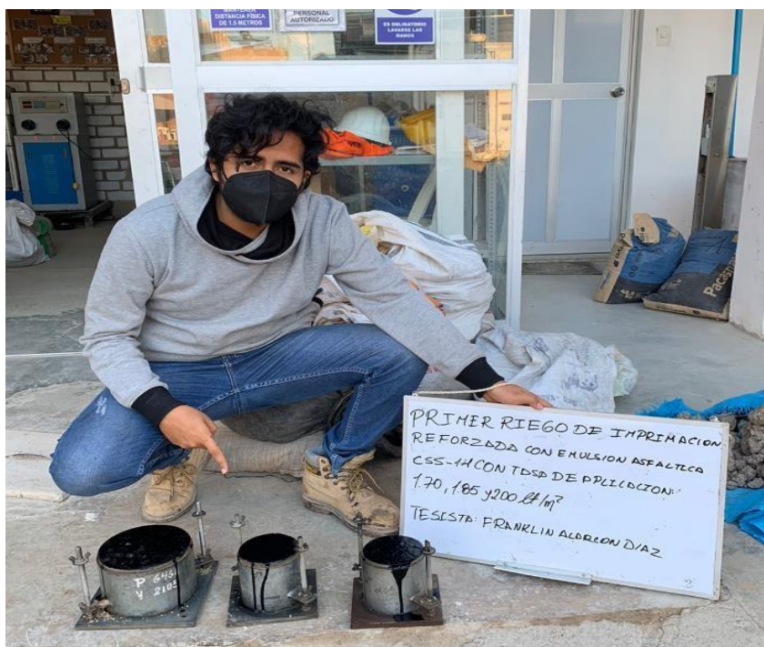
Ilustración 74: Primer Riego de imprimación reforzada con emulsión asfáltica con tasas de 1.70, 1.85 y 2.00 lt/m 2
