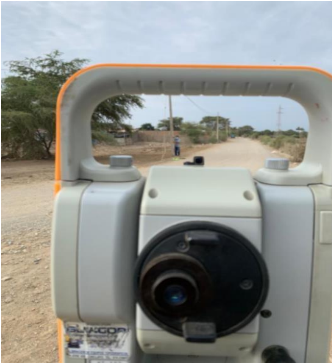
Anexo N°02.116: Nivelación con estación total y prismas
