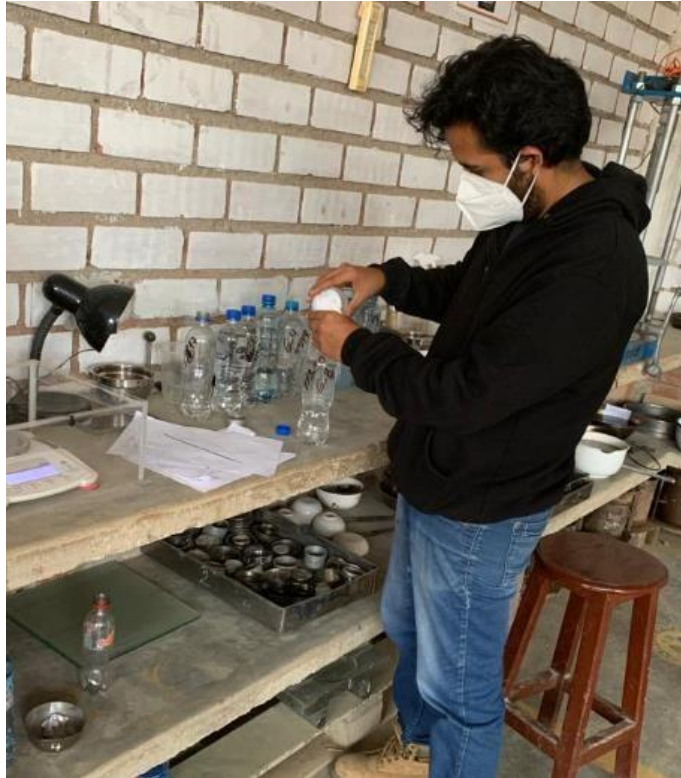
Anexo N°02.29: Colocación del carbonato sódico al agua para elaboración de concentraciones
