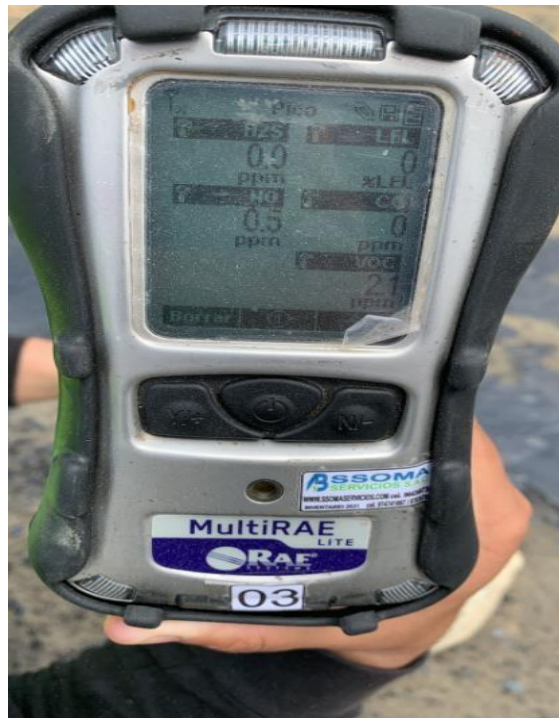
Ilustración 134: Valor máximo de Isobutileno obtenido (2.1 ppm)
