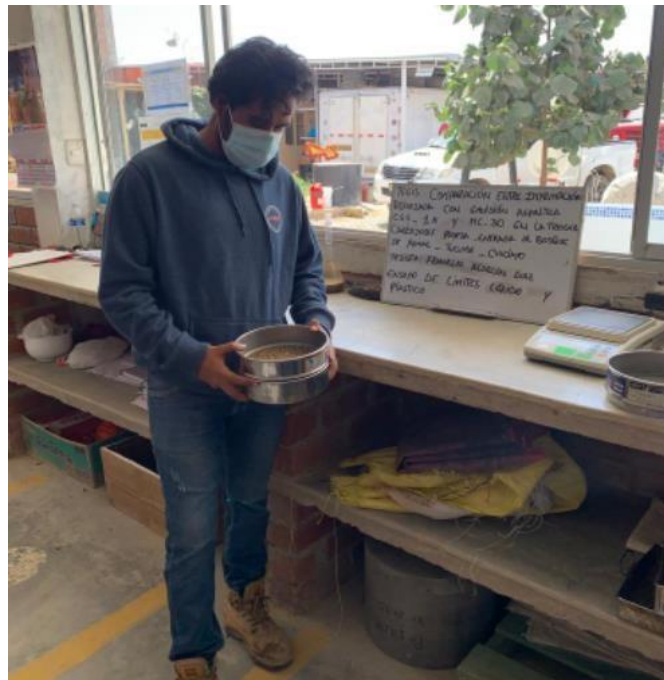
Anexo N°02.5: Tamizado de material por el tamiz 425 \mu m(N°40)
