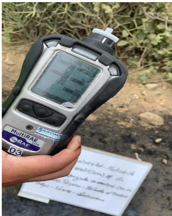
Ilustración 100: Valor máximo de Isobutileno obtenido (0.2ppm)
