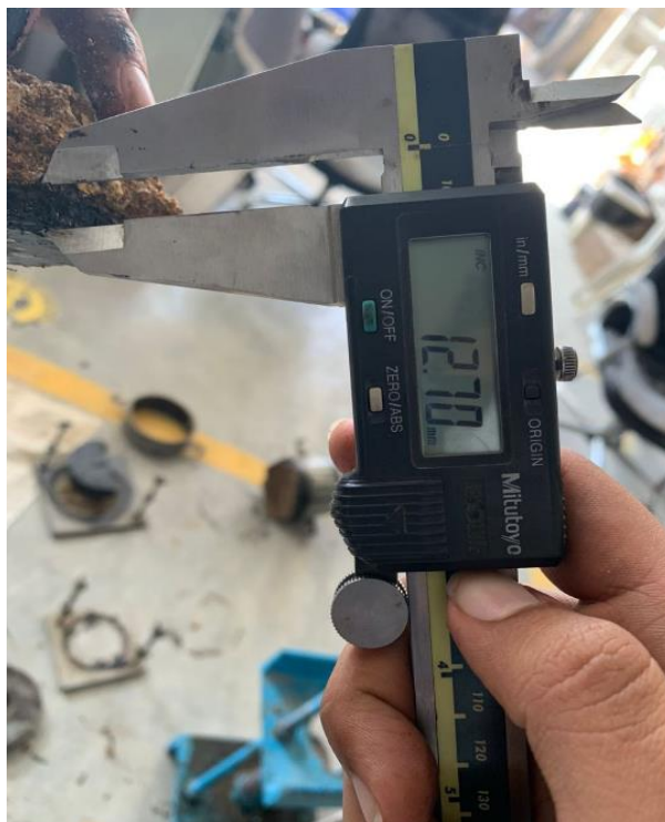
Ilustración 81: Penetración 12.70 mm del primer riego de imprimación reforzada con MC-30 con tasa de 2.00 lt/m 2
