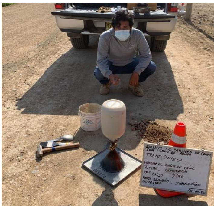
Anexo N°02.84: Ensayo de densidad de campo, progresiva 0+030km
