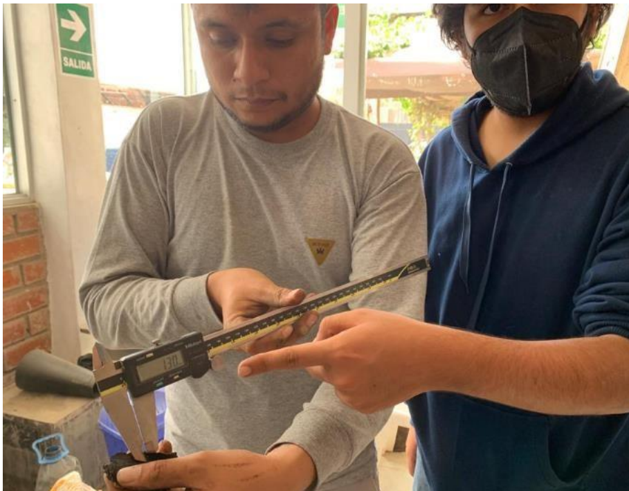
Anexo N°02.48: Penetración 1.30mm, 1er riego de imprimación reforzada con tasa de 2.00 lt/m 2
