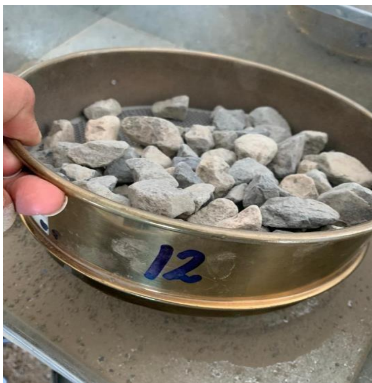
Anexo N°02.4: Tamizado del material obtenido, por el tamiz 1,70mm(N°12)
