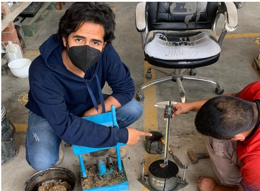
Ilustración 75: Penetración 2.21mm del primer riego de imprimación reforzada con emulsión asfáltica CSS-1h con tasa de 1.70 lt/m 2
