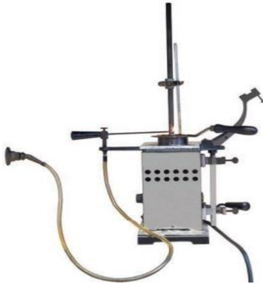
Ilustración N°45: Punto de inflamación en copa abierta de Cleveland [34]
