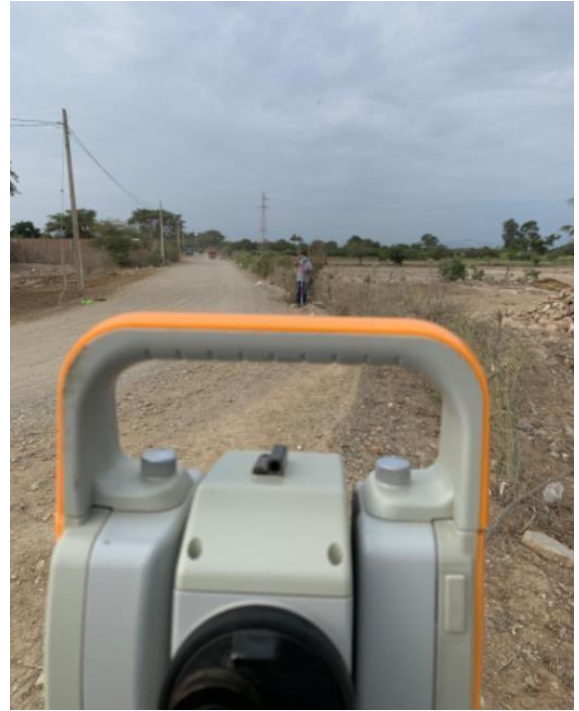
Anexo N°02.116: Nivelación con estación total y prismas
