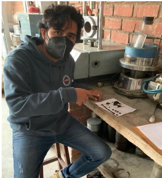
Anexo N°02.30: Elaboración de la mezcla del material con emulsión con un peso aproximado de 0.50 gramos
