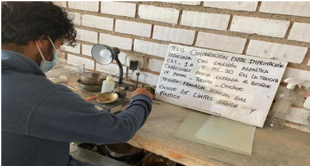
Anexo N°02.7: Girado del manubrio de la cuchara de casa grande para levantar y soltar la cuchara.
