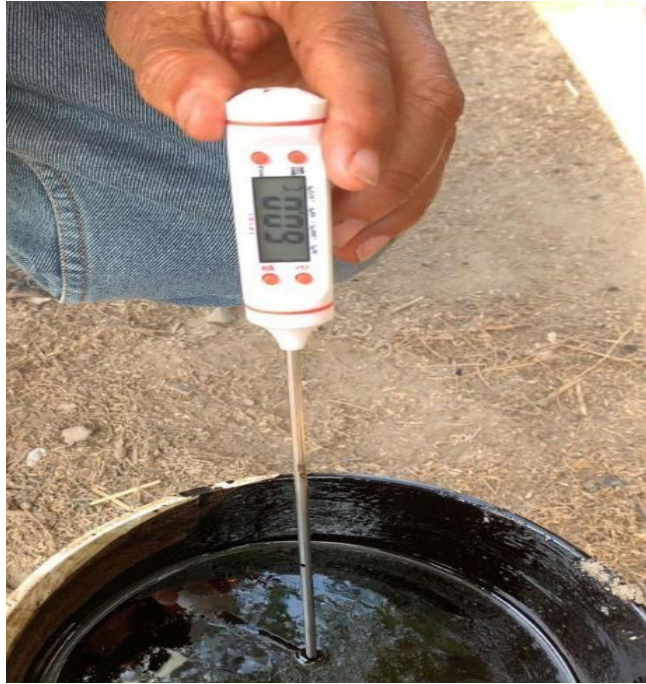
Ilustración 128: Medición de la temperatura del MC-30 tras ser calentado por la cocina asfáltica
