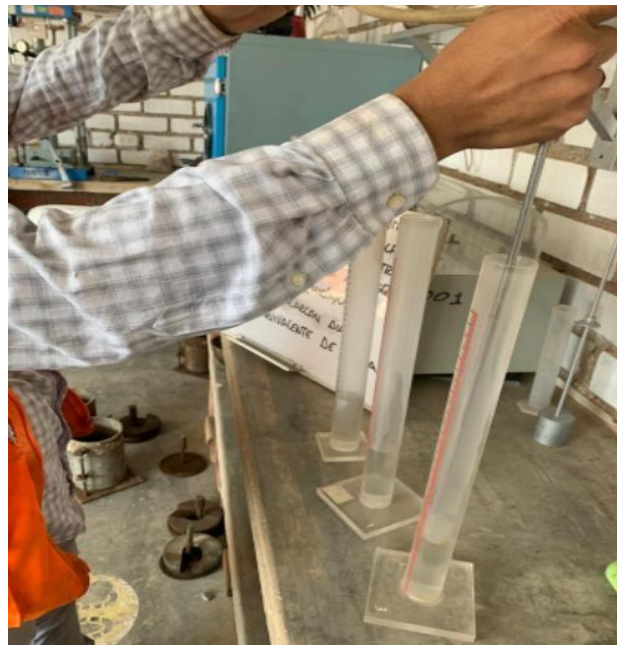
Anexo N°02.12: Colocación de solución de cloruro de calcio en la probeta cilíndrica de plástico
