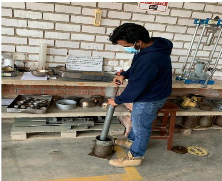
Ilustración 65: Compactación del material con el pisón o martillo
