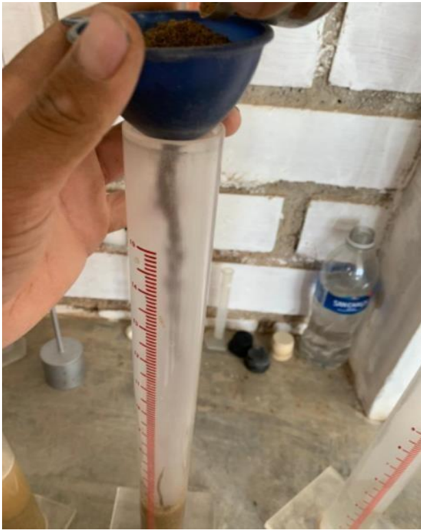
Anexo N°02.13 y 14: Colocación de material mediante el embudo a la probeta de plástico
