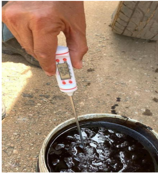
Ilustración 108: Medición de la temperatura tras ser calentada en la cocina asfáltica(40.0°C)
