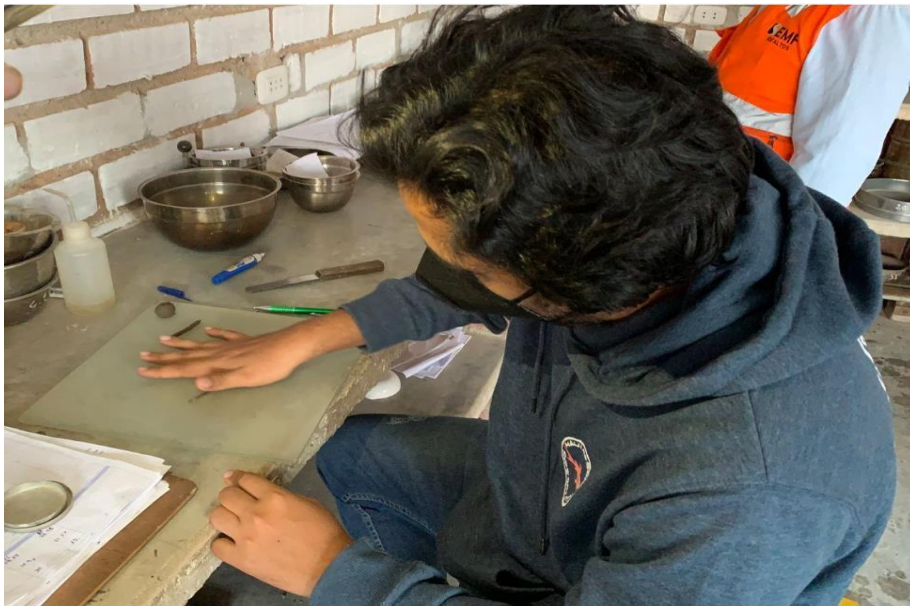
Anexo N°02.8: Moldeado de la muestra hasta darle forma elipsoide
