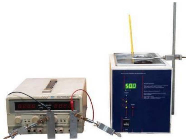
Ilustración N°37: Prueba de carga eléctrica de partícula [34]
