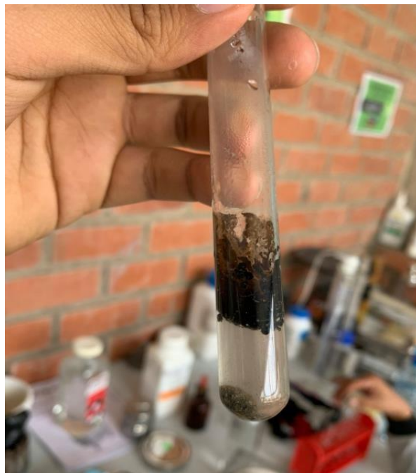
Anexo N°02.38: Desprendimiento total del MC-30 con el agregado, tras mantenerse calentado 1 minuto después del punto de ebullición
