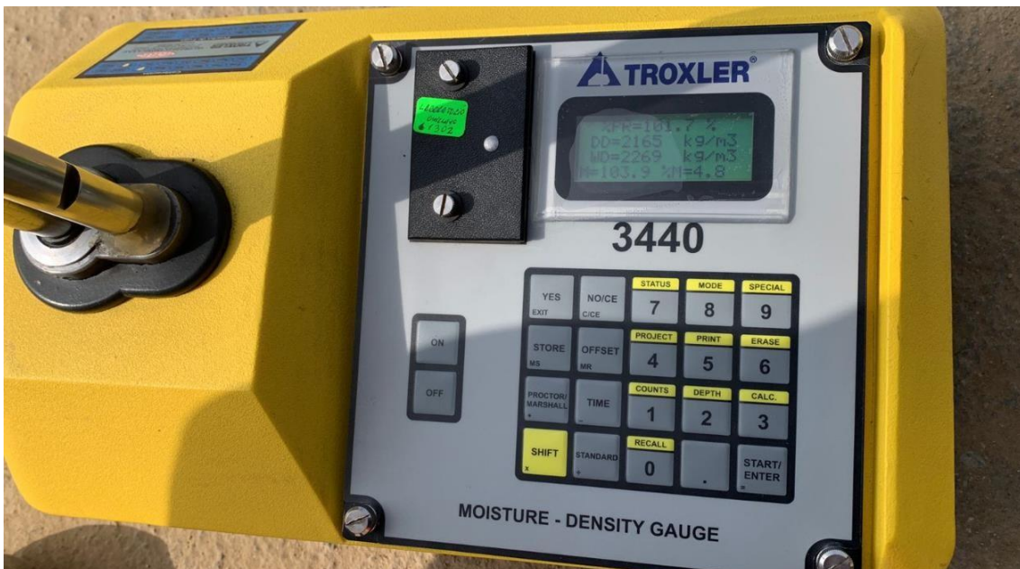
Ilustración 113: Progresiva 0+030 Km, grado de compactación 101.7%
