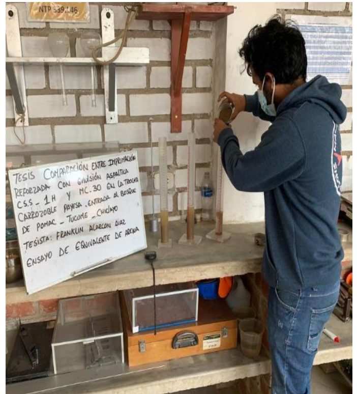
Anexo N°02.13 y 14: Colocación de material mediante el embudo a la probeta de plástico
