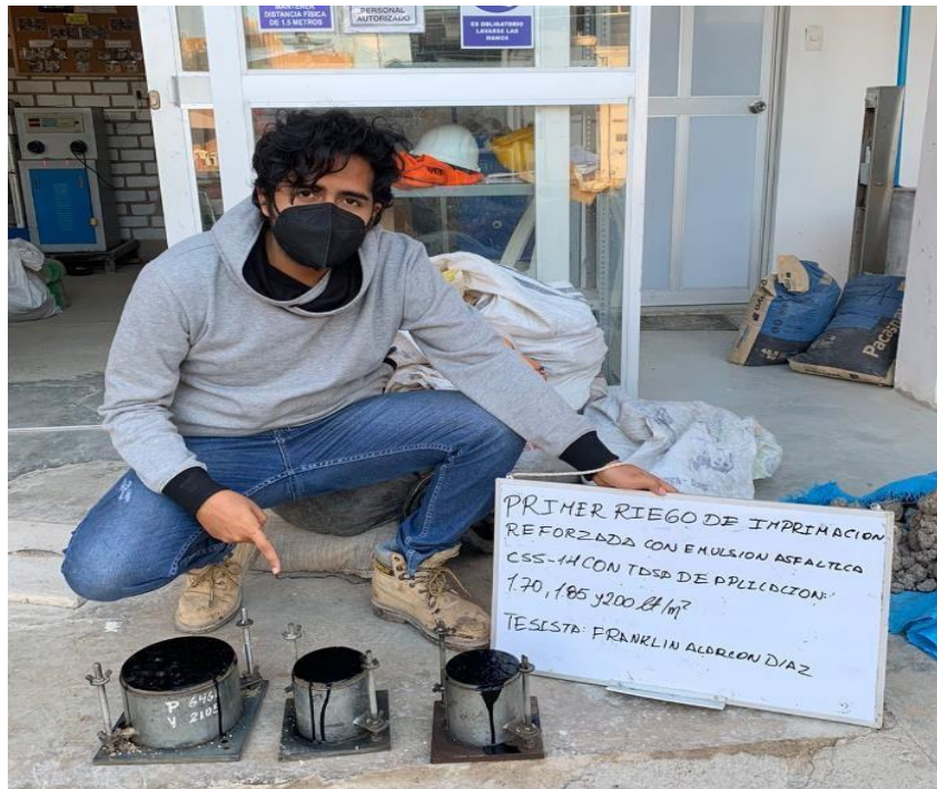
Anexo N°02.41: Primer Riego de imprimación reforzada con emulsión asfáltica CSS-1h con tasas de 1.70,1.85 y 2.00 lt/m 2
