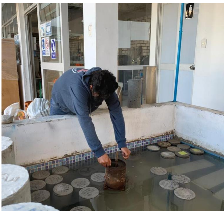
Ilustración 66: Sumergido del molde cilíndrico al agua
