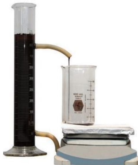
Ilustración N°35: Prueba de estabilidad o asentamiento [34]
