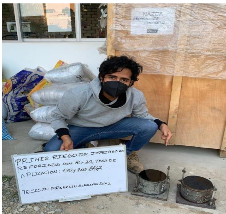
Ilustración 78: Primer Riego de imprimación con MC-30 con tasas de 1.70, 1.85 y 2.00 lt/m 2
