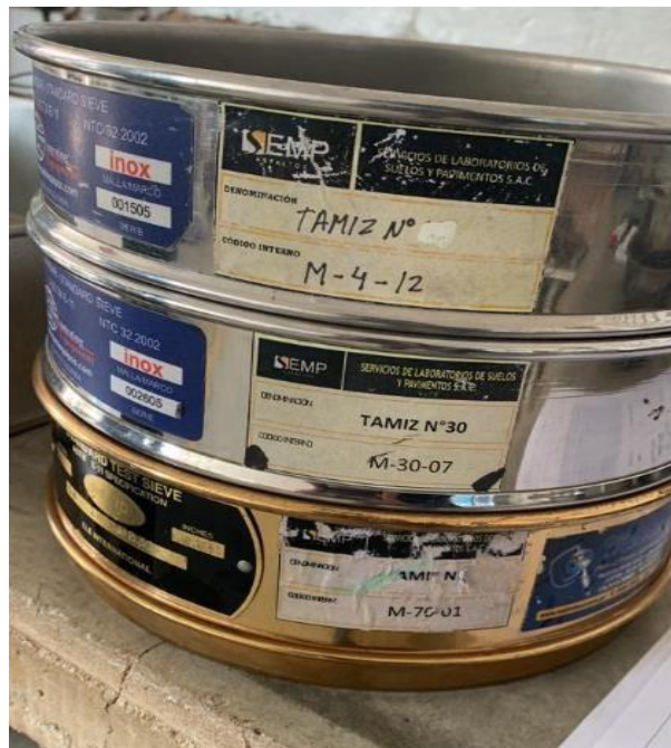
Anexo N°02.33: Tamizado del agregado fino por los tamices N°30 y 70
