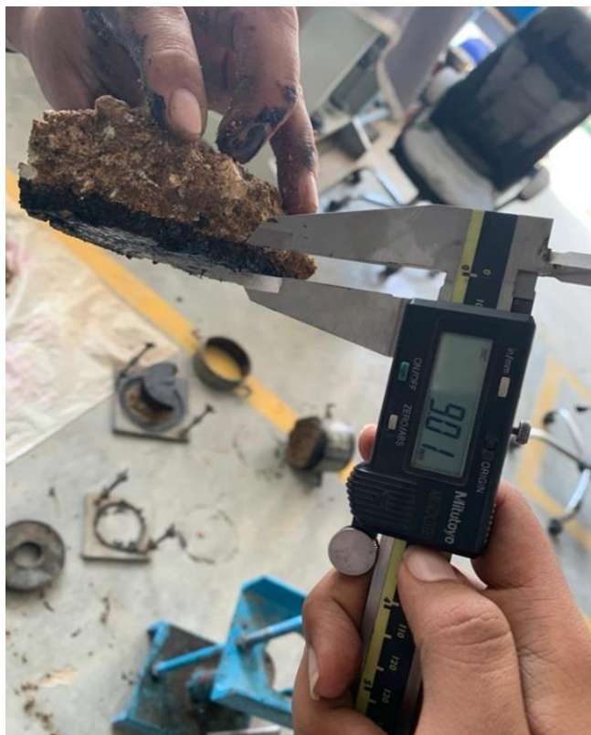
Ilustración 79: Penetración 9.01 mm del primer riego de imprimación reforzada con MC-30 a tasa de 1.70 lt/m 2
