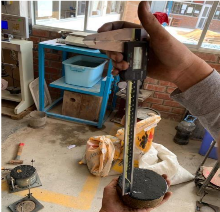
Anexo N°02.47: Penetración 1.30mm, 1er riego de imprimación con tasa de 2.00 lt/m 2
