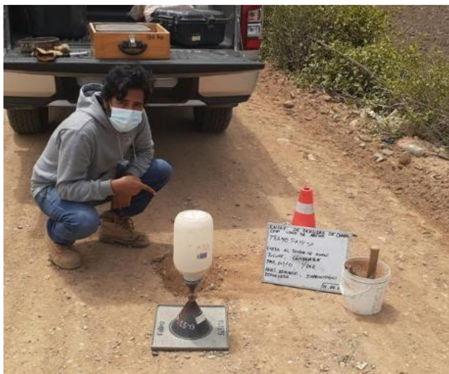
Anexo N°02.139: Ensayo de densidad de campo, progresiva 0+110km
