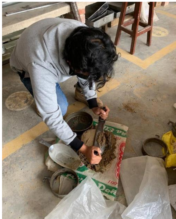
Anexo N°02.20: Enrasado del material mediante una regla
