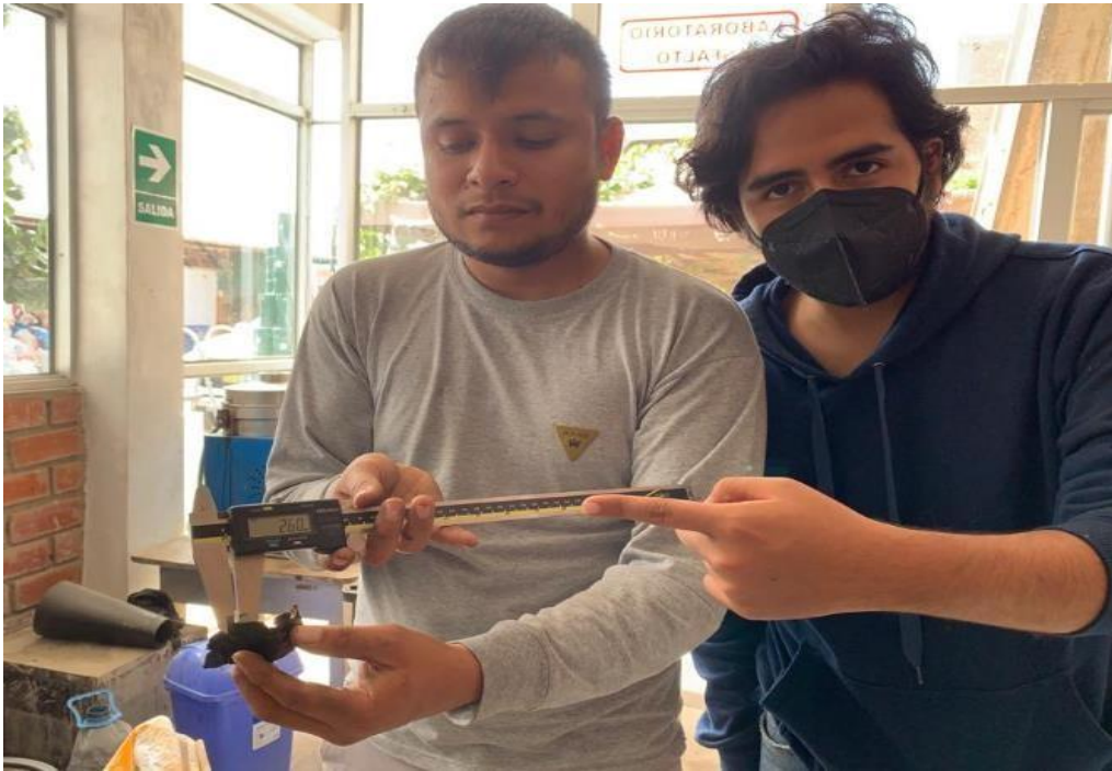
Anexo N°02.45: Penetración 2.60mm, 1er riego de imprimación reforzada con tasa de 1.85 lt/m 2
