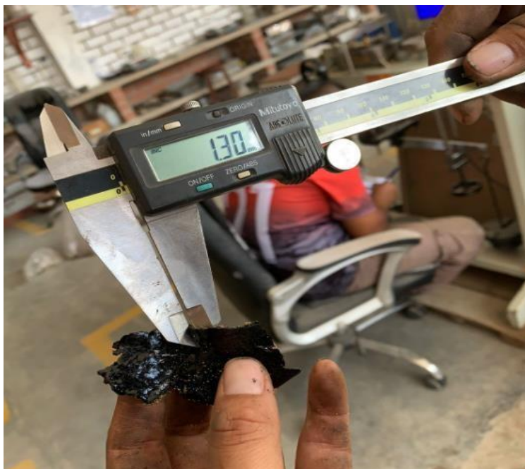
Ilustración 77: Penetración 1.30 mm del primer riego de imprimación reforzada con emulsión asfáltica CSS-1h con tasa de 2.00 lt/m 2
