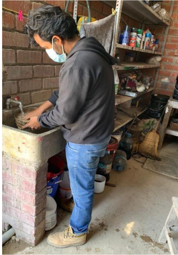
Anexo N°02.27: Lavado del material sobre el tamiz N°70
