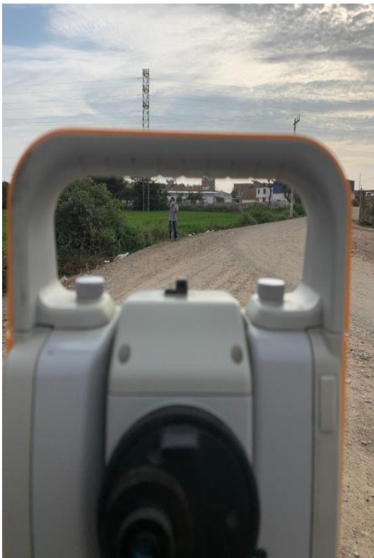
Anexo N°02.61 y 62: Nivelación con estación total y prismas
