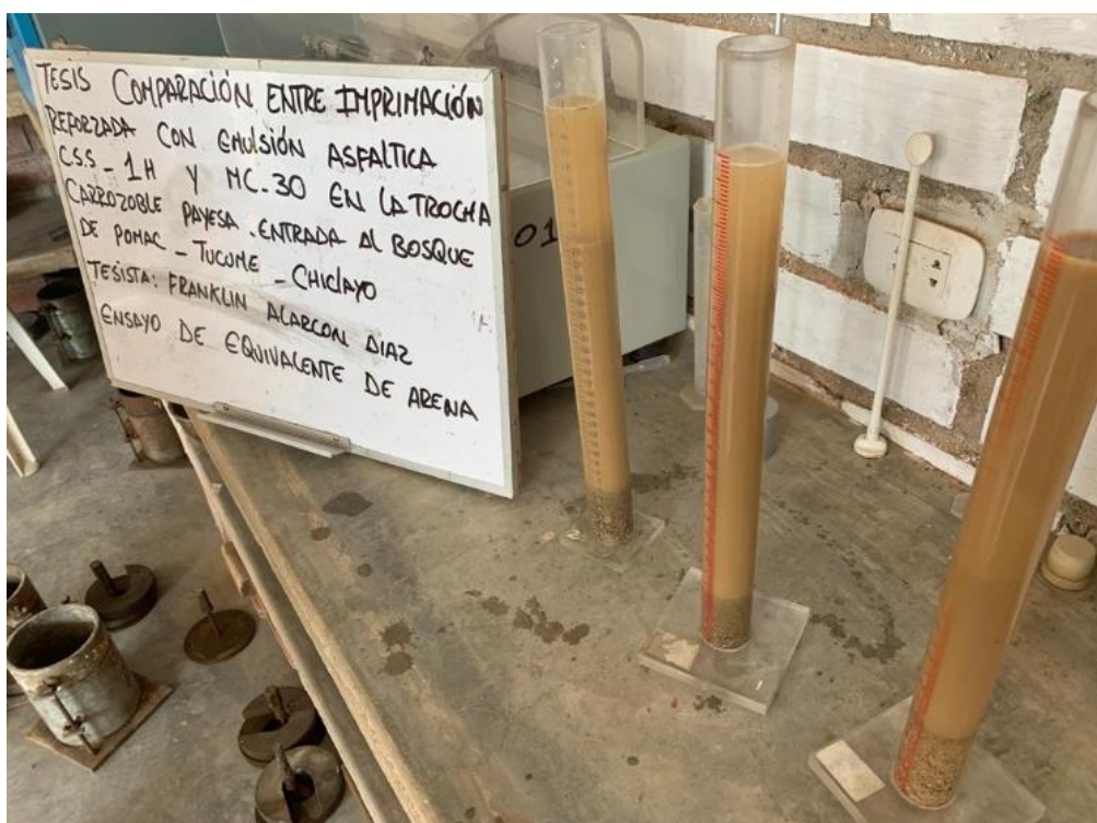
Anexo N°02.18: Reposo del contenido y la probeta por un periodo de 20min
