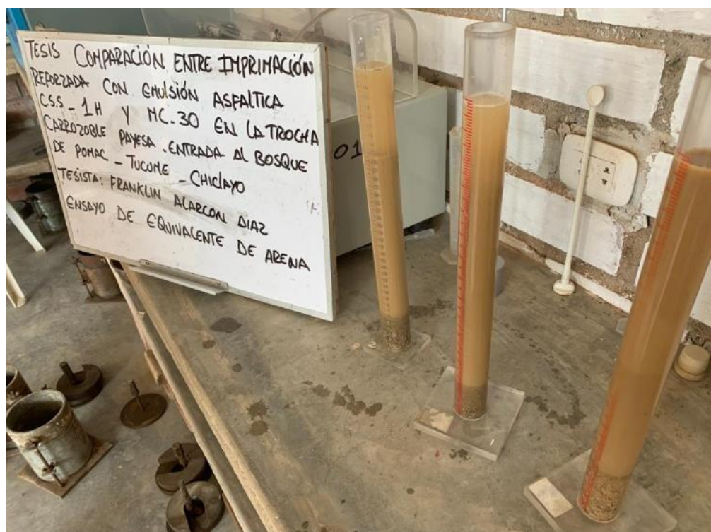
Ilustración 61: Agitación manual horizontal de la probeta
