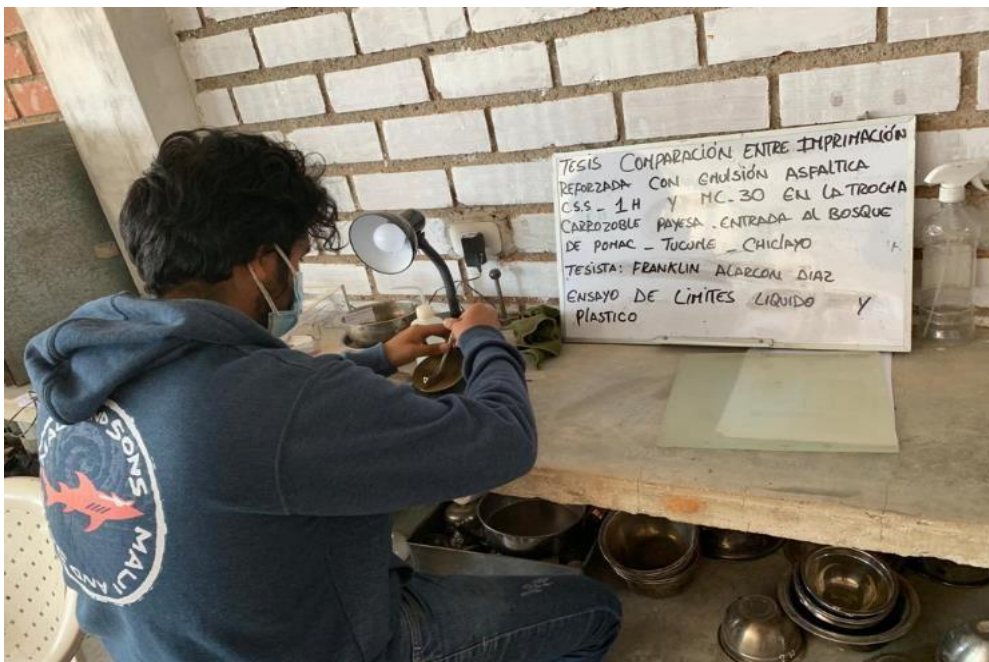
Ilustración 52: División de la muestra contenido en la cuchara de Casagrande mediante el acanalador
