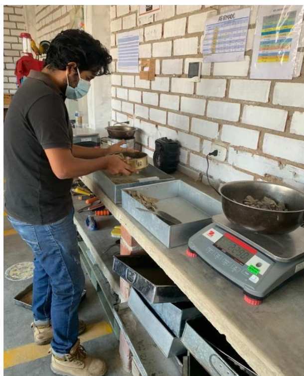
Anexo N°02.4: Tamizado del material obtenido, por el tamiz 1,70mm(N°12)
