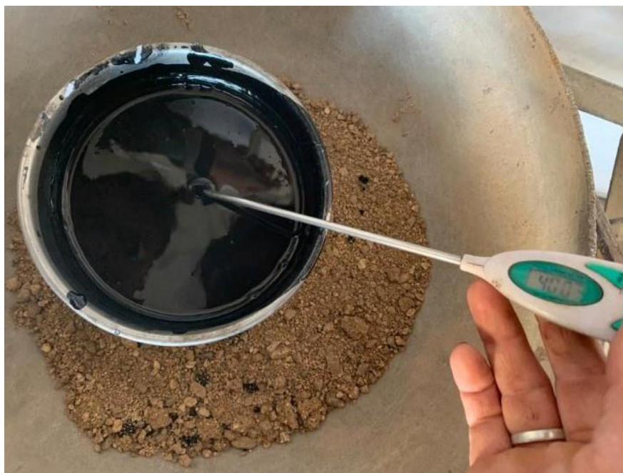
Anexo N°02.40: Calentado de la emulsión asfáltica a 40.0°C
