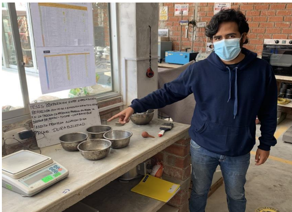
Anexo N°02.24: Eliminación del sulfato de sodio y reposo del material
