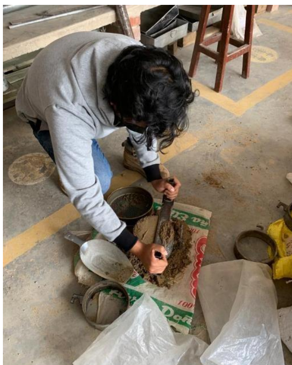
Ilustración 64: Enrasado del material mediante una regla
