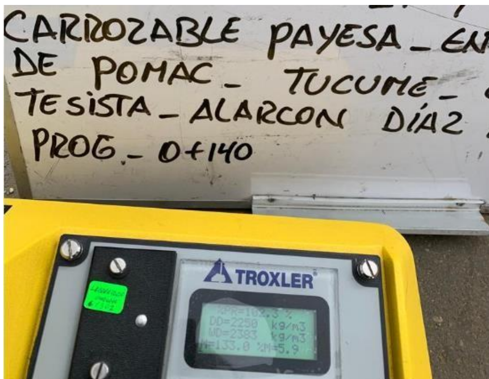
Anexo N°02.161: Progresiva 0+140 Km, grado de compactación 102.3%
