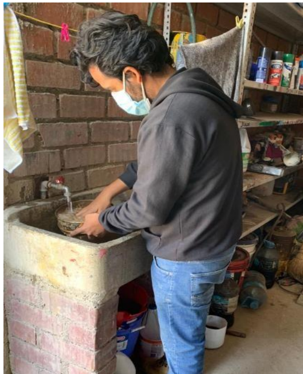
Anexo N°02.34: Lavado del material sobre el tamiz N°70
