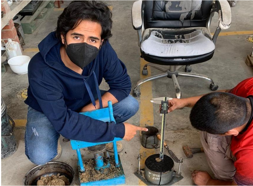
Anexo N°02.43: Penetración 2.21mm, 1er riego de imprimación reforzada con tasa de 1.70 lt/m 2
