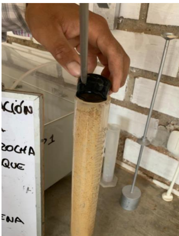
Anexo N°02.16 y 17: Lavado del material fino presente en las paredes de la probeta con el tubo irrigador
