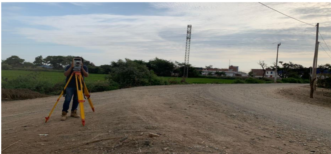
Anexo N°02.115: Nivelación con estación total y prismas
