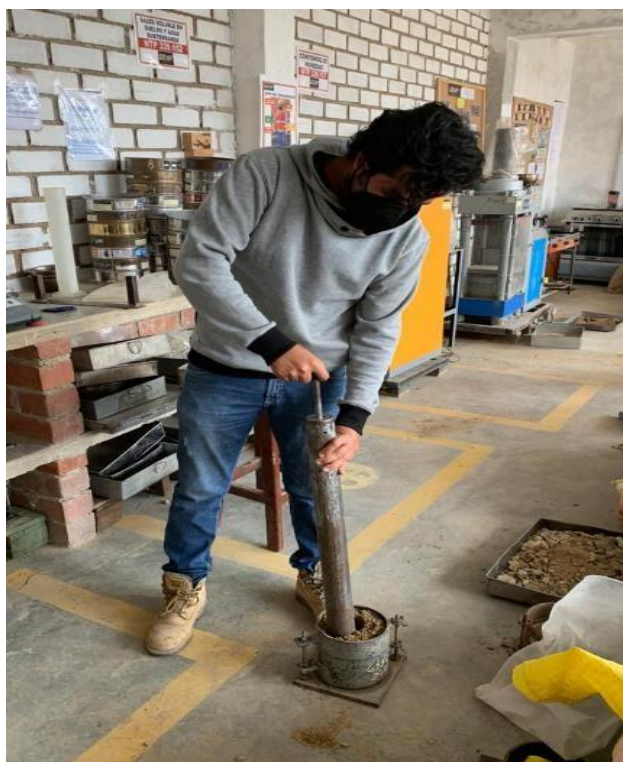
Ilustración 63: Compactación del material con el pisón o martillo
