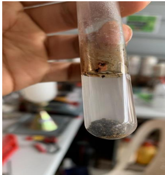
Anexo N°02.32: Desprendimiento total de la emulsión con el agregado, tras mantenerse calentado 1 minuto después del punto de ebullición
