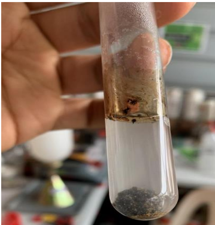
Ilustración 71: Desplazamiento total de la emulsión y el agregado
