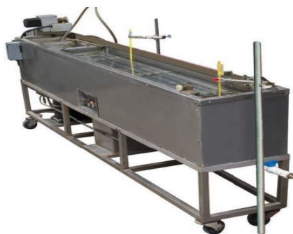
Ilustración N°40: Ensayo de ductilidad de asfaltos a 25°C [34]
