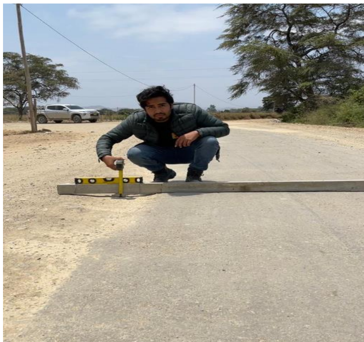
Ilustración 146: Pérdida del revestimiento asfáltico, generación de polución
