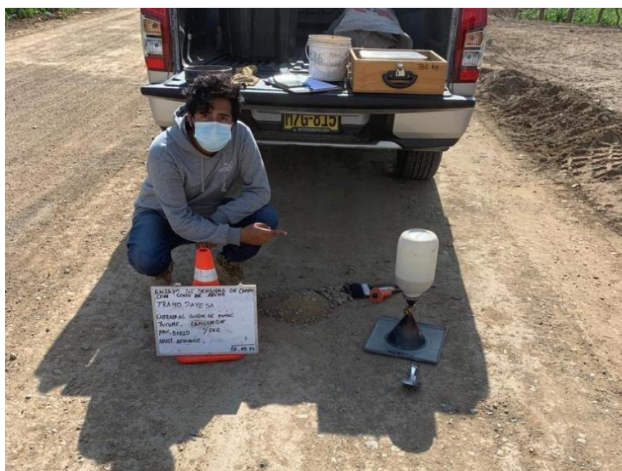
Anexo N°02.83: Ensayo de densidad de campo, progresiva 0+020km
