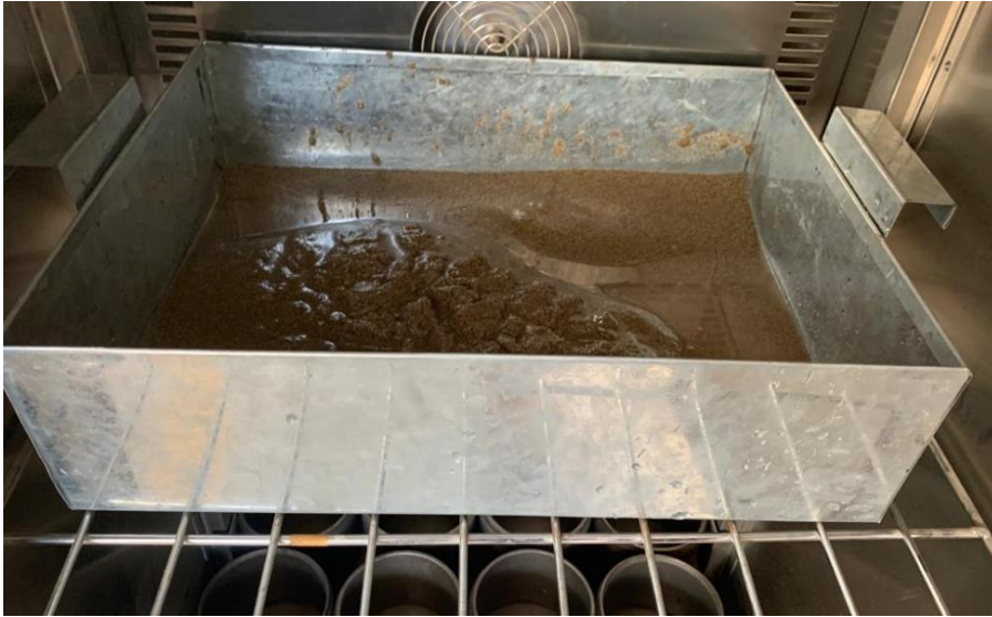
Anexo N°02.35: Colocación en el horno a temperatura de 145^{\circ}\pm 5^{\circ}\text{C} durante 1 hora
