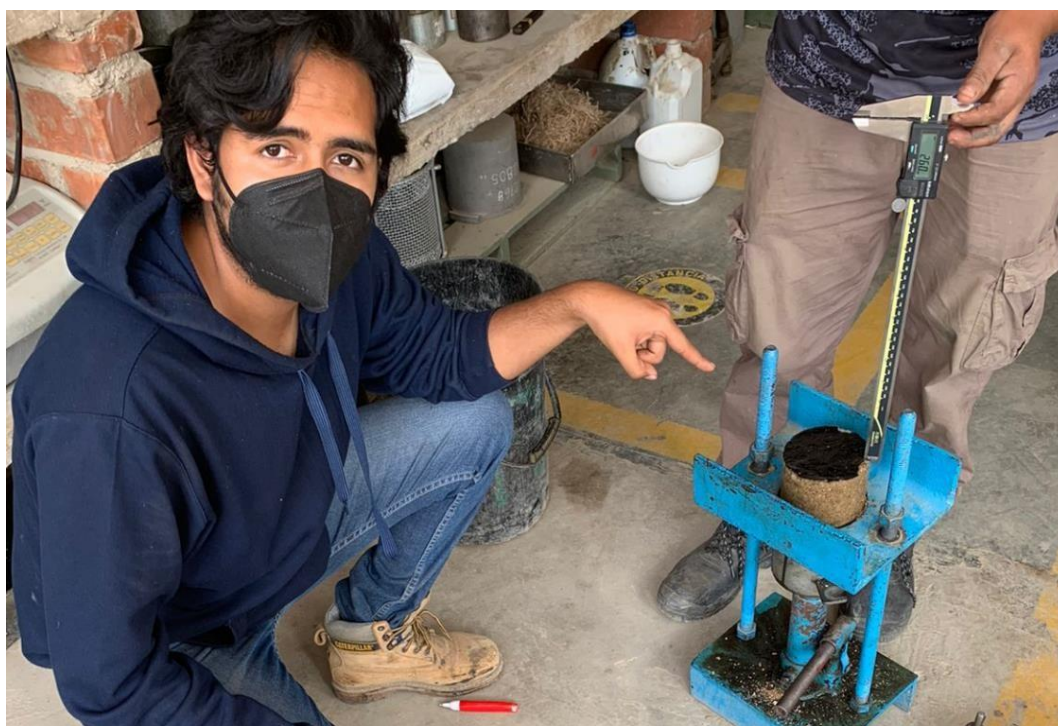
Ilustración 76: Penetración 2.60 mm del primer riego de imprimación reforzada con emulsión asfáltica CSS-1h con tasa de 1.85 lt/m 2
