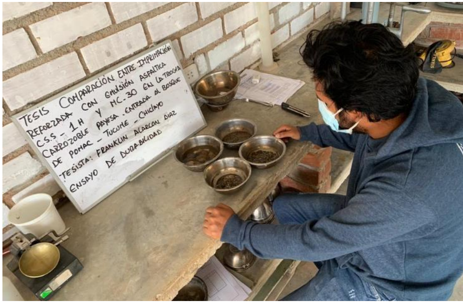
Anexo N°02.23: Colocación de sulfato de sodio y reposo del material por 18 horas
