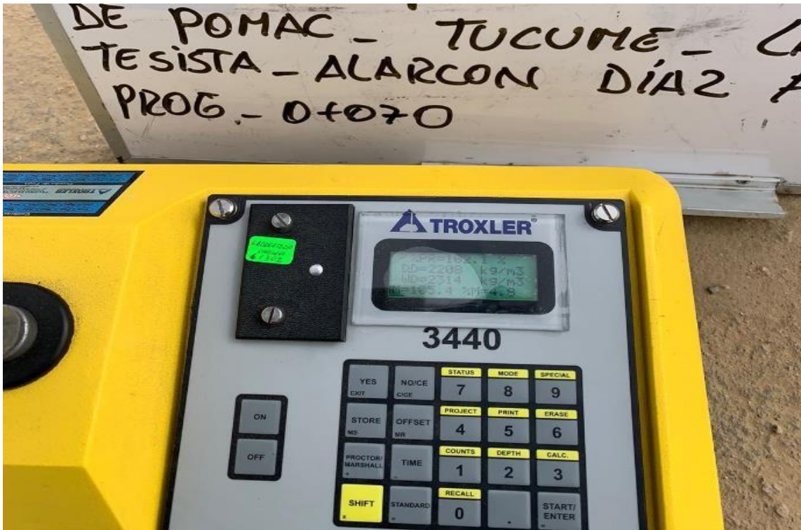
Ilustración 114: Progresiva 0+070 Km, grado de compactación 102.1%
