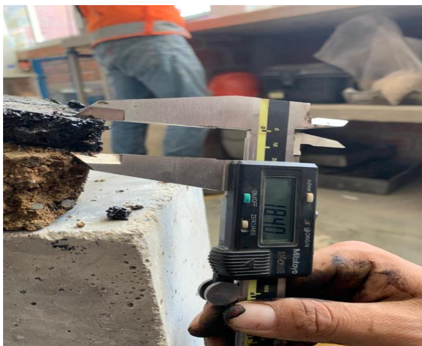
Ilustración 80: Penetración 18.40 mm del primer riego de imprimación reforzada con MC-30 a tasa de 1.85 lt/m 2
