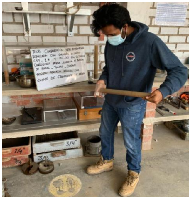
Anexo N°02.15: Agitación manual horizontal de la probeta
