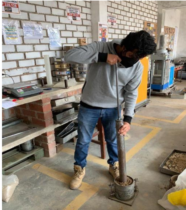
Anexo N°02.39: Ensayo de Proctor modificado para realizar el primer riego de imprimación con emulsión CSS-1h
