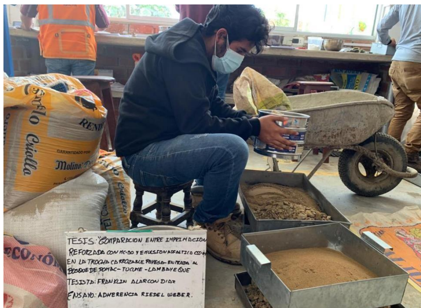
Anexo N°02.26: Tamizado del agregado fino por los tamices N°30 y 70
