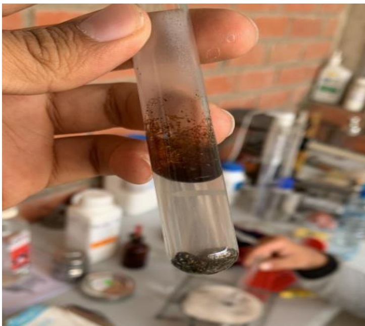
Ilustración 73: Desplazamiento total del MC-30 y el agregado
