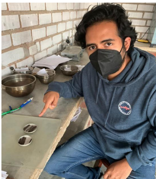
Ilustración 55: Colocación de las porciones obtenidas en pesa filtros
