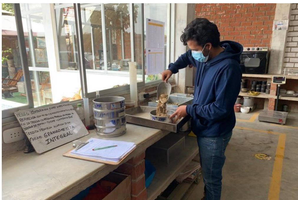
Ilustración 51: Granulometría integral del agregado
