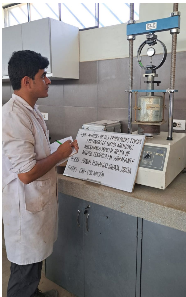
Figura 40: Penetración de muestra para CBR con adición
