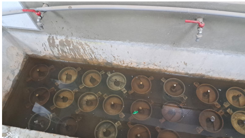
Figura 39: Inmersión de muestra para CBR con adición
