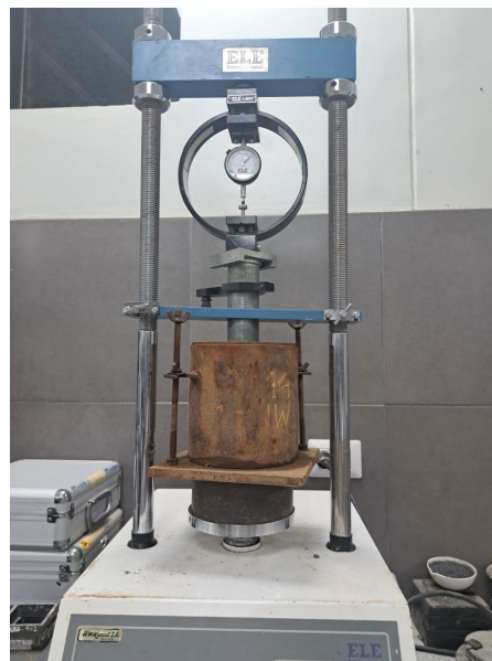
Figura 32: Ensayo CBR de suelos: penetración
