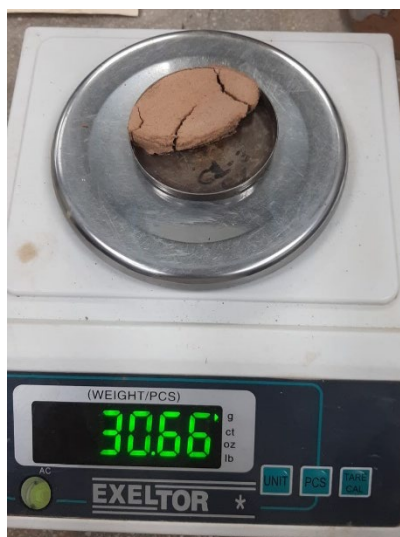
Figura 36: Muestra seca con adición necesaria para determinar el índice de plasticidad
