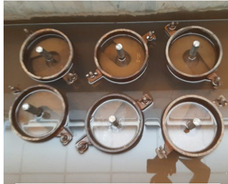
Figura 31: Ensayo CBR de suelos: inmersión
