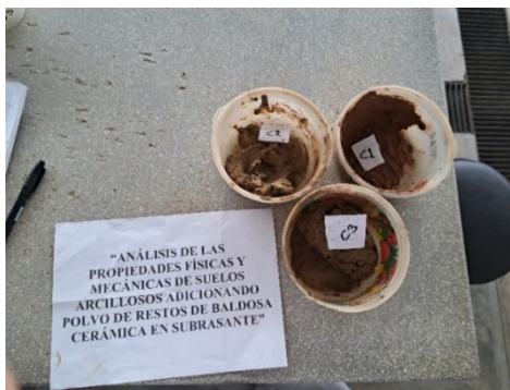
Figura 18: Muestras saturadas para realizar los ensayos de límite líquido
