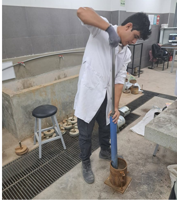
Figura 38: Compactación de muestra para CBR con adición
