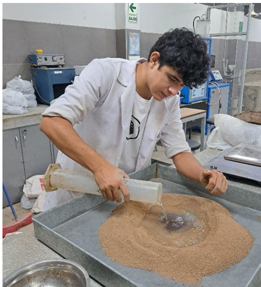
Figura 27: Ensayo de Proctor modificado: saturación
