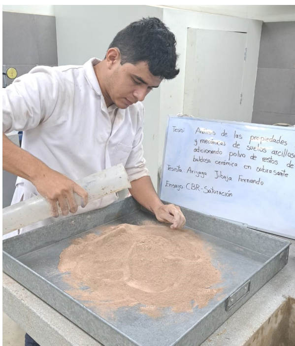
Figura 37: Saturación de muestra para CBR con adición
