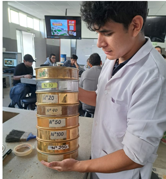
Figura 22: Tamices usados para realizar el ensayo de granulometría
