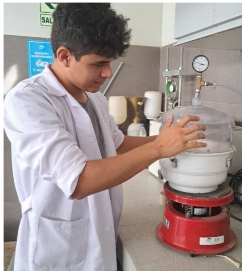
Figura 25: Fiola en la bomba de vacío para eliminar los vacíos de cada calicata
