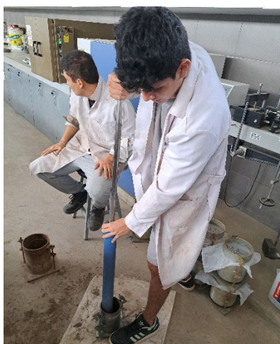
Figura 28: Ensayo de Proctor modificado: compactación
