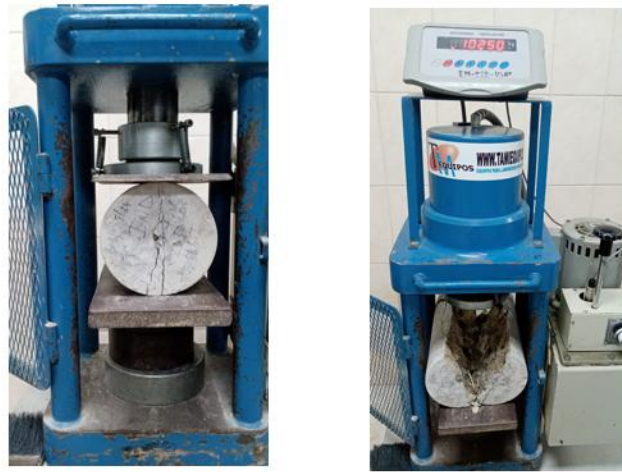
Ilustración 24: Rotura de probeta N°03 por el ensayo de Tracción indirecta a los 28 días.
