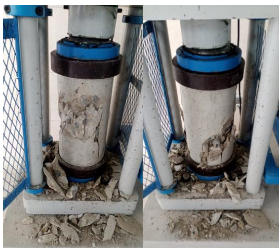
Ilustración 31: Rotura de espécimen por el ensayo de compresión a los 7 días - M.P, se puede apreciar que el tipo de rotura sería el Tipo 2 por la presencia de fisuras a través de los cabezales.
