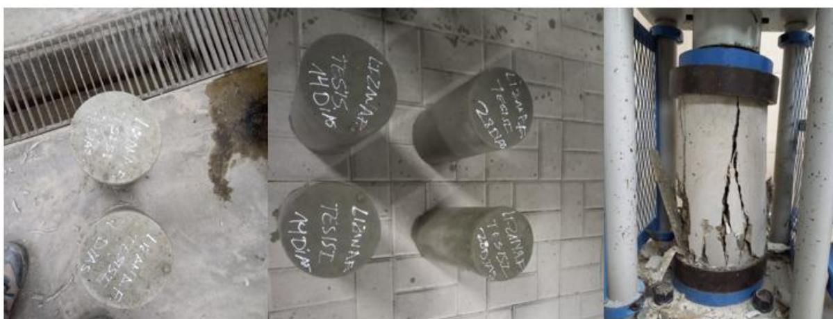
Ilustración 29: Especímenes y rotura a los 7, 14 y 28 días – M. Patrón
