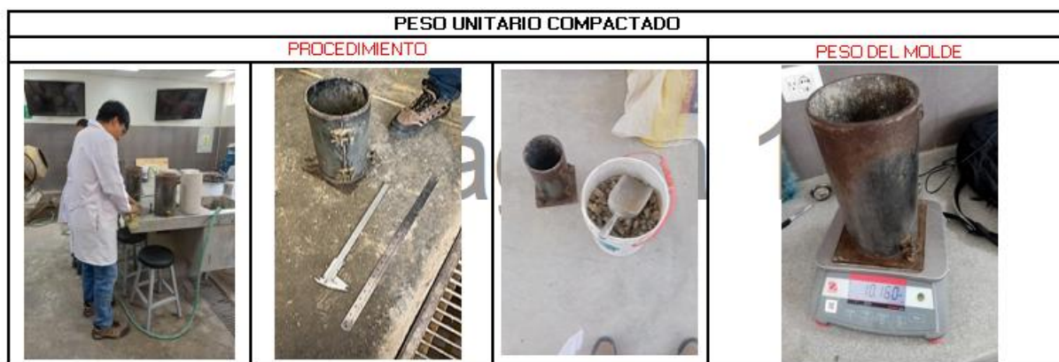
Ilustración 20: Pesado de molde y pesado de moldes con A.G. compactado
