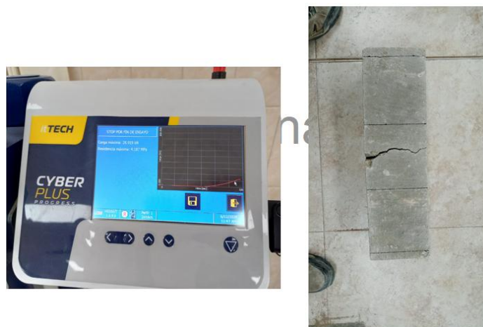
Ilustración 27: Rotura de la viga N°02 por el ensayo a flexión a los 28 días.
