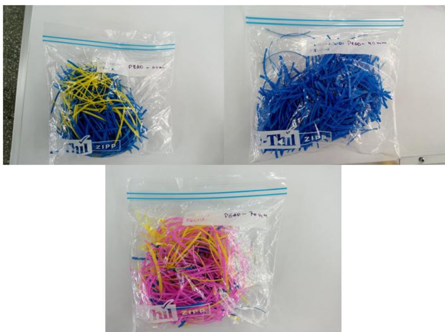
Ilustración 2: Fibra cortada y separada por longitudes
