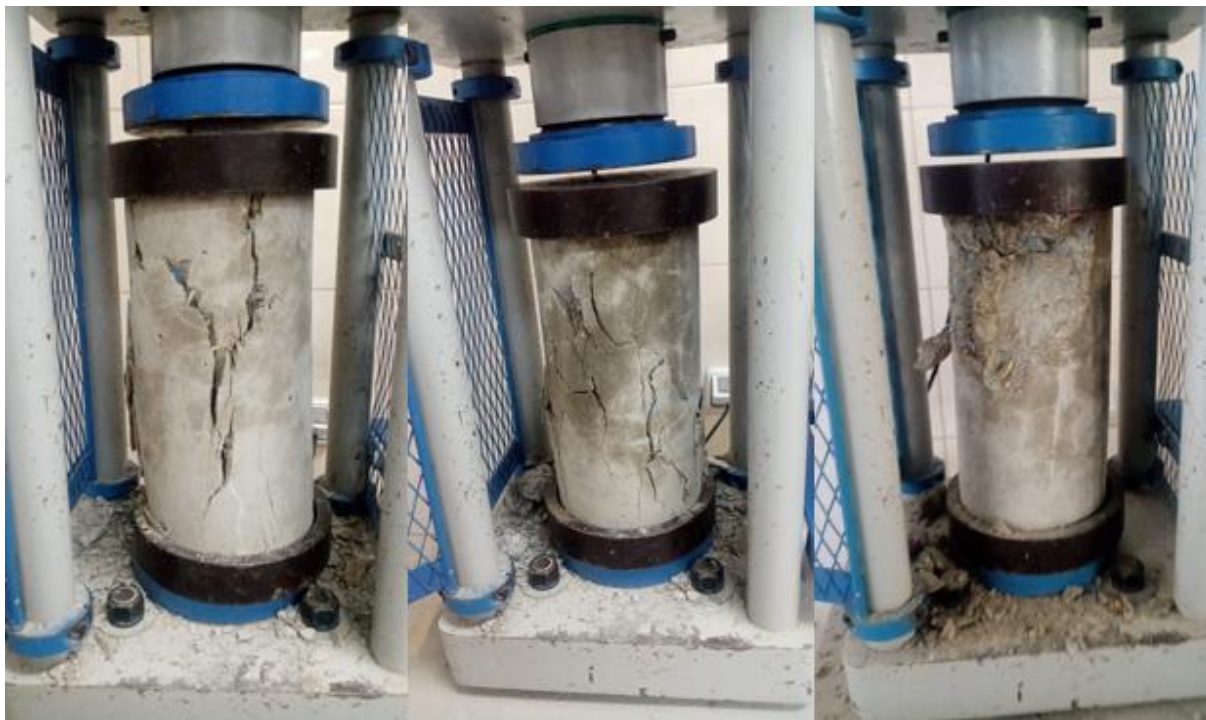
Ilustración 34: Rotura de especímenes el ensayo de compresión a los 07 días – 0.60%, se puede apreciar que el tipo de rotura sería el Tipo 2 por la presencia de fisuras verticales a través de los cabezales.
