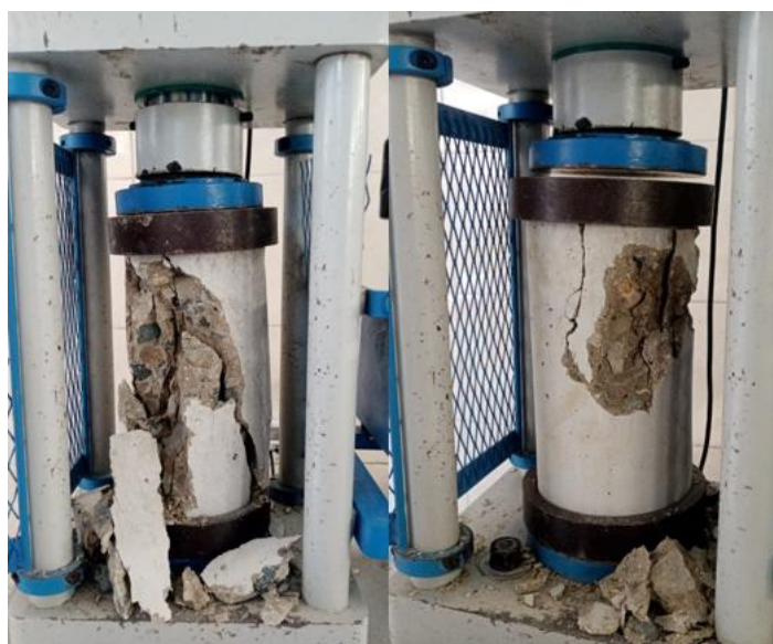
Ilustración 33: Rotura de espécimen por el ensayo de compresión a los 28 días – M.P, se puede apreciar que el tipo de rotura sería el Tipo 2 por la presencia de fisuras a través de los cabezales.
