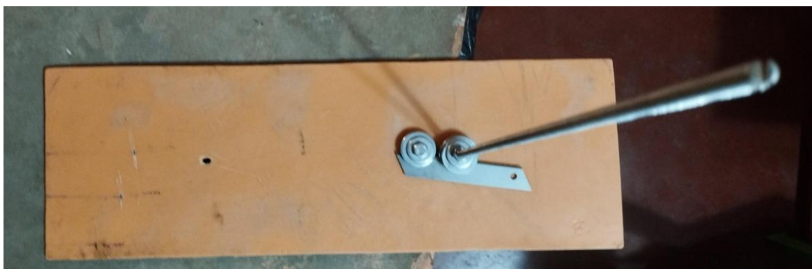
Ilustración 1: Maquina casera para cortar fibra
