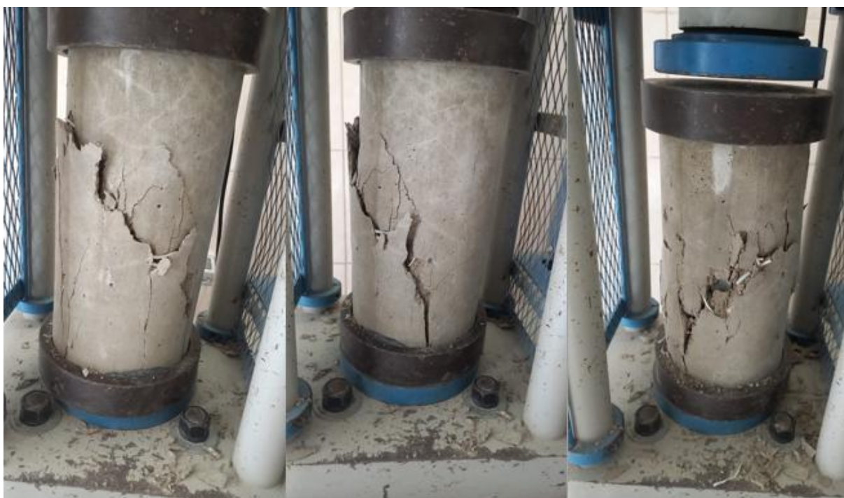
Ilustración 35: Rotura de espécimen por el ensayo de compresión a los 14 días – 0.60%, se puede apreciar que el tipo de rotura sería el Tipo 4 por la fractura diagonal sin fisuras a través de los extremos.
