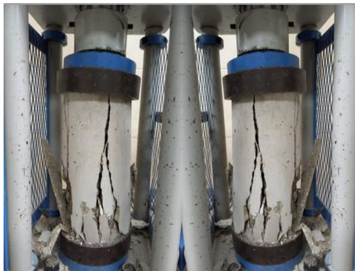
Ilustración 32: Rotura de espécimen por el ensayo de compresión a los 14 días - M.P, se puede apreciar que el tipo de rotura sería el Tipo 3 por la presencia de fisuras verticales a través de ambos extremos.
