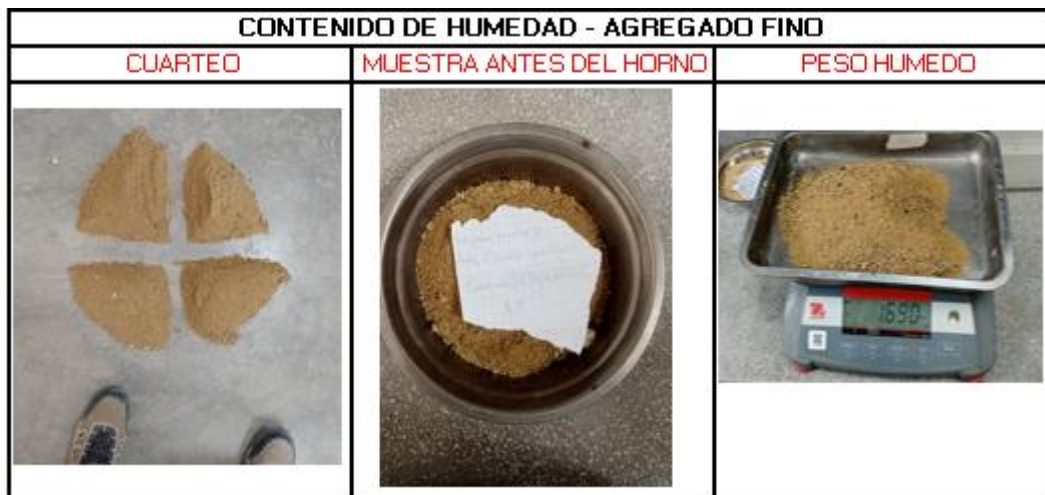
Ilustración 13: Cuarteo, pesado y colocación en el horno
