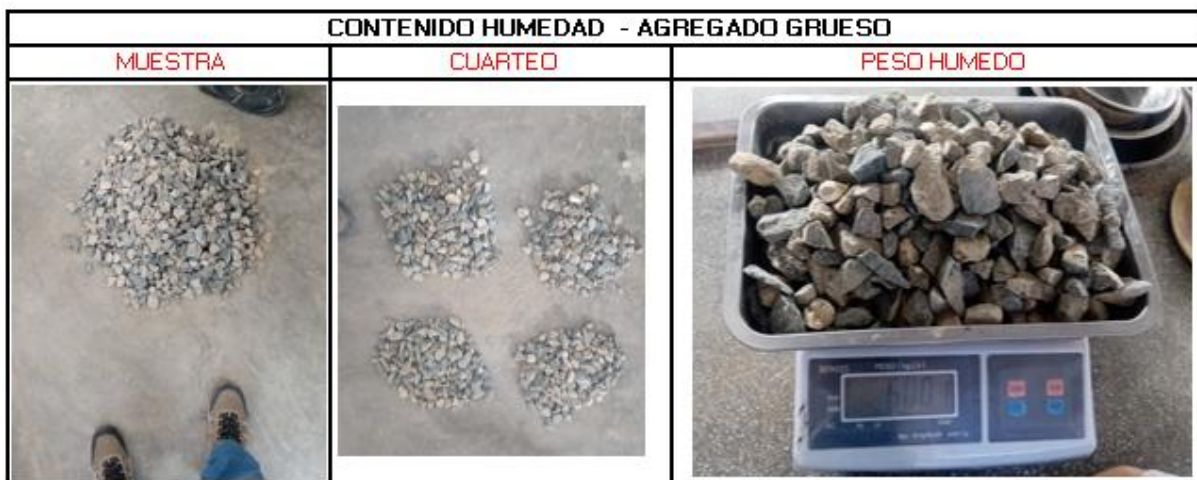
Ilustración 14: Cuarteo y pesado de la piedra chancada
