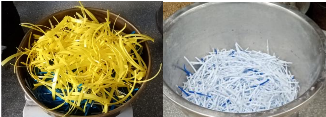
Ilustración 10: Fibra lista para ser mezclada con el concreto
