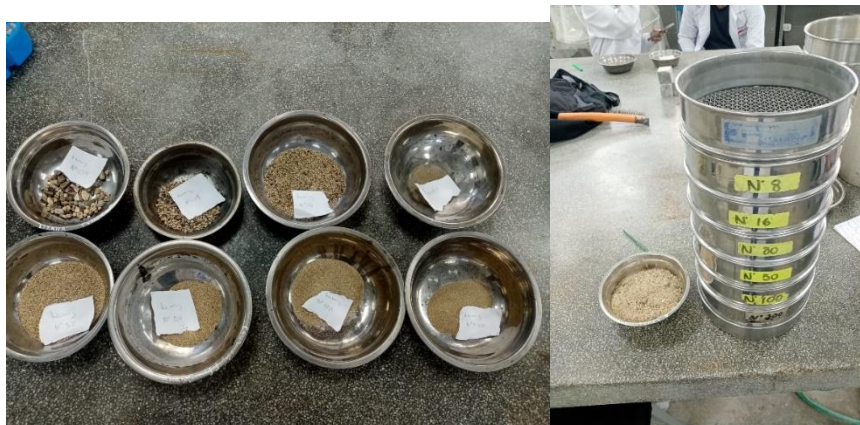
Ilustración 11: Granulometría A.F. tamizado y pesado de lo retenido
