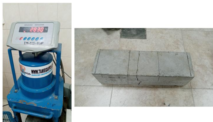
Ilustración 28: Rotura de la viga N°03 por el ensayo a flexión a los 28 días.
