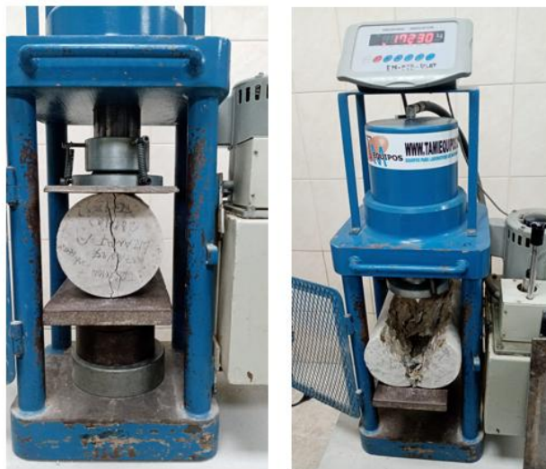
Ilustración 22: Rotura de probeta N°01 por el ensayo de Tracción indirecta a los 28 días.
