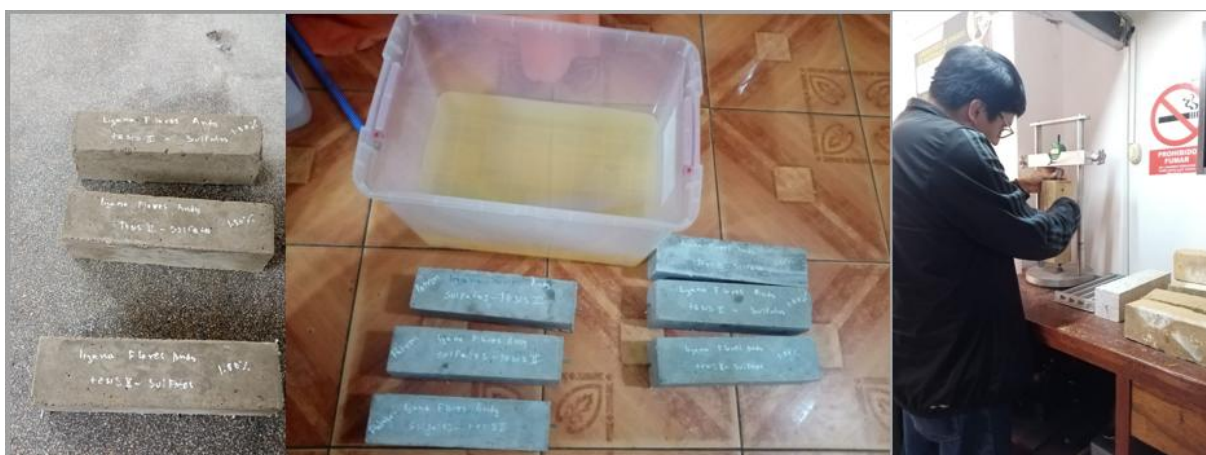
Ilustración 38: Especímenes luego del curado en sulfato
