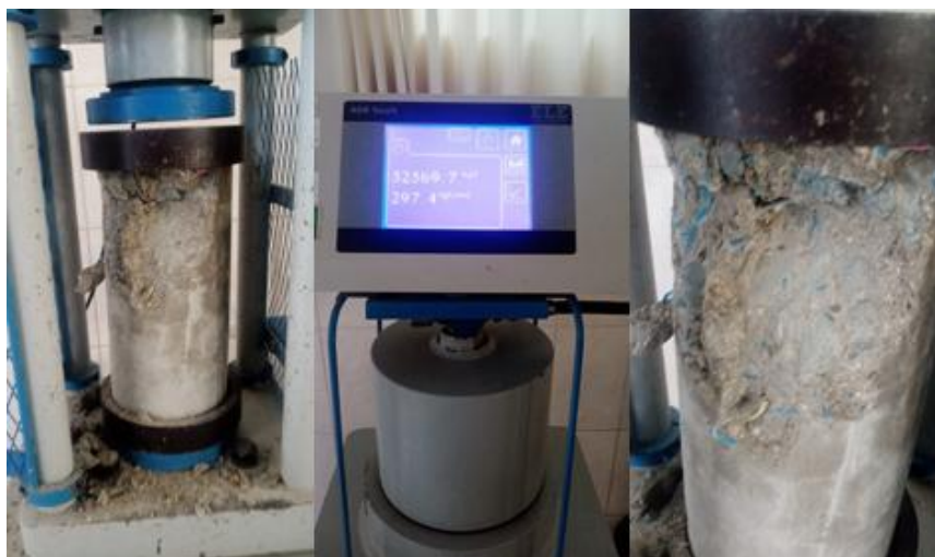
Ilustración 30: Rotura de especímenes a los 7 y 14 días - 0.60% PEAD
