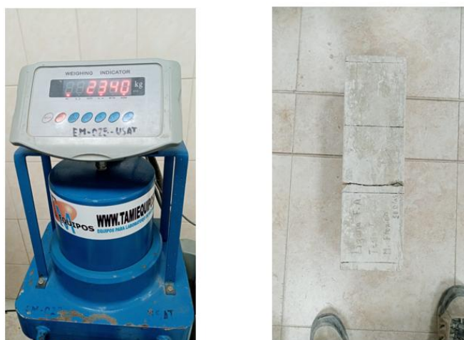
Ilustración 26: Rotura de la viga N°01 por el ensayo a flexión a los 28 días.
