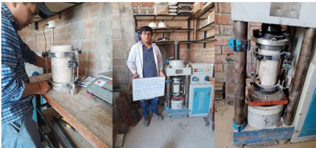
Ilustración 36: Especímenes y rotura a los 28 días – M. Patrón
