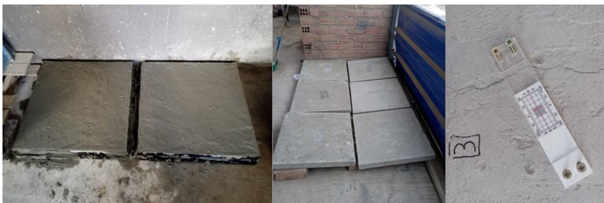
Ilustración 41: especímenes y aparición de fisuras
