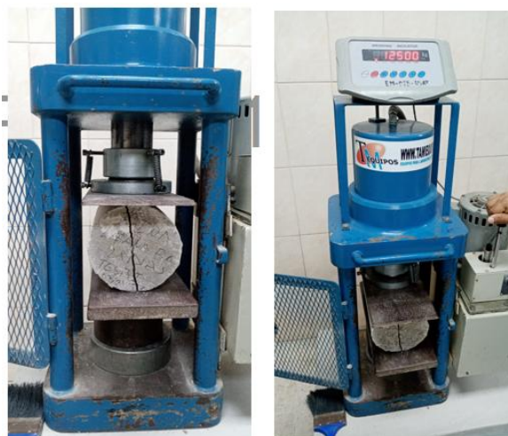
Ilustración 22: Rotura de probeta N°01 por el ensayo de Tracción indirecta a los 28 días.
