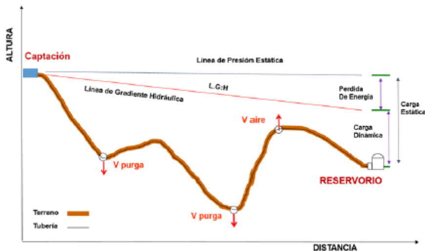
Ilustración 1. Línea de Conducción [15]
