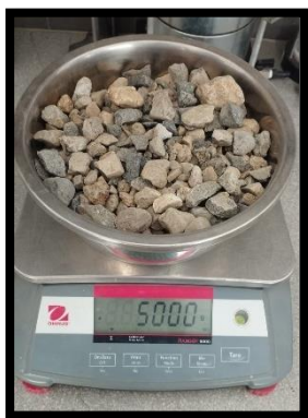
Figura N°16: Peso de la muestra húmeda + tara.
