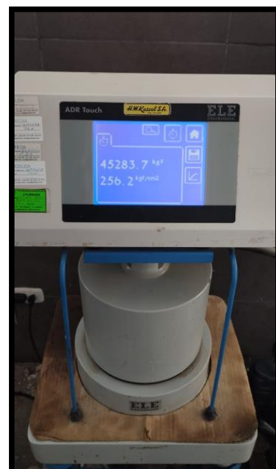
Anexo 17.6: Concreto patrón – 28 días – expuesto al fuego 60 min
