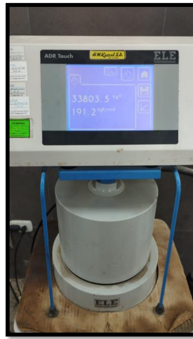
Anexo 17.24: Concreto 20% A.E– 28 días – expuesto al fuego 60 min
