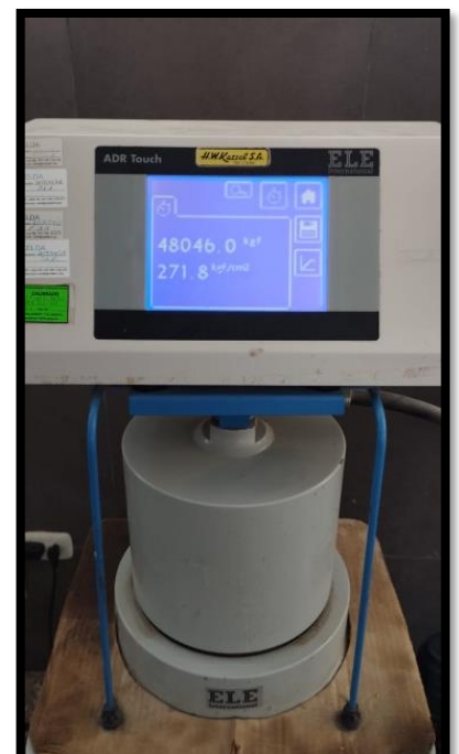
Anexo 17.12: Concreto 10% A.E – 28 días – expuesto al fuego 60 min
