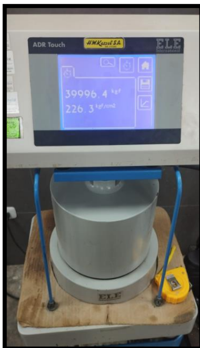
Anexo 17.10: Concreto 10% A.E – 14 días – expuesto al fuego 60 min
