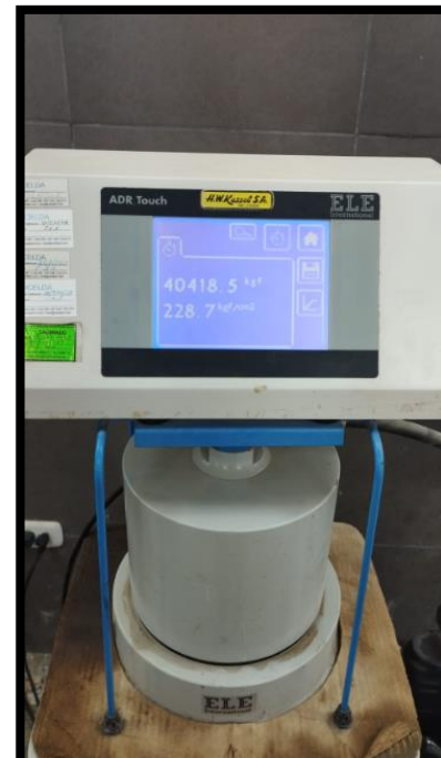
Anexo 17.18: Concreto 15% A.E– 28 días – expuesto al fuego 60 min
