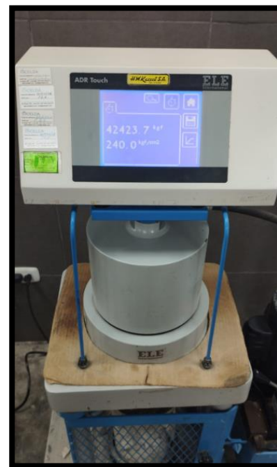
Anexo 17.3: Concreto patrón – 14 días – expuesto al fuego 30 min
