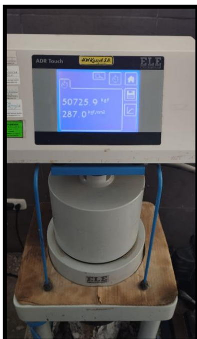
Anexo 17.5: Concreto patrón – 28 días – expuesto al fuego 30 min
