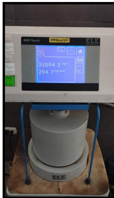
Anexo 17.11: Concreto 10% A.E – 28 días – expuesto al fuego 30 min
