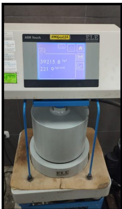
Anexo 17.4: Concreto patrón – 14 días – expuesto al fuego 60 min
