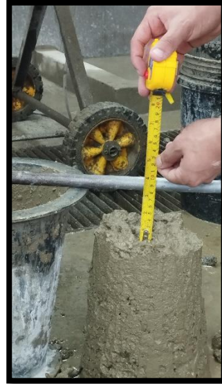
Anexo 12.2: Slump 3.25" – 10% Arcilla Expandida
