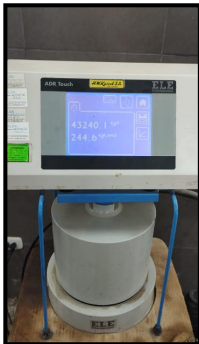
Anexo 17.17: Concreto 15% A.E– 28 días – expuesto al fuego 30 min
