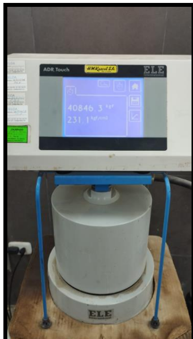
Anexo 17.23: Concreto 20% A.E– 28 días – expuesto al fuego 30 min
