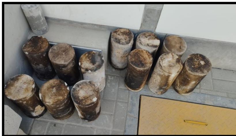
Figura 71: Cambio de color del concreto.
