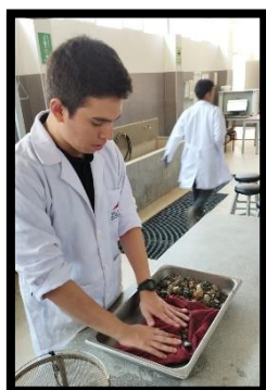
Figura N°24: Eliminación del agua de la superficie de la piedra.
