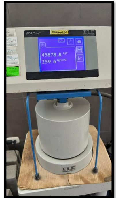
Anexo 17.9: Concreto 10% A.E – 14 días – expuesto al fuego 30 min
