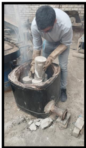
Figura N°28 y 29: Colocación de las muestras dentro del horno.
