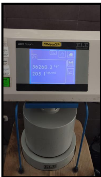
Anexo 17.22: Concreto 20% A.E – 14 días – expuesto al fuego 60 min
