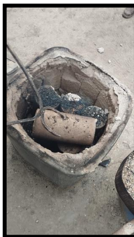
Figura N°31: Retiro de las muestras quemadas con ayuda de una pinza.
