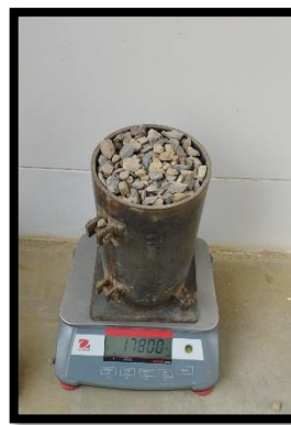
Figura N°19: Peso unitario suelto húmedo 2 del agregado grueso.
