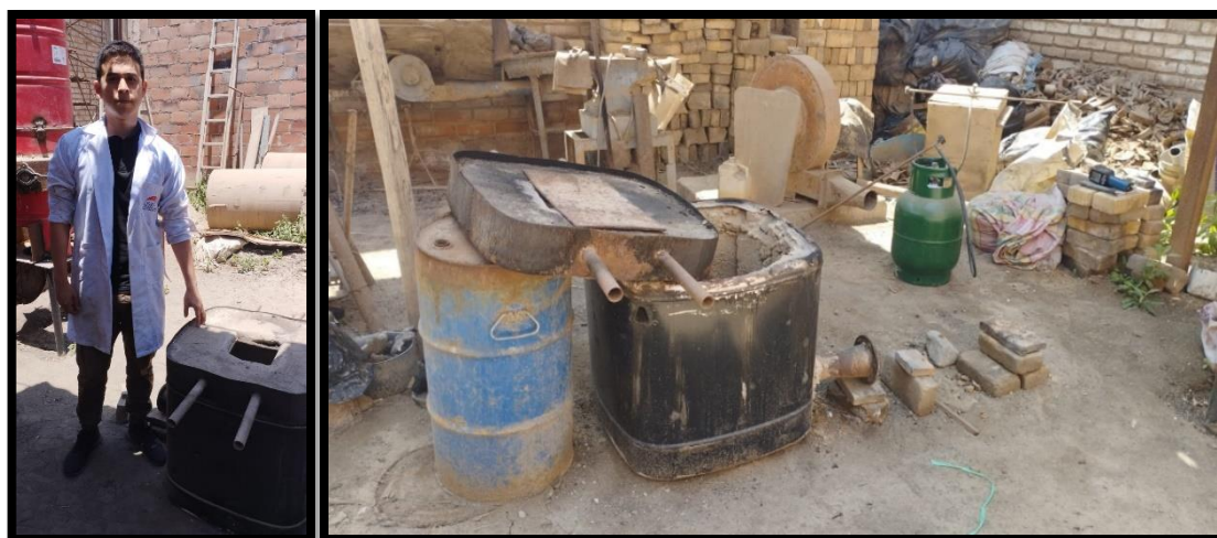
Figura N°26 y 27: Horno artesanal donde las muestras serán expuestas al fuego.
