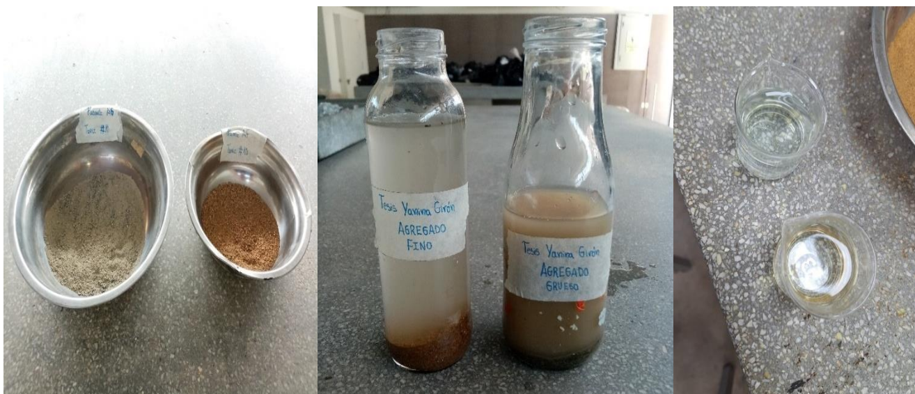
FIGURA 06: Ensayo de Sales solubles totales
