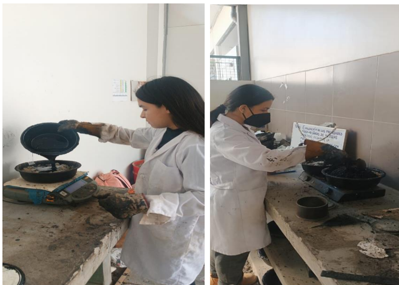
FIGURA 13: Preparación de la mezcla asfáltica
