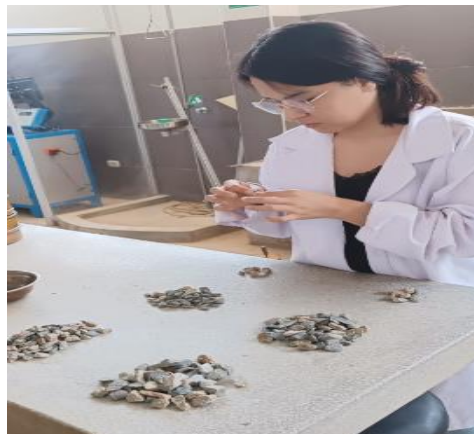
FIGURA 05. Ensayo de Caras Fracturadas
