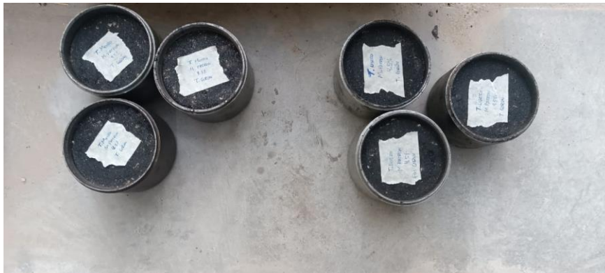
FIGURA 14: Utilización de moldes para la elaboración de briquetas
