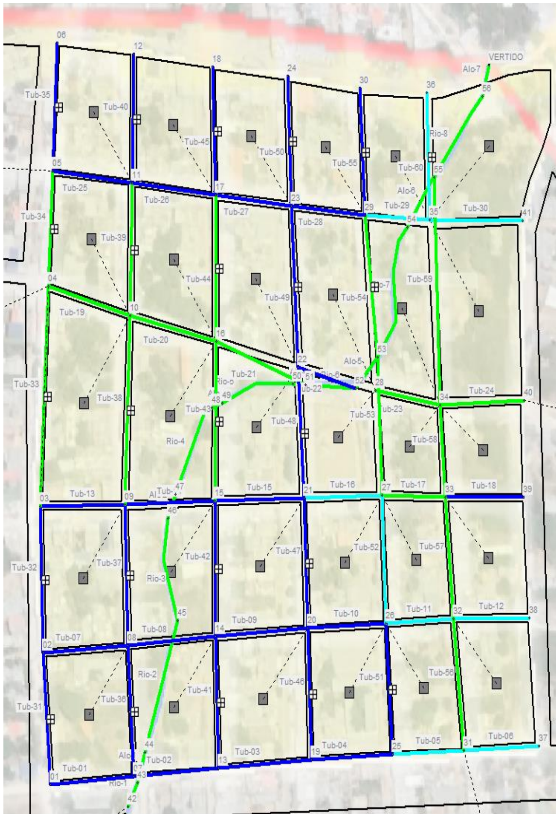
Ilustración 107 Detalle de colocación de obras de drenaje en el área de estudio. Fuente: SWMM, Elaboración propia.
