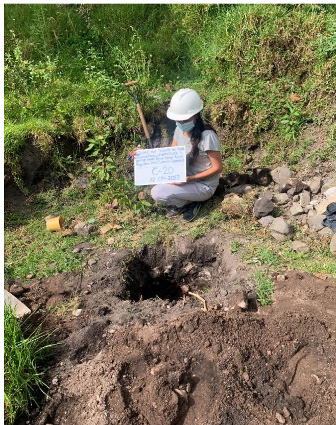
Figura 37: Extracción de muestra - Calicata 20
