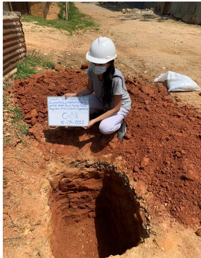
Figura 35: Extracción de muestra - Calicata 08
