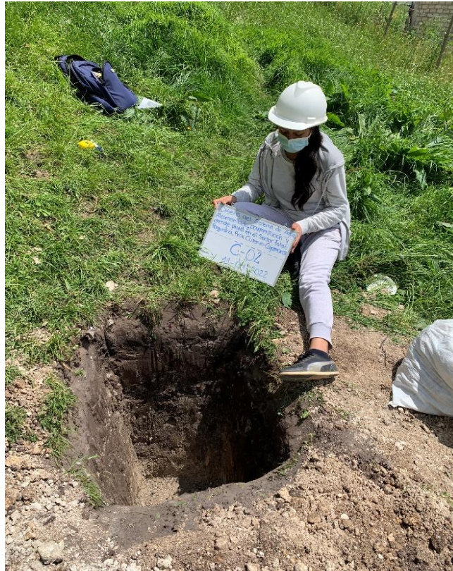
Figura 34: Extracción de muestra - Calicata 02
