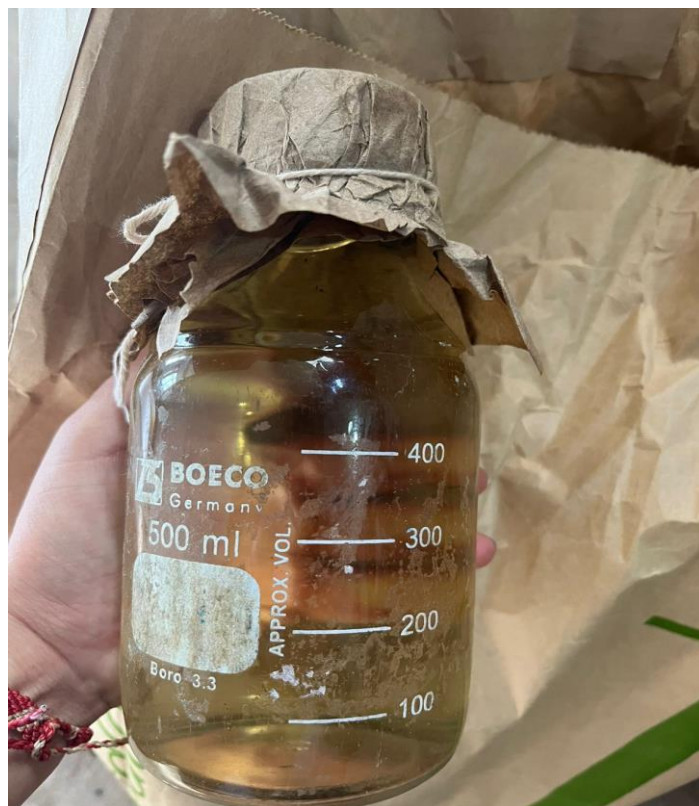
Figura 44: Toma de muestra de agua para ensayo químico – físico
