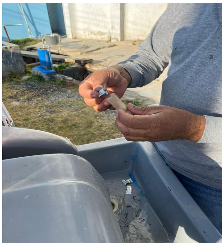
Figura 44: Prueba de cloro In situ con pastillas Dpd
