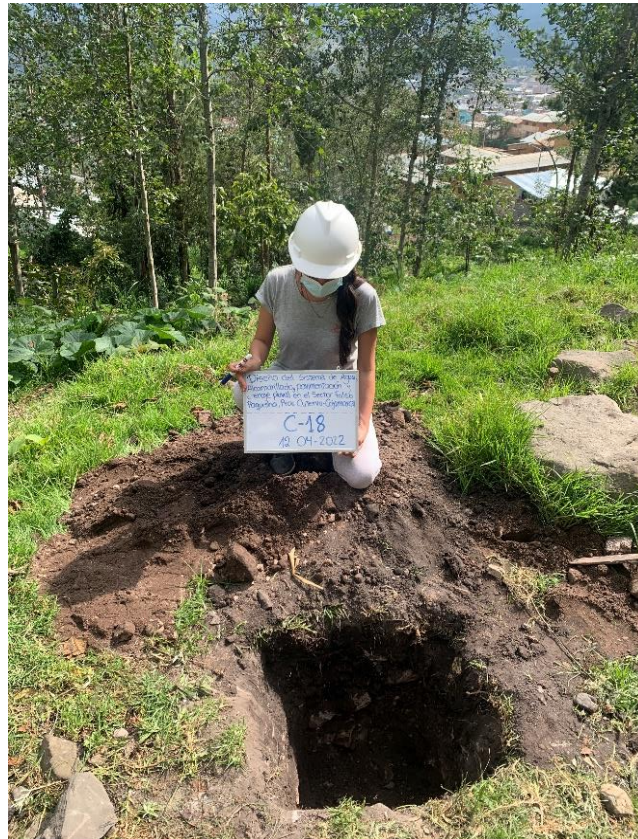
Figura 36: Extracción de muestra - Calicata 18
