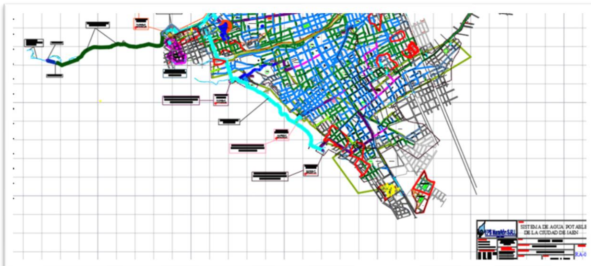
Ilustración 54: Plano de la red de agua de Jaén
