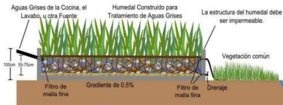
Figura 6. Un sistema subterráneo típico de humedales construidos.
