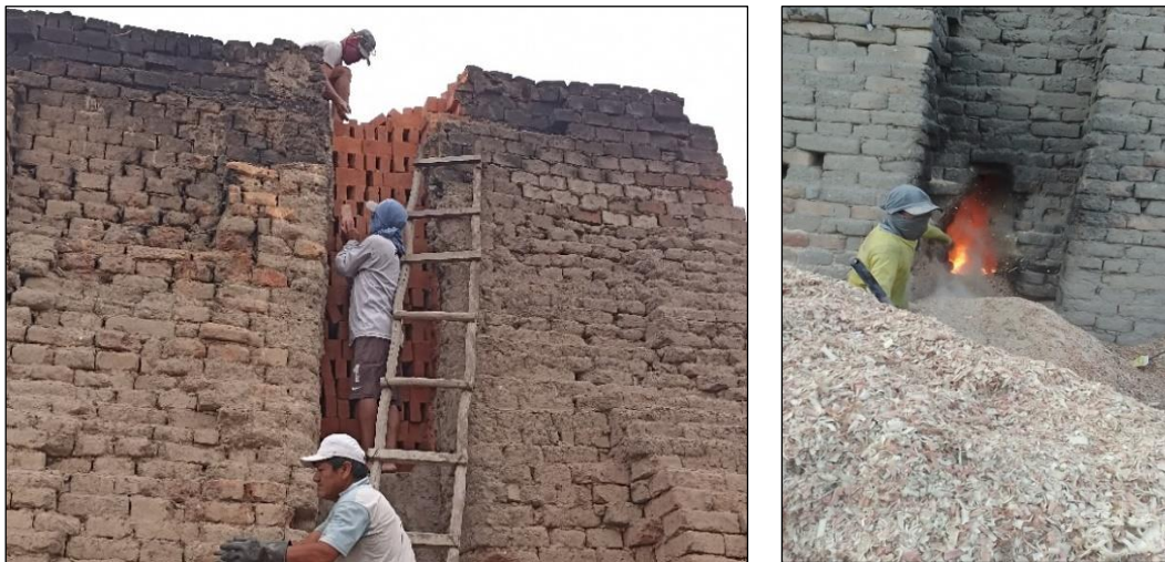
Ilustración 23: Quemado de ladrillos en el horno
