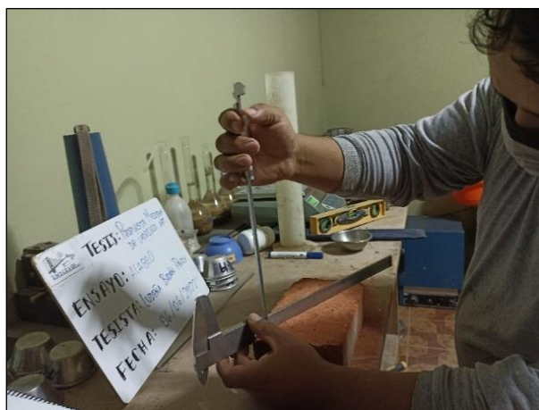
Ilustración 13: Medida de alabeo en ladrillos
