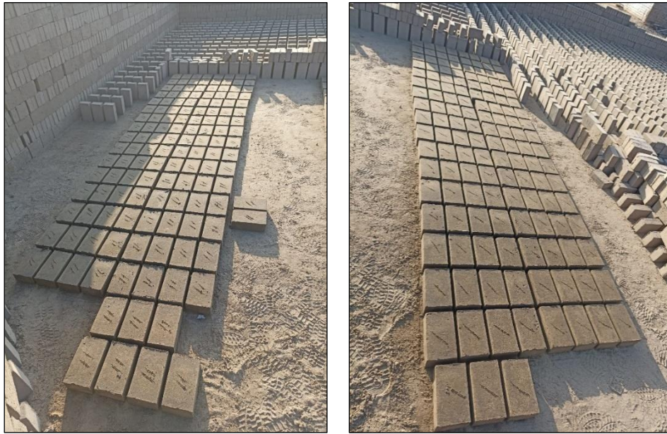
Ilustración 21: Codificar Ladrillos con 10% de Adición de Viruta de Acero
