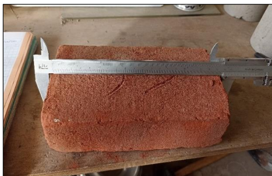
Ilustración 11: Dimensiones de un ladrillo artesanal
