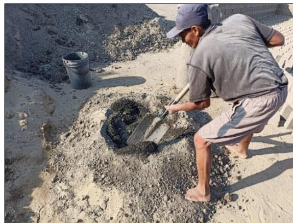
Ilustración 18: Adicionar 08% de viruta a la mezcla para el ladrillo
