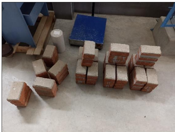
Ilustración 5: Muestras a ensayar de pilas de albañilería
