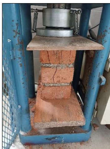
Ilustración 6: Resultado de ensayo a compresión axial en prismas
