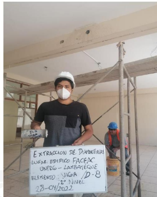
FOTO 09 Y 10: EXTRACCIÓN DE DIAMANTINA DE VIGA
