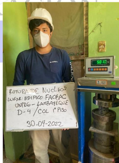
FOTO 14 Y 15: ENSAYO A LA COMPRESIÓN DE TESTIGOS DE DIAMANTINA – PRIMER PISO
