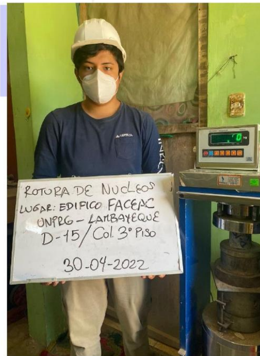
FOTO 18 Y 19: ENSAYO A LA COMPRESIÓN DE TESTIGOS DE DIAMANTINA – TERCER PISO
