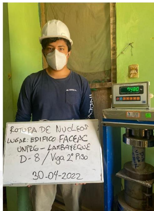
FOTO 16 Y 17: ENSAYO A LA COMPRESIÓN DE TESTIGOS DE DIAMANTINA – SEGUNDO PISO
