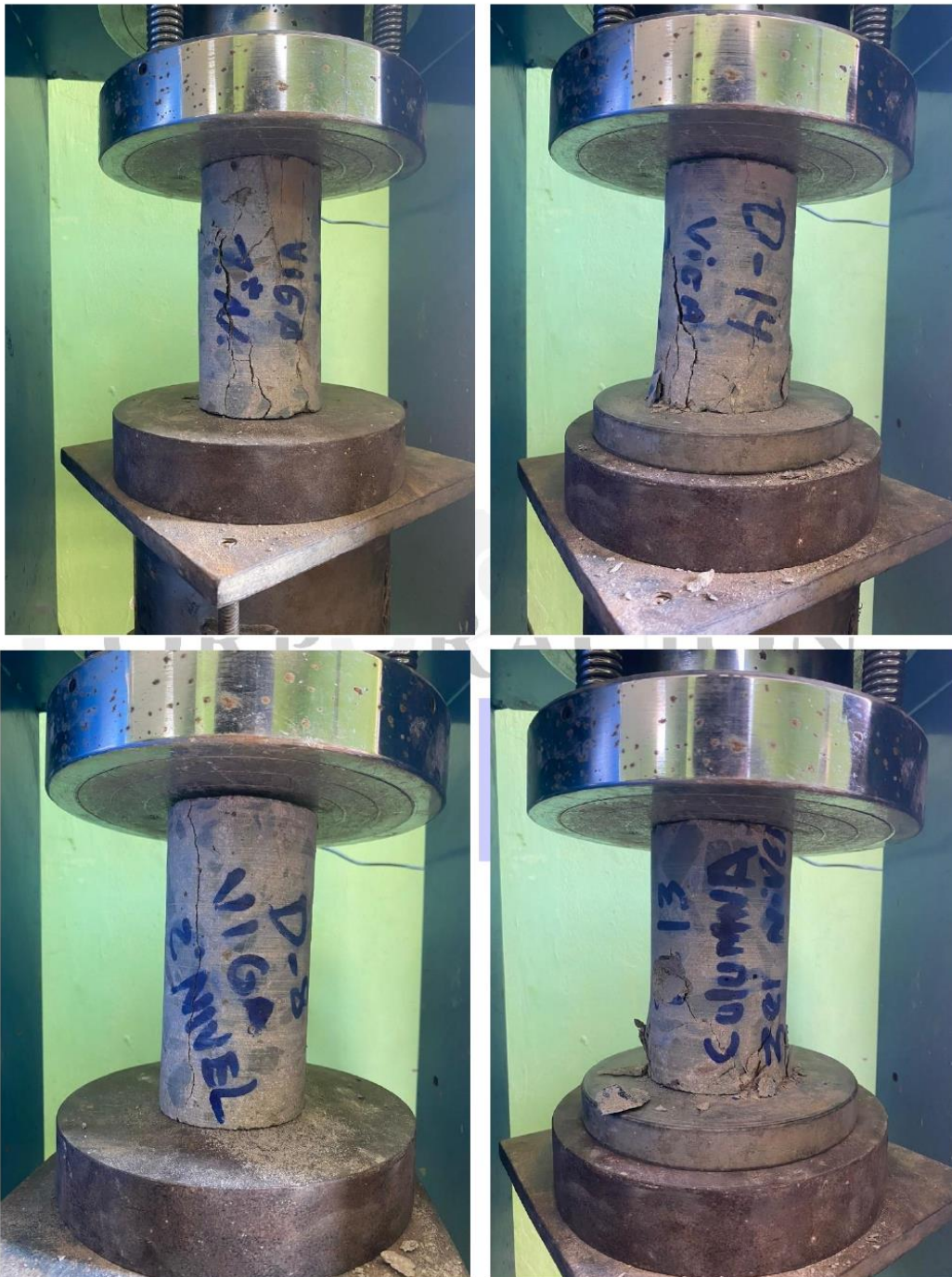
FOTO 24, 25, 26 Y 27: PUNTO DE FALLA EN TESTIGOS DE DIAMANTINA BAJO CARGAS DE COMPRESIÓN.
