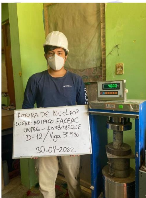
FOTO 18 Y 19: ENSAYO A LA COMPRESIÓN DE TESTIGOS DE DIAMANTINA – TERCER PISO
