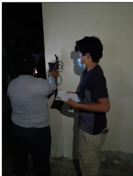
ANEXO 5- Escaneo en campo de ubicación de Aceros
