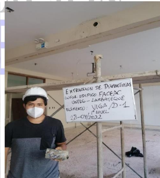
FOTO 03 Y 04: EXTRACCIÓN DE DIAMANTINA DE VIGA PARA LUEGO SER ENSAYADA EN LABORATORIO.
