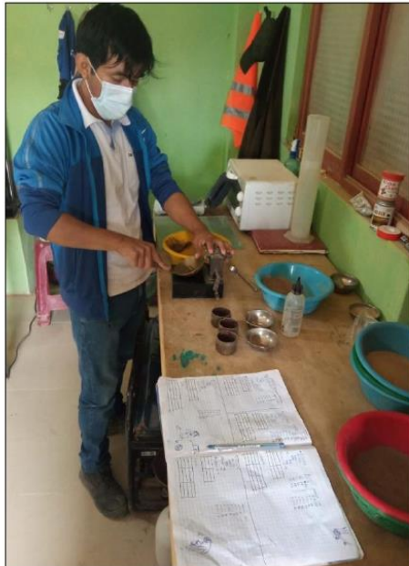
FOTO 04: ENSAYO DE LIMITES DE ATTERBERG (LÍMITE LÍQUIDO)
