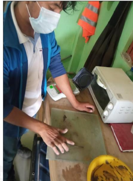
FOTO 05: ENSAYO DE LIMITES DE ATTERBERG (LÍMITE PLÁSTICO)
