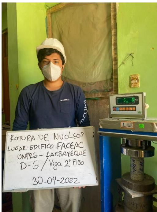
FOTO 16 Y 17: ENSAYO A LA COMPRESIÓN DE TESTIGOS DE DIAMANTINA – SEGUNDO PISO
