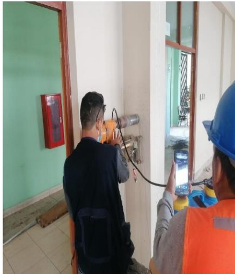
FOTO 05 Y 06: EXTRACCIÓN DE DIAMANTINA DE COLUMNA PARA LUEGO SER ENSAYADA EN LABORATORIO.
