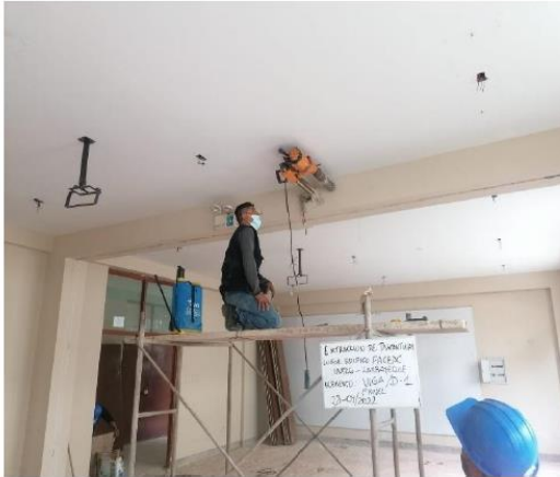
FOTO 01 Y 02: FIJACIÓN DEL EQUIPO SACATESTIGOS EN VIGA UTILIZANDO UN SISTEMA DE ANCLAJE, E IDENTIFICACIÓN DEL ACERO DE REFUERZO.
