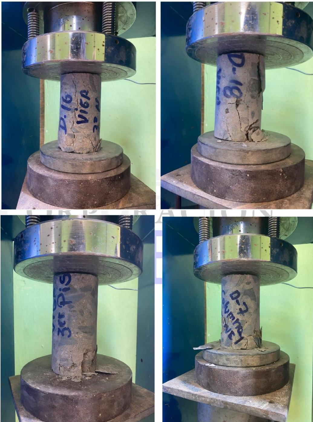
FOTO 20, 21, 22 Y 23: PUNTO DE FALLA EN TESTIGOS DE DIAMANTINA BAJO CARGAS DE COMPRESIÓN.
