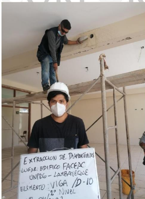
FOTO 11 Y 12: EXTRACCIÓN DE DIAMANTINA DE VIGA
