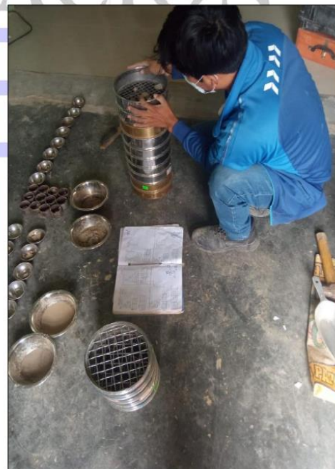
FOTO 07: ANALISIS GRANULOMÉTRICO POR TAMIZADO.
