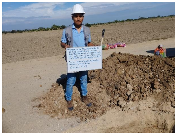
Ilustración 10: Calicata N°2 – extracción de muestra
