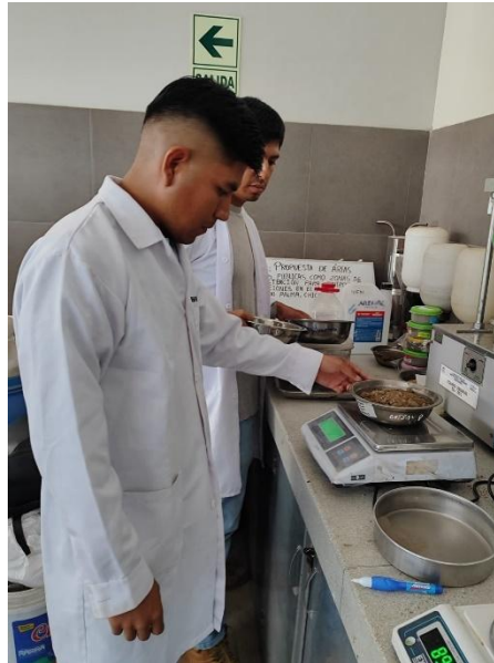
Figura 47: Ensayo de contenido de humedad
