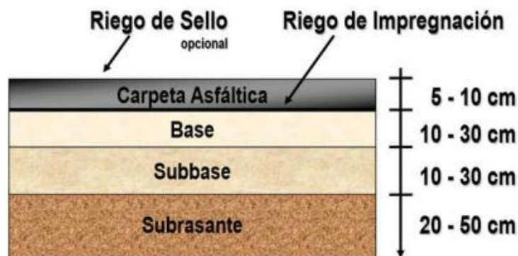
Ilustración 1: Estructura de un pavimento
