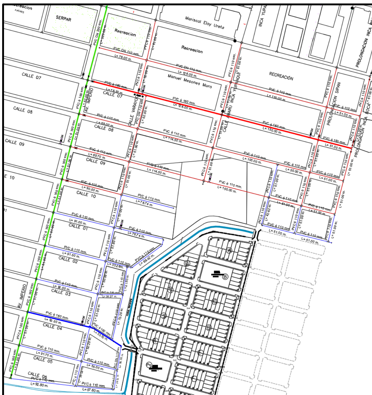
Ilustración 71 Red existente y proyectada de agua potable en la zona del proyecto
