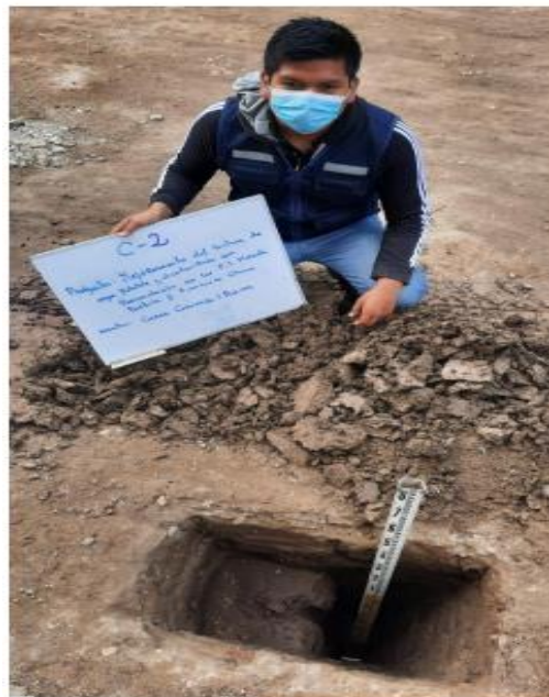
Foto 1: De excavación de calicata 02; en Tupac Amaru y Atuspareas
