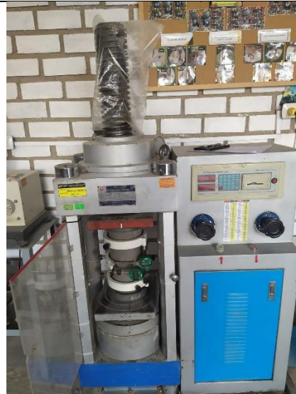
Imagen N° 111: Colocación de la muestra en la prensa para la toma de datos de la deformación y hasta llegar al 40% de la carga máxima.
