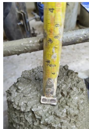
Figura N° 11: Slump 4'' - f'c 280 - a/c 0.46 - 100%AR - 0.05%NG.
