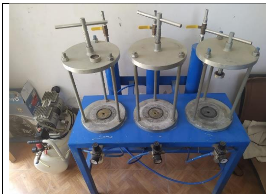
Imagen N° 96: Equipo de ensayo de permeabilidad por penetración del agua bajo presión.
