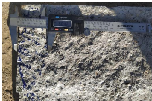
Figura N° 112: P01d - f'c 280 - a/c 0.53 - 100%AR - 0.15%NG.
