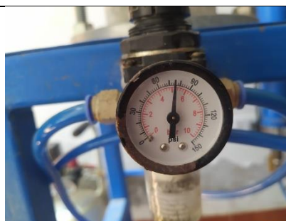
Imagen N° 100: Fijación de la presión a 72 psi.
