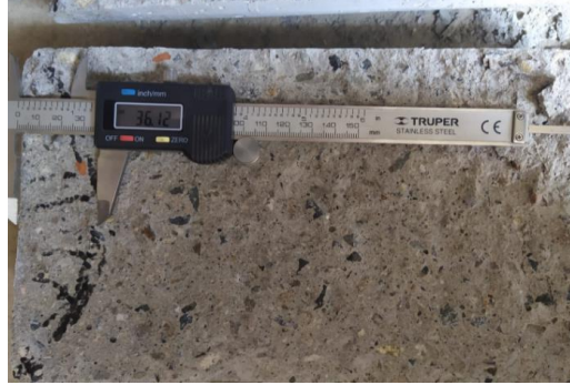
Figura N° 98: P01d - f'c 280 - a/c 0.46 - 100%AR - 0%NG.
