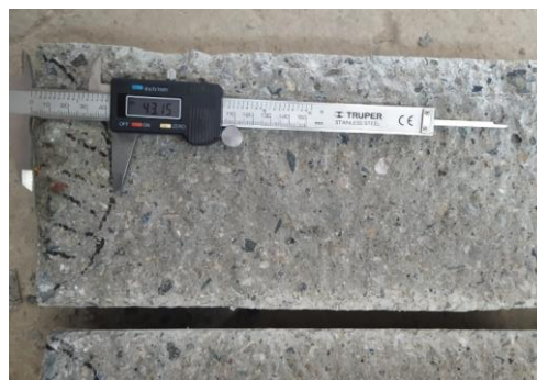
Figura N° 110: P01d - f'c 280 - a/c 0.53 - 100%AR - 0.10%NG.
