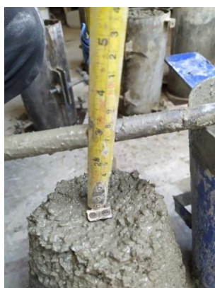
Figura N° 15: Slump 4'' - f'c 280 - a/c 0.53 - 100%AR - 0%NG.
