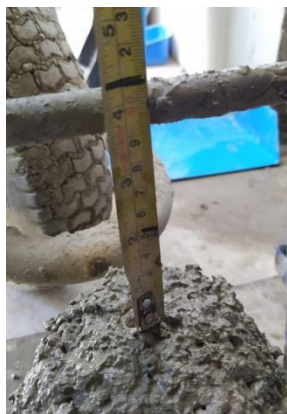
Figura N° 10: Slump 2.5'' - f'c 280 - a/c 0.46 - 100%AR - 0%NG.
