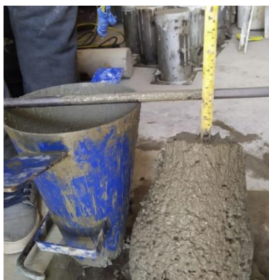
Figura N° 13: Slump 3'' - f'c 280 - a/c 0.46 - 100%AR - 0.15%NG.
