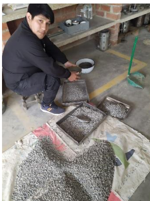
Imagen N° 12: Cuarteo del agregado reciclado
