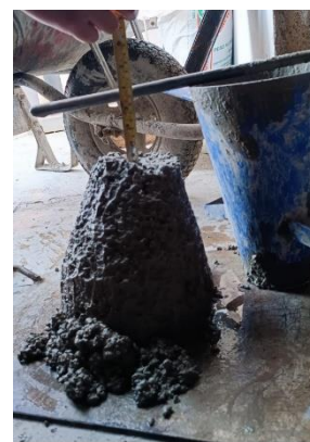
Figura N° 17: Slump 4'' - f'c 280 - a/c 0.53 - 100%AR - 0.10%NG.
