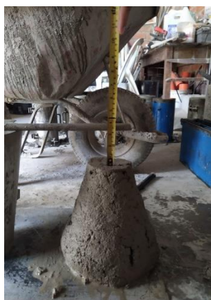
Figura N° 9: Slump 3.5'' - f'c 280 - a/c 0.46 - 0%AR - 0%NG.
