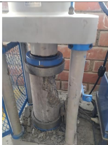
Imagen N° 109: Rotura de la muestra para determinar su resistencia máxima a la compresión
