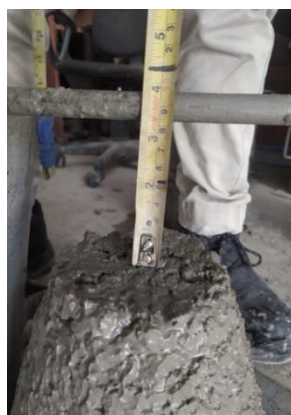
Figura N° 16: Slump 4'' - f'c 280 - a/c 0.53 - 0%AR - 0.05%NG.
