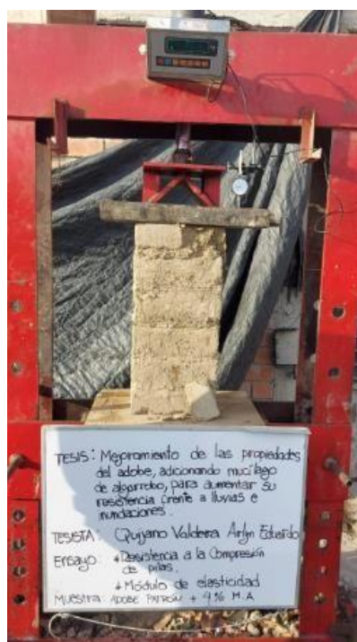
Figura 13. Ensayo de Resistencia a la compresión de pilas de Adobe + 4% Mucílago de Algarrobo
