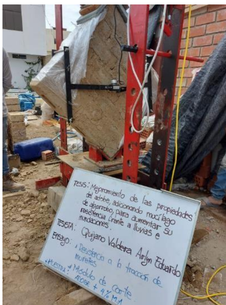
Figura 17. Ensayo de Resistencia a la tracción de muretes de Adobe + 4% Mucílago de Algarrobo
