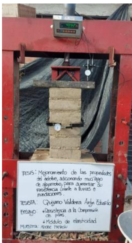
Figura 11. Ensayo de Resistencia a la compresión de pilas de Adobe Patrón
