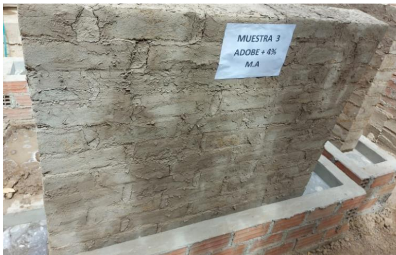
Figura 24. Ensayo de Inundación simulada de Adobe + 4% Mucílago de Algarrobo Fuente: Elaboración propia
