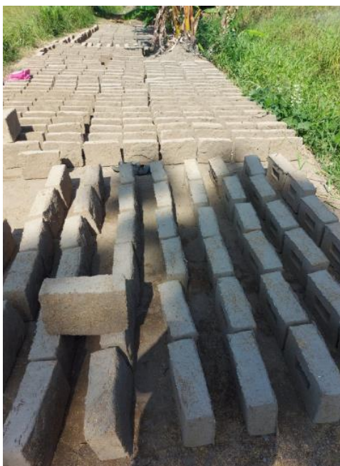
Figura 31. Secado de adobe a la intemperie
