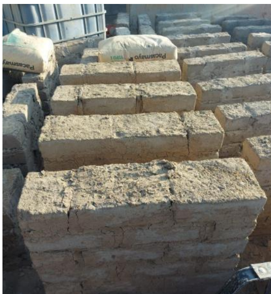
Figura 15. Elaboración de muretes
