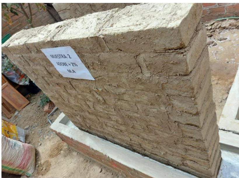
Figura 23. Ensayo de Inundación simulada de Adobe + 2% Mucílago de Algarrobo
