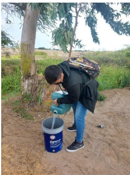
Figura 28. Proceso de elaboración del adobe adicionando mucílago del algarrobo
