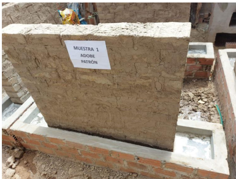
Figura 22. Ensayo de Inundación simulada de Adobe Patrón
