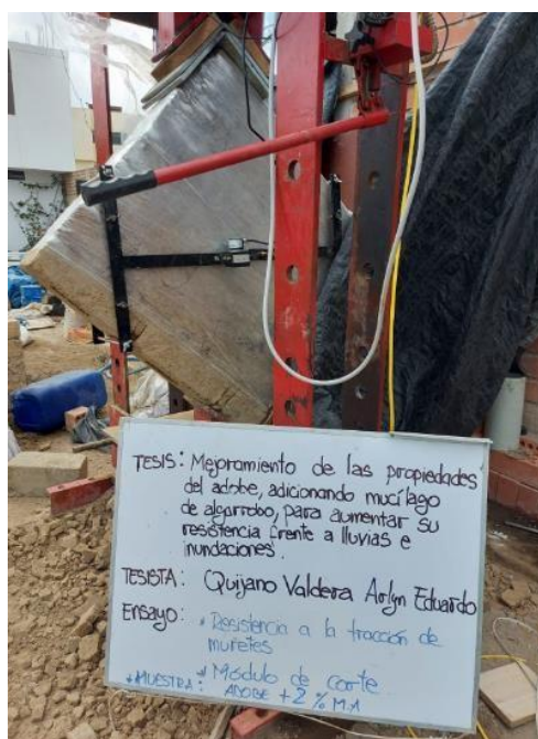
Figura 18. Ensayo de Resistencia a la tracción de muretes de Adobe + 2% Mucílago de Algarrobo
