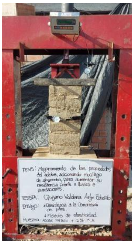
Figura 12. Ensayo de Resistencia a la compresión de pilas de Adobe + 2% Mucílago de Algarrobo
