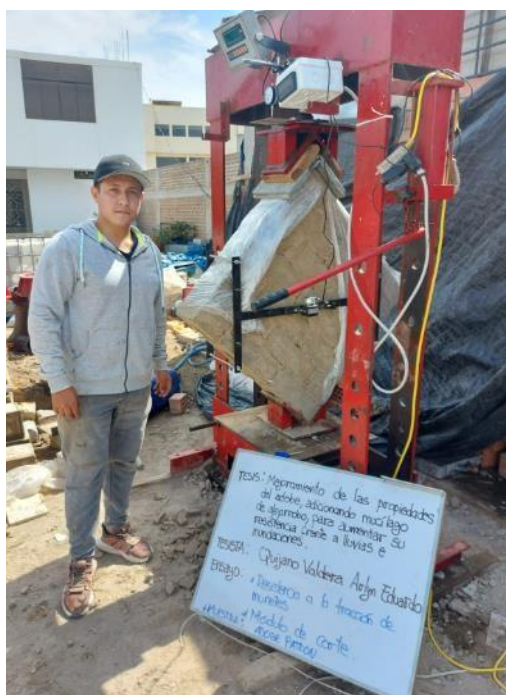
Figura 16. Ensayo de Resistencia a la tracción de muretes de Adobe Patrón
