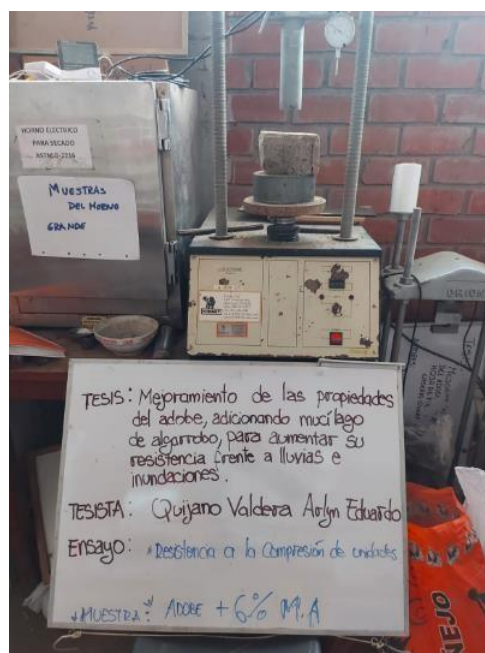
Figura 9. Ensayo de Resistencia a la compresión de unidades de Adobe + 6% M.A
