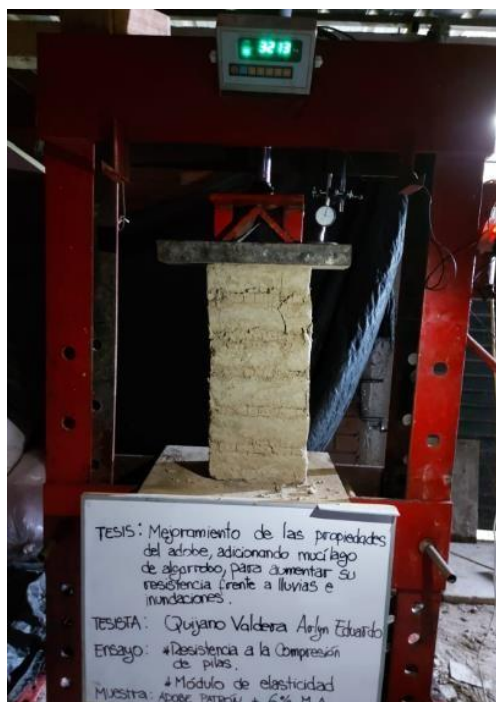
Figura 14. Ensayo de Resistencia a la compresión de pilas de Adobe + 6% Mucílago de Algarrobo
