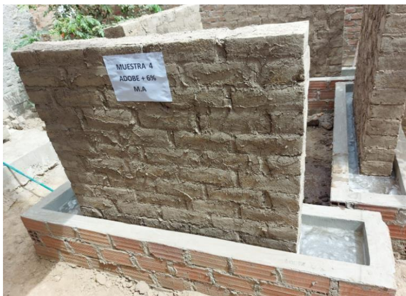
Figura 25. Ensayo de Inundación simulada de Adobe + 6% Mucílago de Algarrobo Fuente: Elaboración propia
