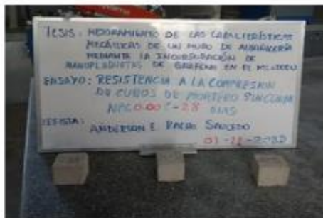
Imagen 47: Cubos de mortero patrón con 0.00% NPG sin curado
