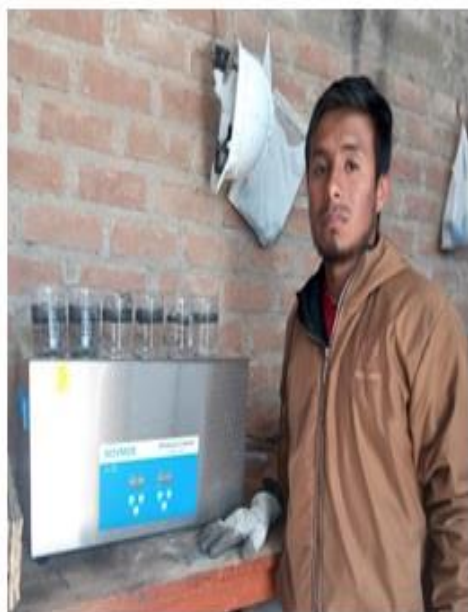
Imagen 55: Preparación de las NPG para La dispersión por ultrasonido
