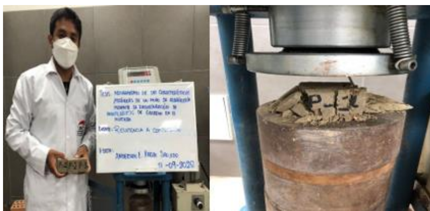
Imagen 27. Ensayo de resistencia de compresión de cubos de mortero patrón
