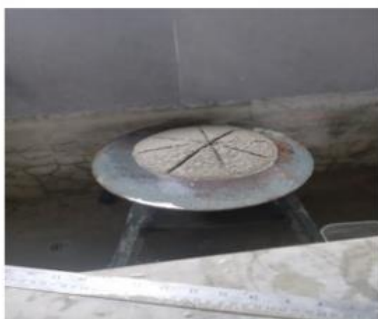
Imagen 33: Mortero en la mesa de fluidez
