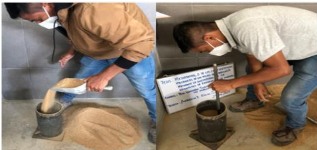
Imagen 14. Procedimiento del ensayo para calcular el PUC
