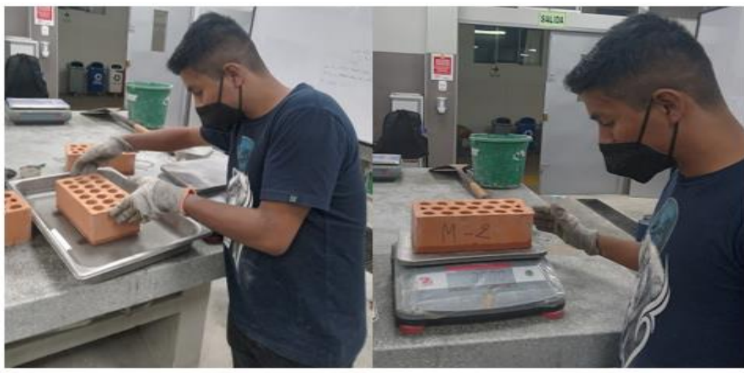
Imagen 20. Procedimiento para saber la capacidad de succión del ladrillo
