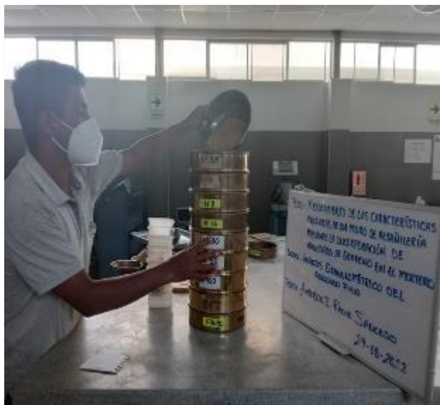
Imagen 11. Tesista realizando el tamizado mecánico del agregado fino
