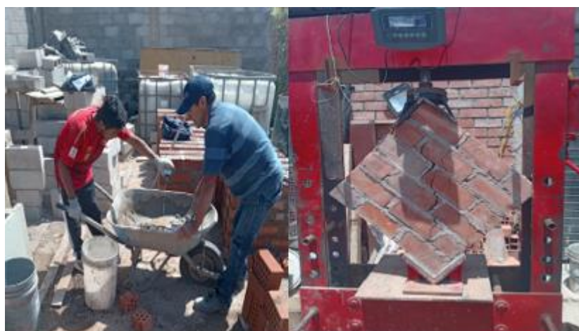
Imagen 30. Muestra de muretes para ser analizados a los 28 dias
