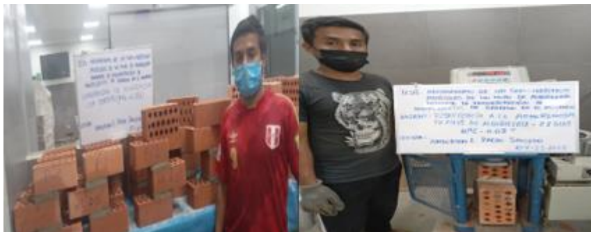
Imagen 29. Muestra de pilas para adherencia para ser analizados a los 28 dias
