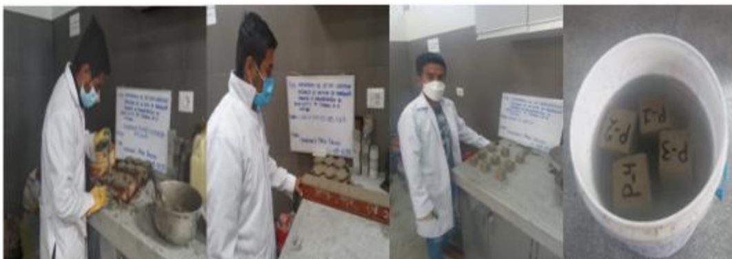
Imagen 26. Procedimiento de elaboración de cubos de mortero de aristas de 5cm
