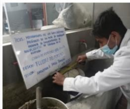
Imagen 34: Tesista realizando la medición del diámetro del mortero para calcular el porcentaje de fluidez.
