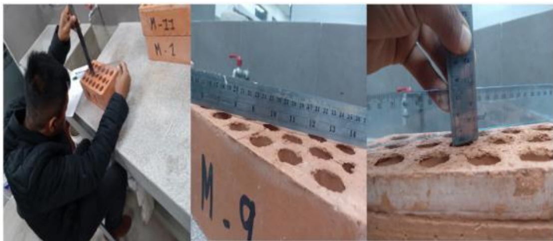
Imagen 18. Procedimiento de la obtención del alabeo del ladrillo
