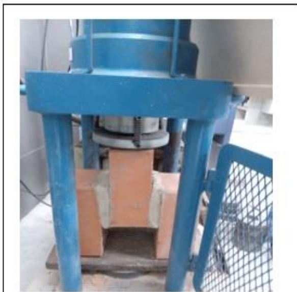
Imagen 63: Ensayo de resistencia a la adherencia a cizalle en pilas de albañilería con 0.03% NPG
