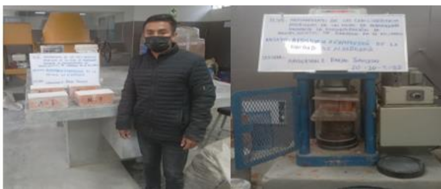
Imagen 22. Ensayo de resistencia a compresión del ladrillo King Kong de 30% de vacíos
