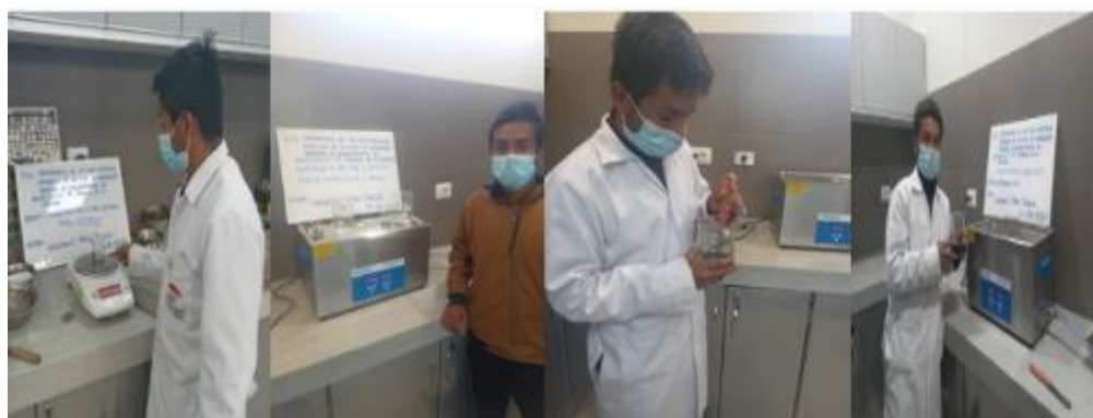
Imagen 10. Procedimiento de dispersión de NPG con la maquina ultrasónica
