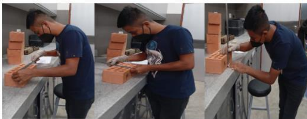
Imagen 17. Procedimiento de la obtención de las dimensiones del ladrillo
