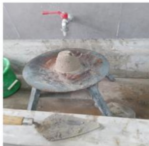
Imagen 32: Mortero listo para el ensayo de fluidez
