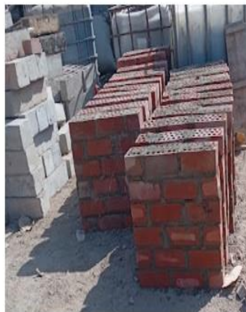
Imagen 58: Muestra de los muretes para ensayar a los 28 días de su elaboración
