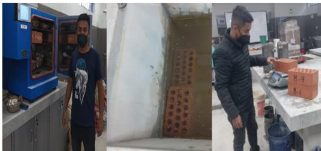
Imagen 19. Procedimiento para saber el porcentaje de absorción del ladrillo
