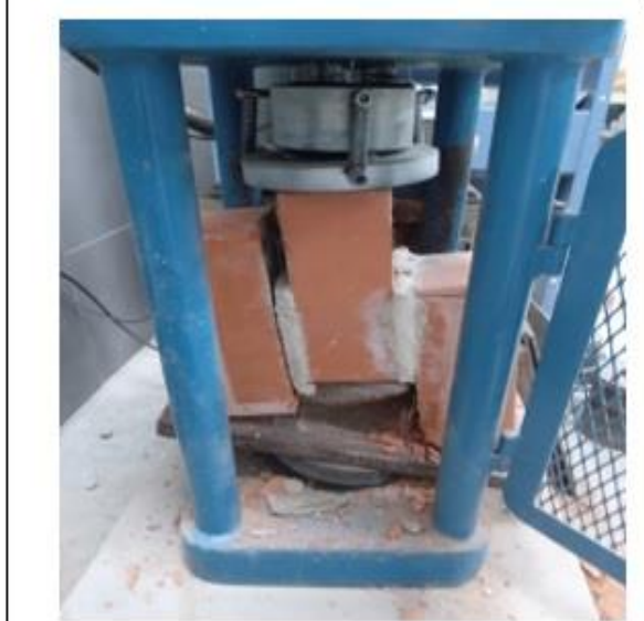
Imagen 65: Ensayo de resistencia a la adherencia a cizalle en pilas de albañilería con 0.05% NPG
