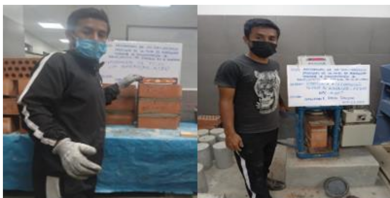
Imagen 28. Muestra de pilas para ser analizados a los 28 días
