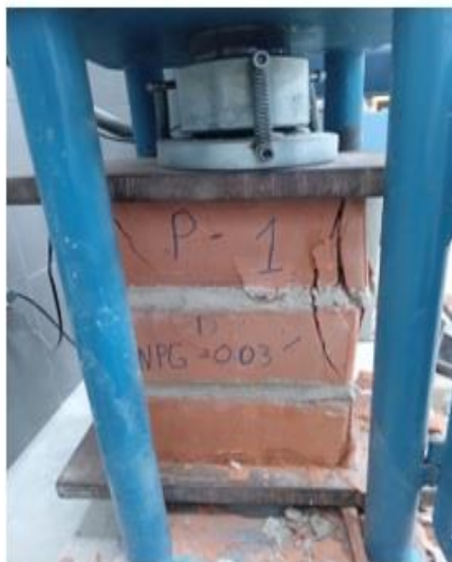
Imagen 61: Ensayo de resistencia a compresión en pilas de albañilería con 0.03% NPG
