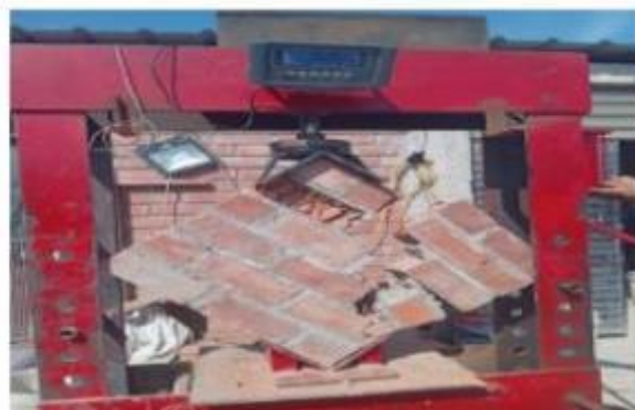
Imagen 68: Murete con mortero patrón con 0.03% NPG alcanzó V'm = 9262 kg
