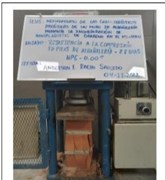
Imagen 59: Ensayo de resistencia a compresión en pilas de albañilería con 0.00% NPG
