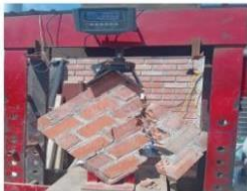
Imagen 69: Murete con mortero patrón con 0.05% NPG alcanzó V'm = 12333 kg
