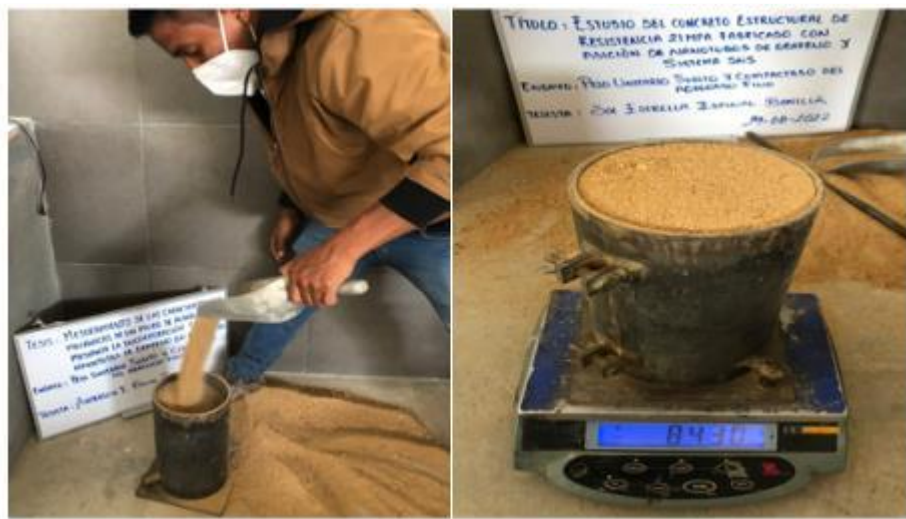
Imagen 13. Procedimiento del ensayo para calcular el PUS
