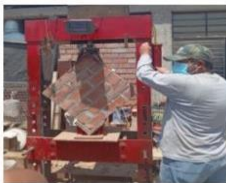
Imagen 71: Laboratorista verificando la realización del ensayo de resistencia a compresión diagonal en muretes
