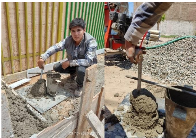
Ilustración 25. Ensayo de cono de abrams en campo
