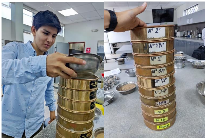
Ilustración 14. Realización de granulometría de agregados
