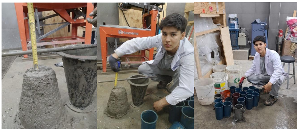
Ilustración 19. Medición de slump
