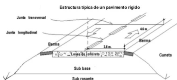
Ilustración 3. Estructura de un pavimento rígido
