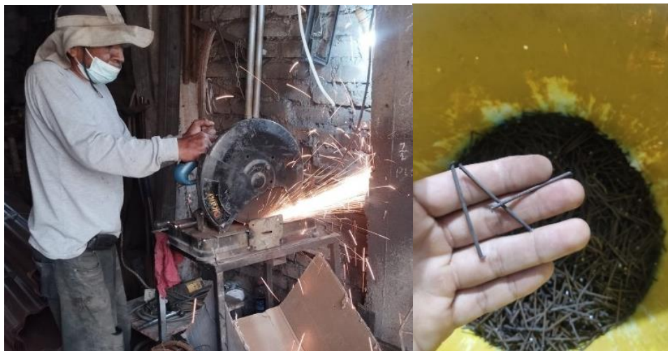
Ilustración 11. Corte de alambre reciclado N° 16
