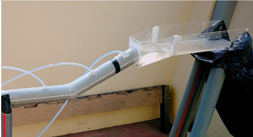
Fig. 31. Cámara de salida del modelo hidráulico
