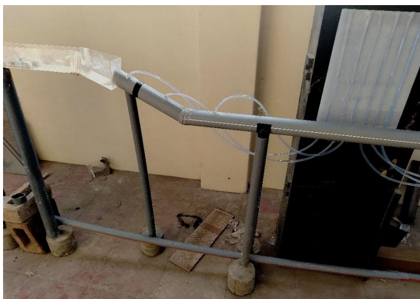
Fig. 30. Cámara de entrada del modelo hidráulico
