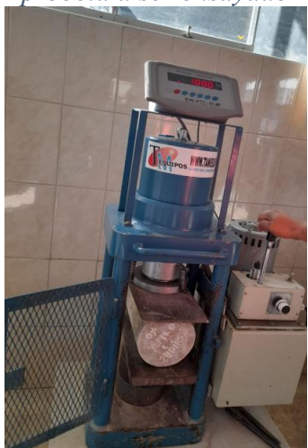
Ilustración 54: Posición adecuada de probeta a ser ensayado
