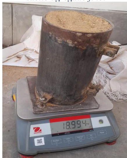
Ilustración 28: Peso volumétrico suelto agregado fino.
