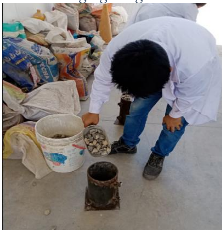
Ilustración 31: Tesista llenando el molde con muestra de agregado grueso
