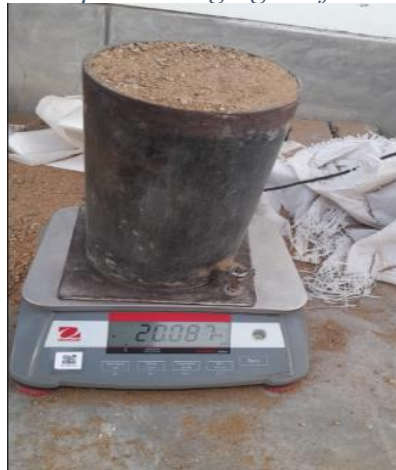
Ilustración 30: peso volumétrico compactado agregado fino.
