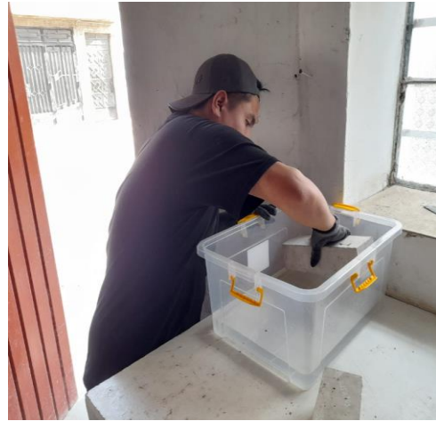
Ilustración 64: Tesista curando los especímenes
