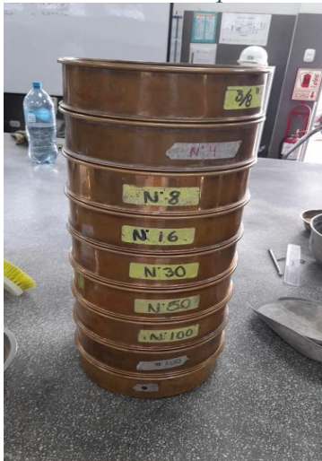
Ilustración 35: Tamices para el ensayo
