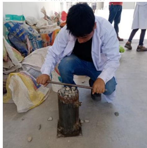
Ilustración 32: luego se Enraza al final del llenado de muestra
