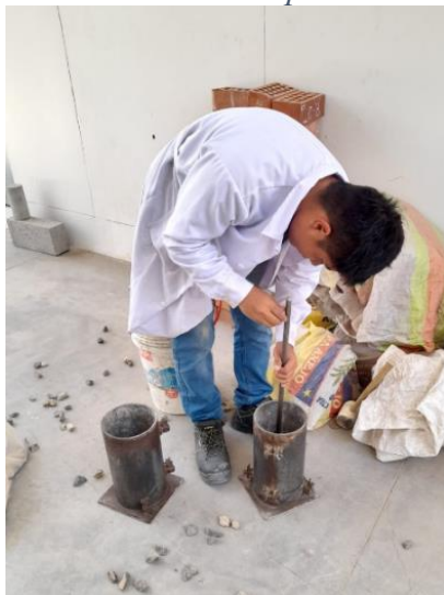
Ilustración 33: Tesista haciendo el Apisonado por capa para peso volumétrico compactado
