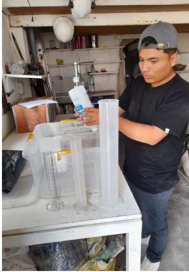
Ilustración 63: Tesista mezclando en una bandeja el Sulfato de Sodio-Agua destilada-Agua potable para poder curar las muestras
