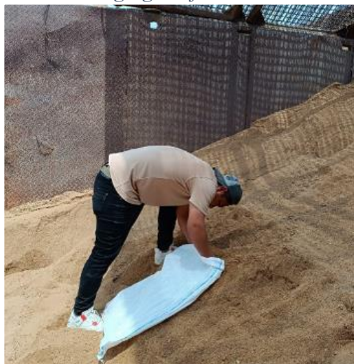
Ilustración 18: Tesista obteniendo muestra de agregado fino
