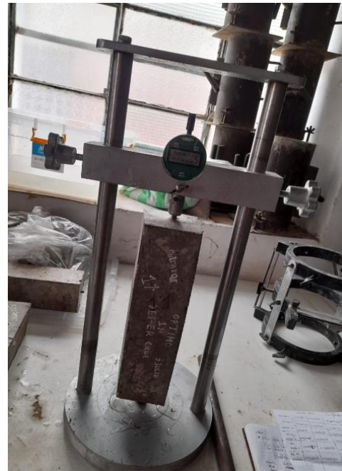
Ilustración 66: Toma de lectura con la máquina de comparación de longitud
