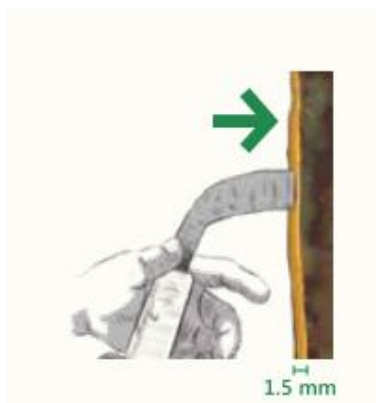
Ilustración 2: Profundidad de picado 1.5mm
