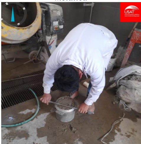
Ilustración 49: Tesista enrasando la olla para después colocar la tapa metálica
