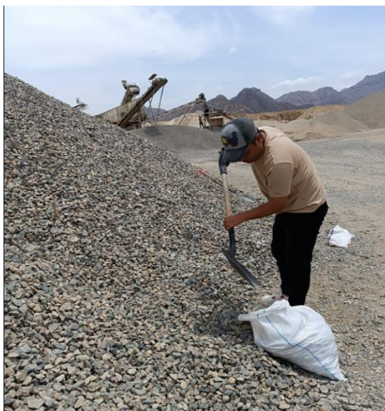
Ilustración 16: Tesista obteniendo muestra de agregado grueso
