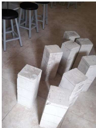
Ilustración 58: Vigas listo para realizar en ensayo de Flexión
