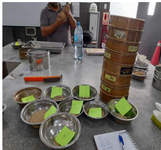
Ilustración 36: Distribución de los agregados de cada tamiz
