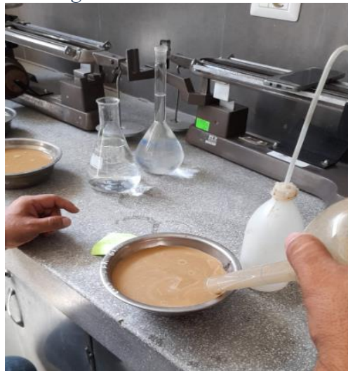
Ilustración 41: Muestra en Tara para luego introducirla en el horno
