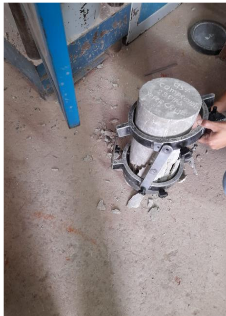
Ilustración 62: Testigo ensayada - Módulo de elasticidad
