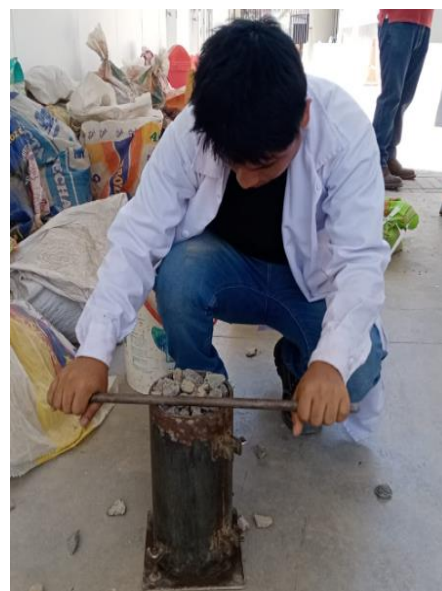
Ilustración 34: Enrazar final para luego pesar muestra.
