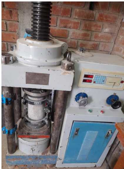
Ilustración 61: Posición de muestra para ser ensayado - Módulo de elasticidad
