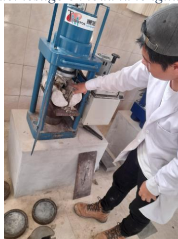
Ilustración 55: Tesista observando la falla del testigo en toda la longitud
