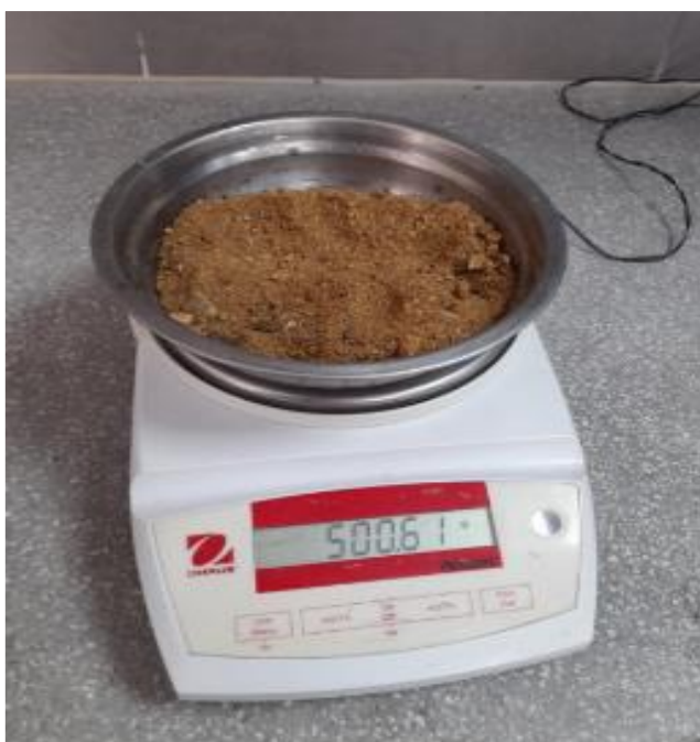
Ilustración 24: Agregado fino para ensayo de Humedad
