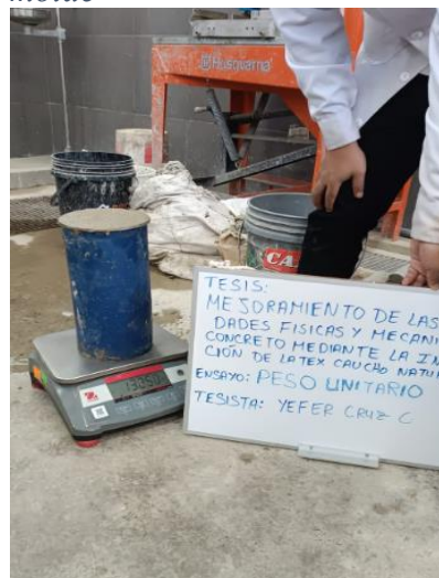
Ilustración 48: Peso de la muestra + molde
