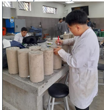
Ilustración 52: Marcación de probetas para poder identificarlo
