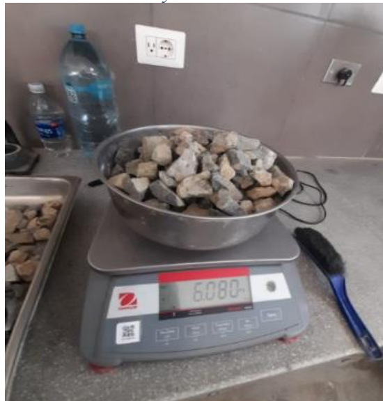
Ilustración 26: Agregado grueso para ensayo humedad
