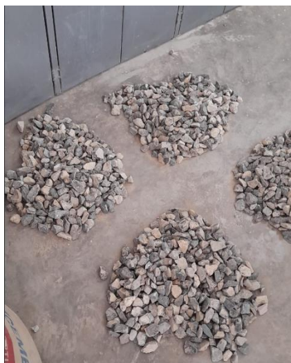
Ilustración 37: Cuarteo del material
