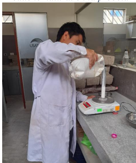
Ilustración 43: Tesista colocando el látex de caucho natural en la probeta
