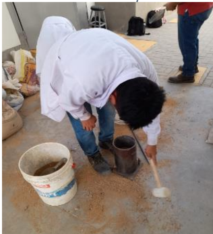
Ilustración 29: Tesista dándole golpes con martillo de goma por capa para peso volumétrico compactado
