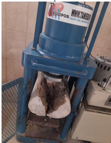
Ilustración 56: Falla de espécimen en toda su longitud
