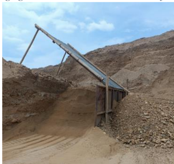
Ilustración 19: Malla de tamizado de agregado fino
