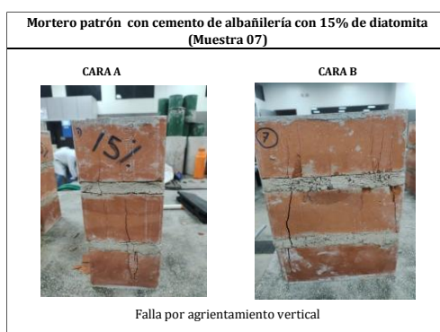
Ilustración 20: Falla N°07 Mortero con 85% cemento de albañilería + 15% de diatomita
