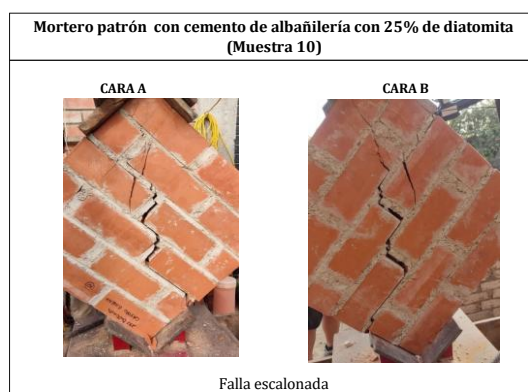
Ilustración 39: Falla N°10 Mortero con 75% cemento de albañilería + 25% de diatomita
