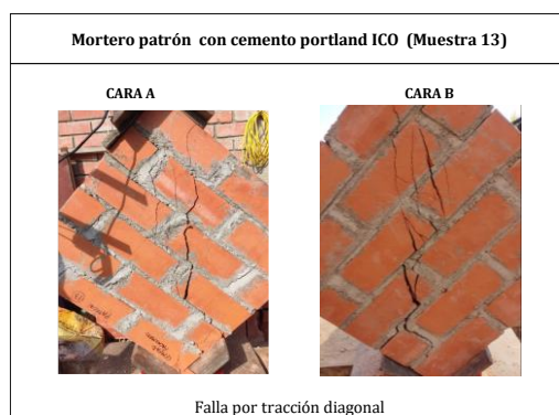
Ilustración 42: Falla del murete N°13 Mortero con cemento portland ICO
