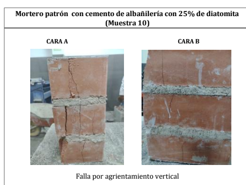
Ilustración 23: Falla N°10 Mortero con 75% cemento de albañilería + 25% de diatomita
