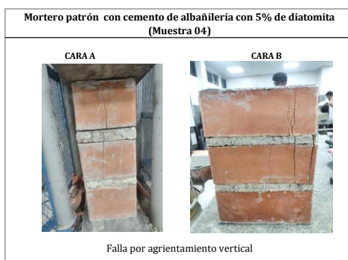
Ilustración 17: Falla N°04 Mortero con 95% cemento de albañilería + 5% de diatomita
