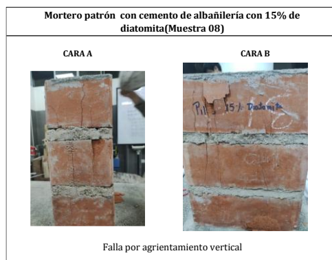
Ilustración 21: Falla N°08 Mortero con 85% cemento de albañilería + 15% de diatomita
