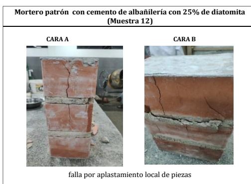
Ilustración 25: Falla N°12 Mortero con 75% cemento de albañilería + 25% de diatomita
