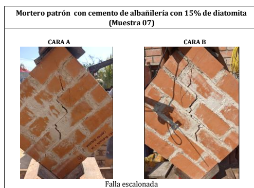
Ilustración 36: Falla N°07 Mortero con 85% cemento de albañilería + 15% de diatomita
