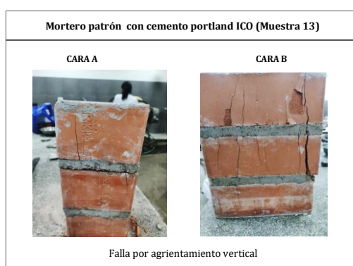
Ilustración 26: Falla de la pila N°13 Mortero con cemento portland tipo ICO
