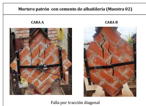
Ilustración 31: Falla del murete N°02 Mortero patrón con cemento de albañilería
