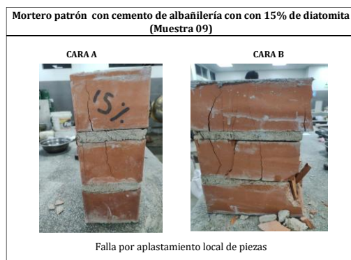
Ilustración 22: Falla N°09 Mortero con 85% cemento de albañilería + 15% de diatomita
