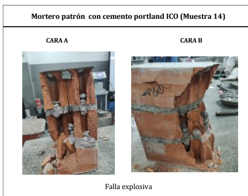
Ilustración 27: Falla de la pila N°14 Mortero con cemento portland tipo ICO
