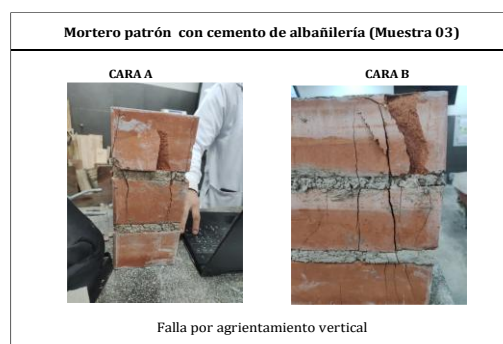
Ilustración 16: Falla de la pila N°03 Mortero patrón con cemento de albañilería
