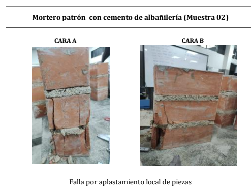
Ilustración 15: Falla de la pila N°02 Mortero patrón con cemento de albañilería
