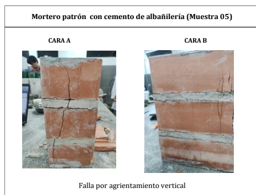
Ilustración 18: Falla N°05 Mortero con 95% cemento de albañilería + 5% de diatomita
