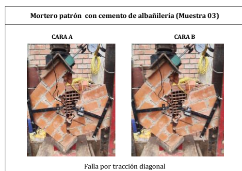
Ilustración 32: Falla del murete N°03 Mortero patrón con cemento de albañilería
