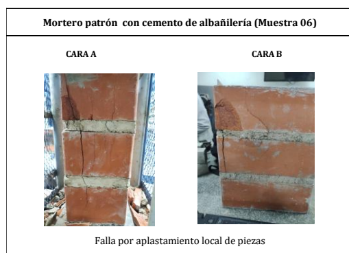
Ilustración 19: Falla N°06 Mortero con 95% cemento de albañilería + 5% de diatomita
