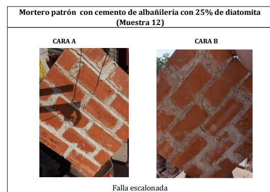
Ilustración 41: Falla N°12 Mortero con 75% cemento de albañilería + 25% de diatomita
