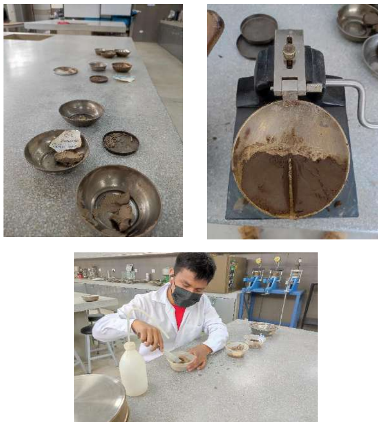
Foto No. 3: Preparación de las muestras y ejecución del ensayo de límites de consistencia
