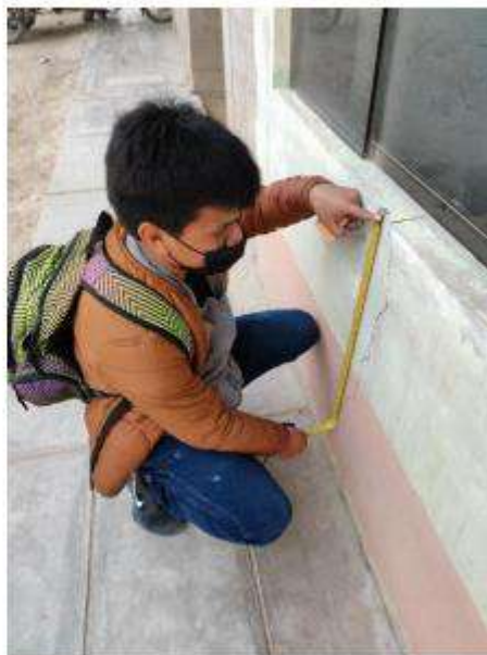
Foto No. 8: Recolección de datos en las áreas de los muros afectados por las fisuras y grietas
