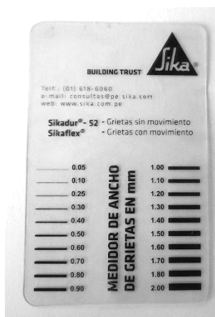
Ilustración 20. Regla para la medición de fisuras
