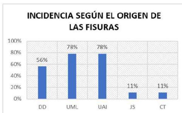
Ilustración 122. Incidencia según el origen de las fisuras - Vivienda 2
