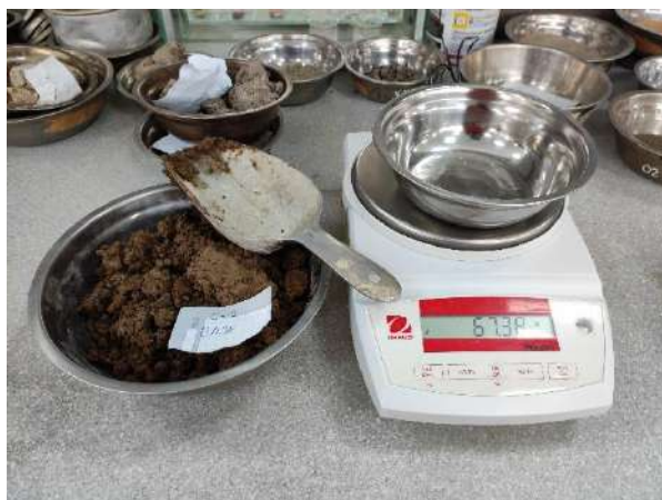
Foto No. 2: Realización del ensayo de análisis granulométrico por tamizado
