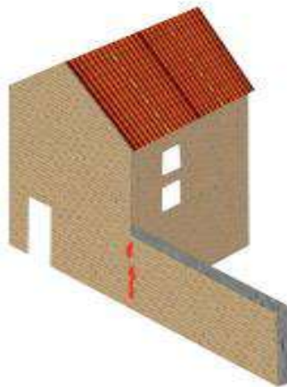
Ilustración 15. Fisuración por sometimiento a estados de carga diferentes
