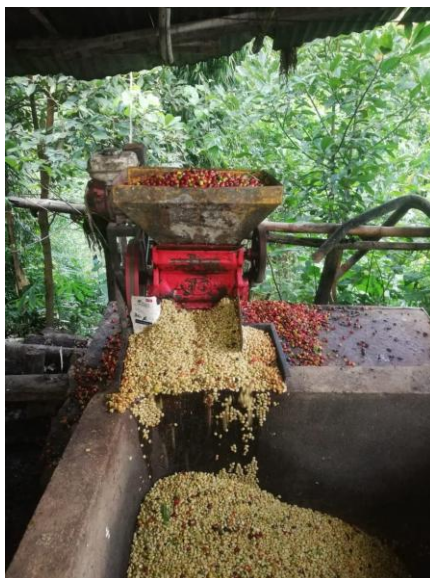
Figura 1A: Despulpado de café Fuente: Propia
