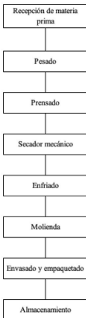
Figura 17A: Diagrama de bloques del proceso para la elaboración de harina de pulpa de café
