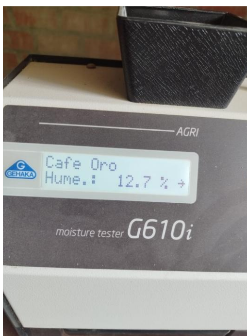
Figura 19 E: Medición de humedad de la pulpa de café Fuente: Campo cafetero fundo "Lalangui"
