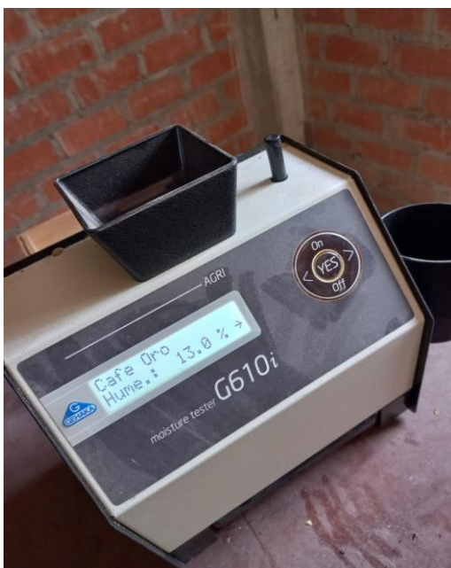
Figura 19 D: Medición de humedad de los granos de café Fuente: Campo cafetero fundo "Lalangui"
