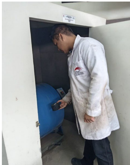
Fig 39. Colocando briqueta en la máquina de los ángeles. Fuente: Propia
