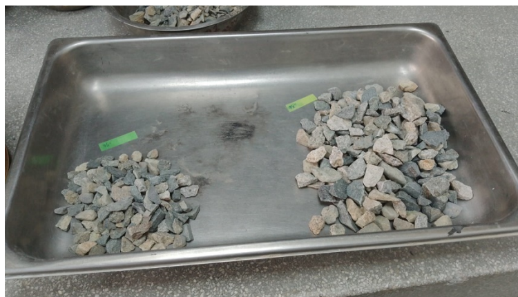
Fig 11. Muestras retenidas en sus mallas correspondientes. Fuente: Propia
