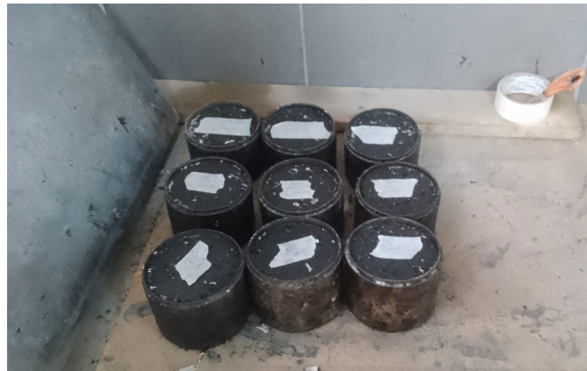
Fig 37. Elaboración de briquetas para cántabro.
