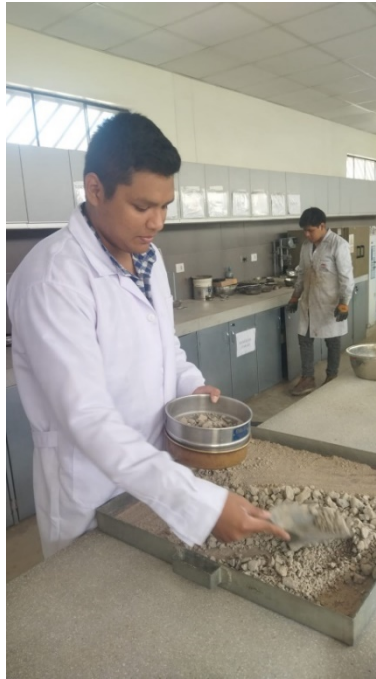
Fig 14. Muestra tamizada por la malla N°10. Fuente: Propia
