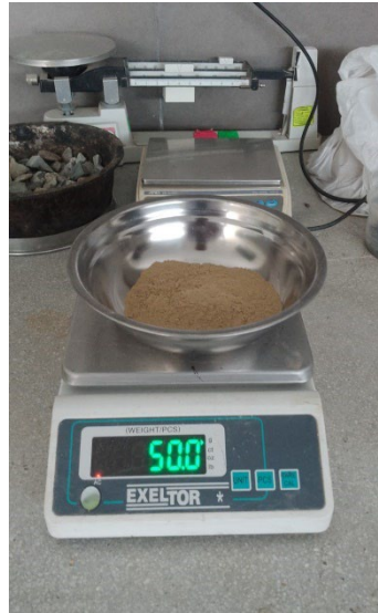
Fig 24. Muestra tamizada por la malla N°200.
