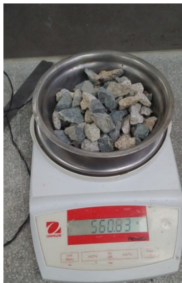
Fig 13. Caras angulares. Fuente: Propia
