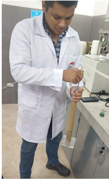
Fig 22. Vertido de muestra en los cilindros. Fuente: Propia
