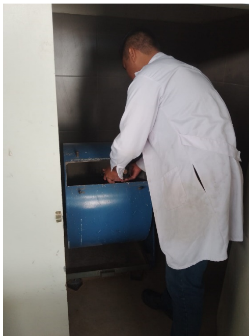
Fig 7. Colocación de la muestra en la Máquina de los Ángeles. Fuente: Propia
