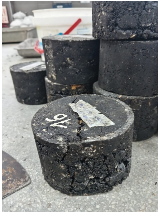
Fig 44. Briqueta ensayada. Fuente: Propia
