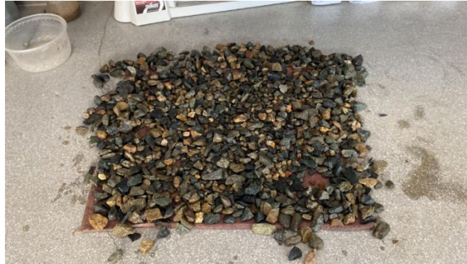
Fig 4. Muestra saturada superficialmente seca. Fuente: Propia
