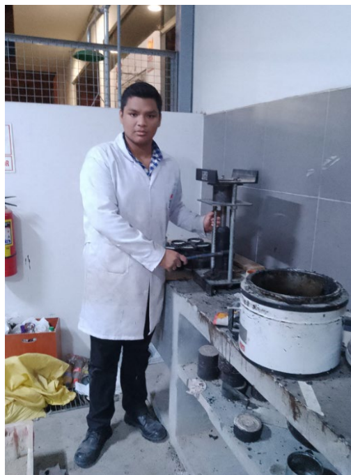
Fig 28. Desmoldado de briquetas. Fuente: Propia
