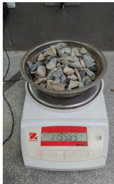
Fig 19. Pesado del agregado grueso. Fuente: Propia
