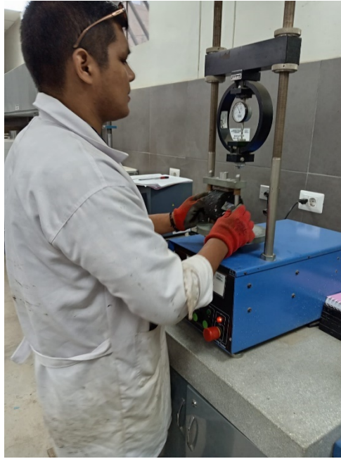
Fig 43. Briqueta sometida a tracción indirecta. Fuente: Propia
