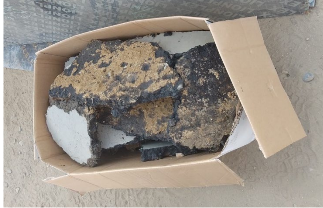
Fig 35. Carpeta asfáltica reciclada.
