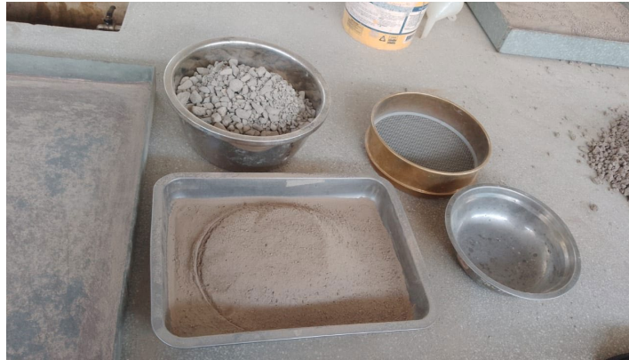
Fig 8. Material resultante de la Máquina de los Ángeles. Fuente: Propia
