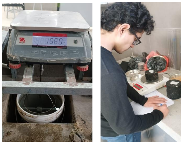
FIGURA 21: Ensayo de peso unitario y peso específico aparente de las briquetas.
