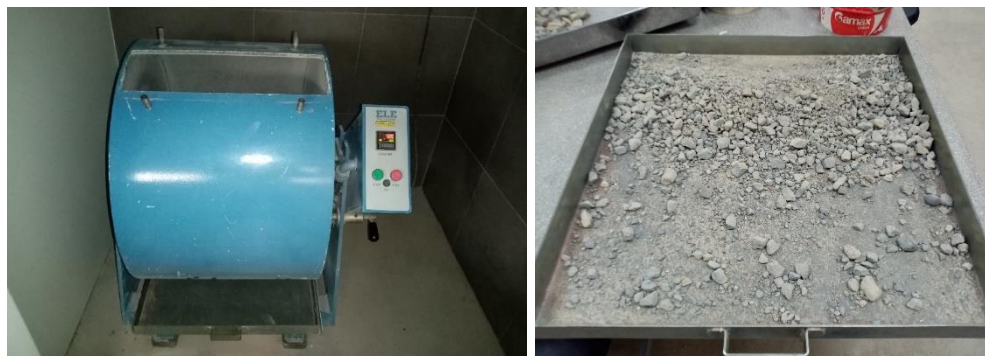
FIGURA 4: Resistencia al desgaste en máquina de los Ángeles
