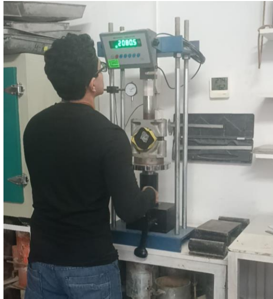
FIGURA 22: Determinación de estabilidad y flujo mediante ensayo Marshall.
