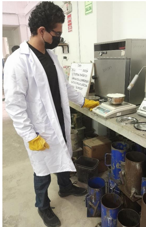
Anexo 2. Designación de materiales, pesaje del polímero y el cemento asfáltico
