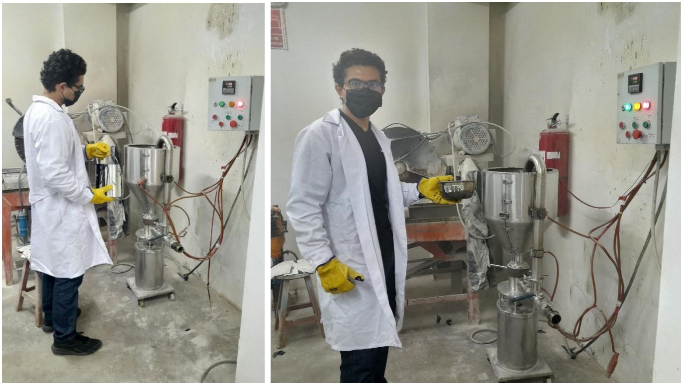
Anexo 3. Vaciado del asfalto y el poliuretano termoplástico (TPU) en el molino coloidal
