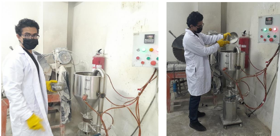
FIGURA 17: Colocación de TPU en el molino coloidal
