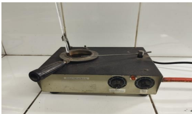
FIGURA 13: Punto de inflamación mediante la copa abierta TAG
