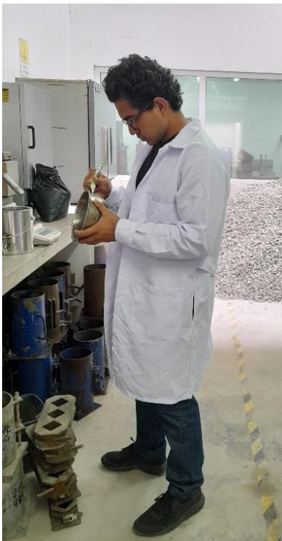
Anexo 2. Designación de materiales, pesaje del polímero y el cemento asfáltico
