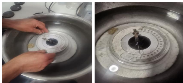
FIGURA 14: Recuperación elástica por torsión
