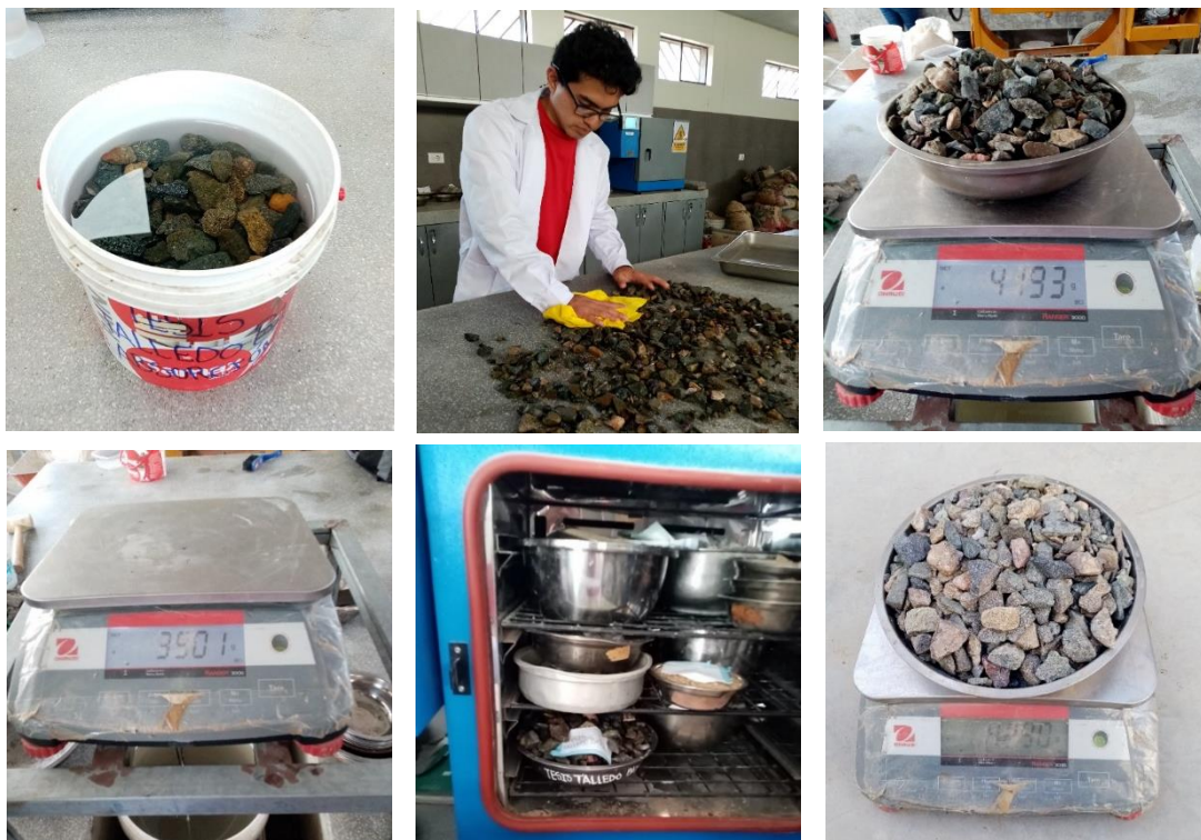
FIGURA 6: Peso específico y absorción de agregados gruesos
