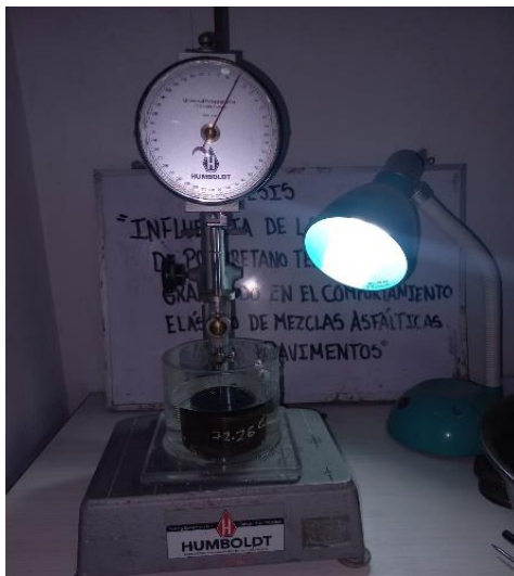
FIGURA 11: Ensayo de Penetración Fuente: Propia, 2023
