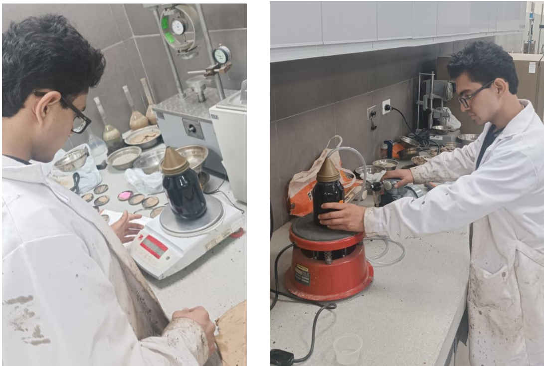
FIGURA 23: Realización del ensayo Rice.
