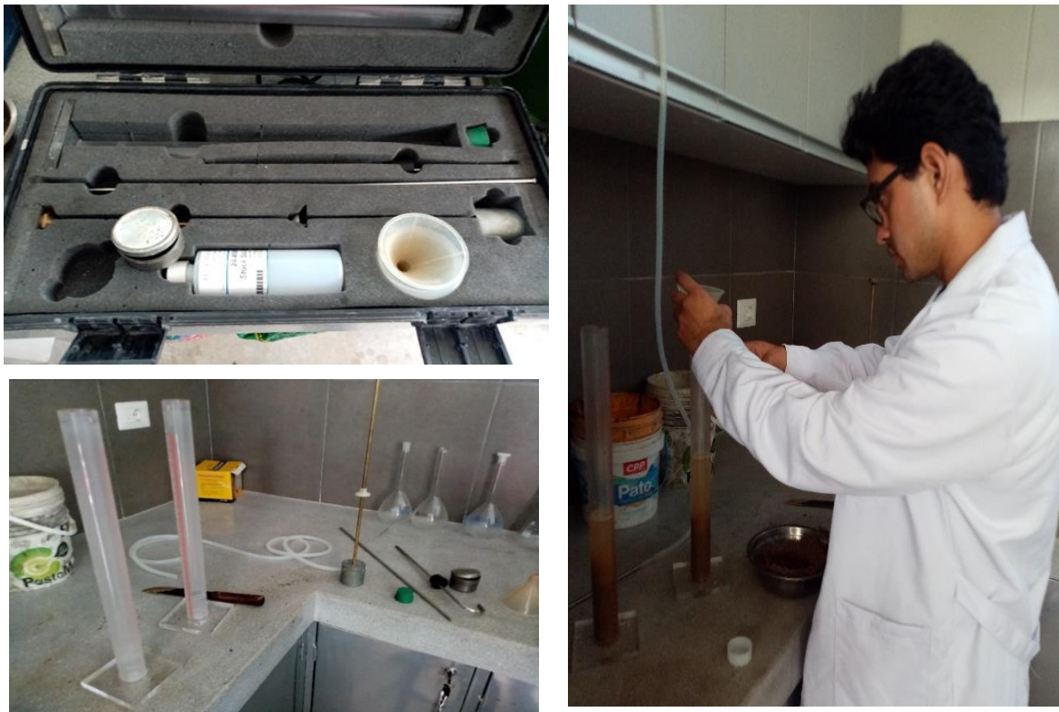
FIGURA 7: Método de Ensayo para el valor de equivalente de arena de Agregado Fino Fuente: Propia, 2023
