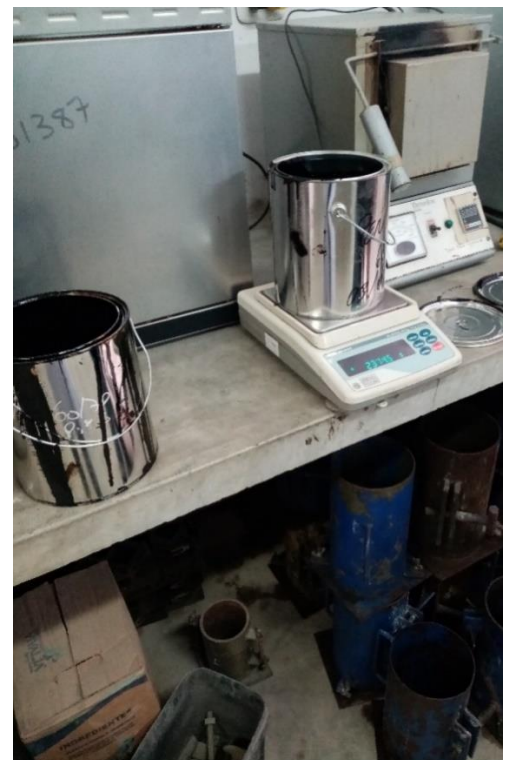
Anexo 2. Designación de materiales, pesaje del polímero y el cemento asfáltico
