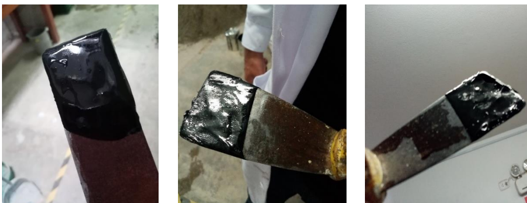
FIGURA 18: Verificando una mezcla homogénea entre cemento asfáltico y TPU (sin trazas).
