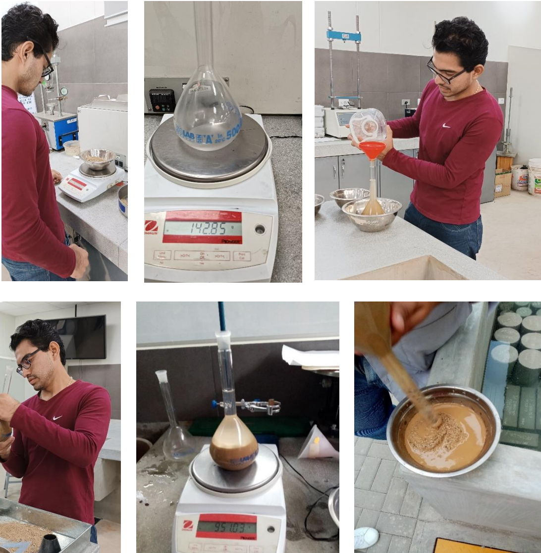
FIGURA 8: Gravedad específica y absorción de agregados finos Fuente: Propia, 2023
