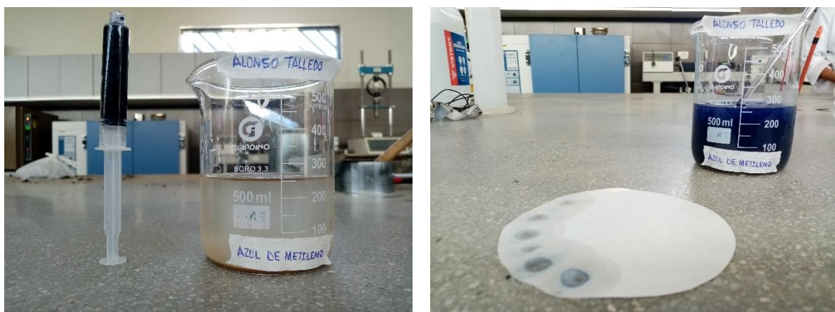
FIGURA 9: Ensayo Azul de metileno Fuente: Propia, 2023
