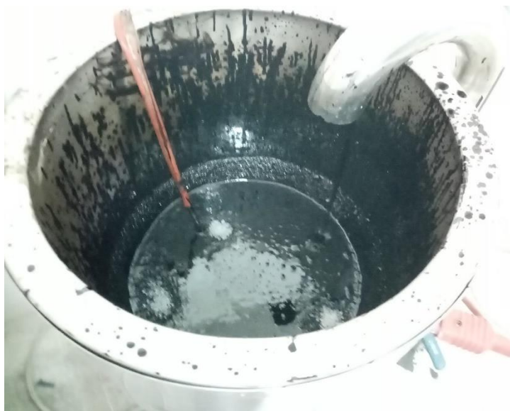
Anexo 4. Proceso de modificación del asfalto en el molino coloidal y su colocación
