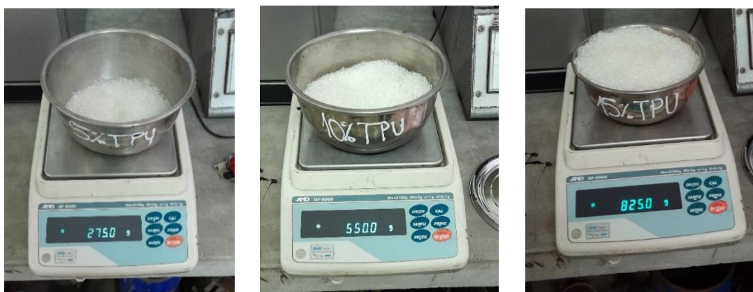
FIGURA 16: Porcentaje de adición de TPU en peso de asfalto.
