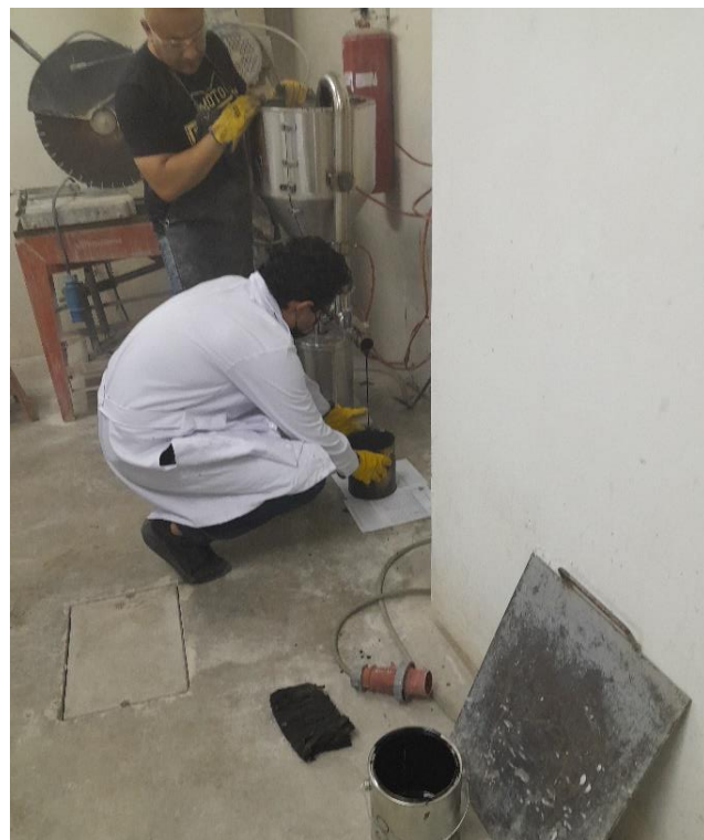
Anexo 4. Proceso de modificación del asfalto en el molino coloidal y su colocación
