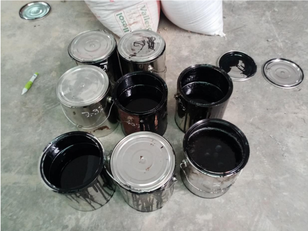
Anexo 5. Recipientes con asfalto modificado con diferentes porcentajes de poliuretano termoplástico (TPU)
