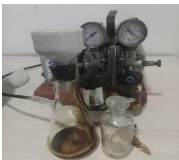
FIGURA 10: Solubilidad de materiales asfálticos en tricloroetileno
