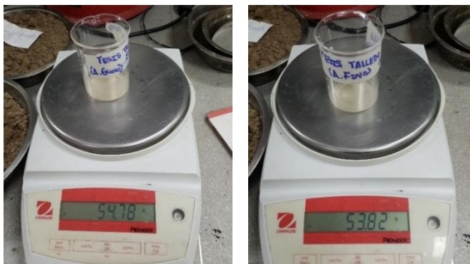
FIGURA 5: Sales solubles en agregados para pavimentos flexibles
