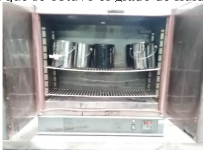
FIGURA 15: Calentamiento del cemento asfáltico.
