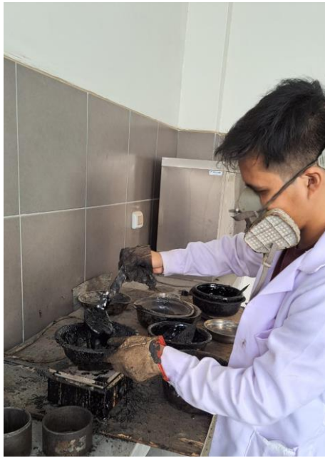
Ilustración 17, Derretimiento del cemento asfáltico y posterior mezclado con los agregados
