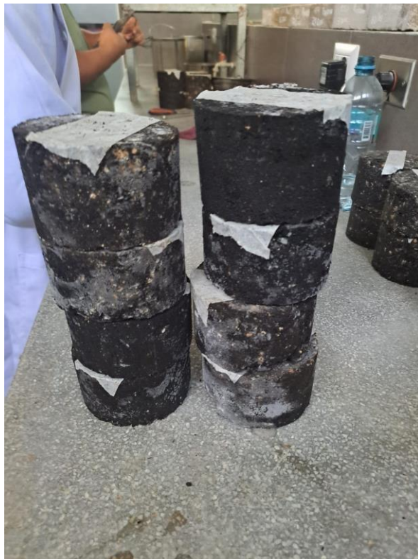
Anexos 10. Muestras sometidas a la humedad
