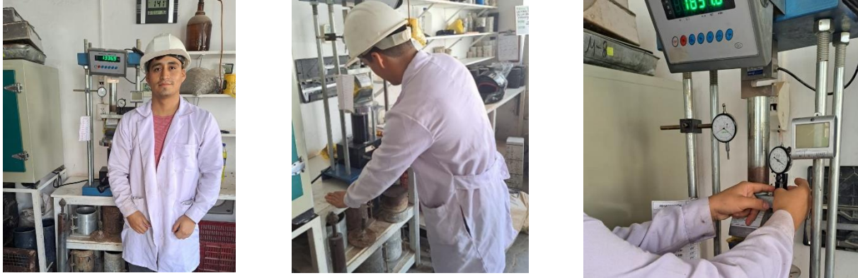
Ilustración 21. Máquina de Marshall. Para determinación de estabilidad y fluencia
