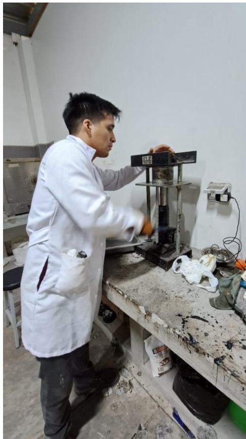
Anexos 4. Proceso de desmoldado de muestras
