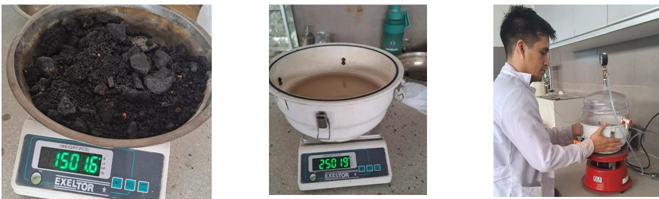
Ilustración 22. Pesaje del material, del envase de Rise y su máquina para retirar el aire
