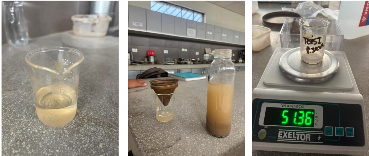
Ilustración 9 Muestreo y filtración de sales solubles de agregado fino
