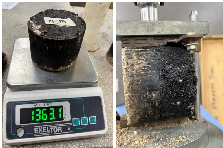
Ilustración 31 Pesaje de muestra y colocación en máquina de ensayo
