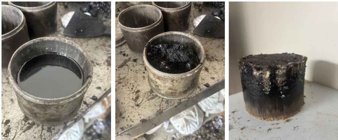
Ilustración 26 Elaboración de la muestra interponiendo el MC-30
