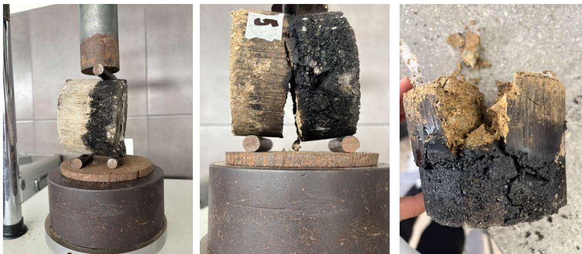
Ilustración 33 Proceso del ensayo hasta su falla de rotura.
