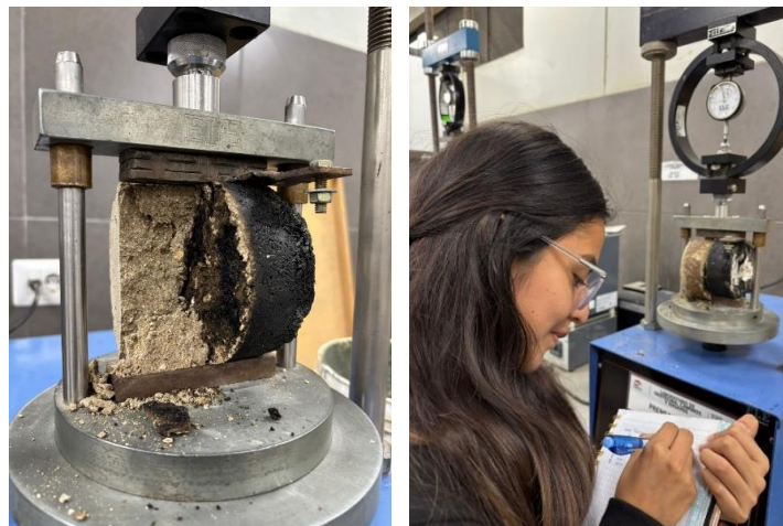
Ilustración 30 Rotura de muestra y toma de datos
