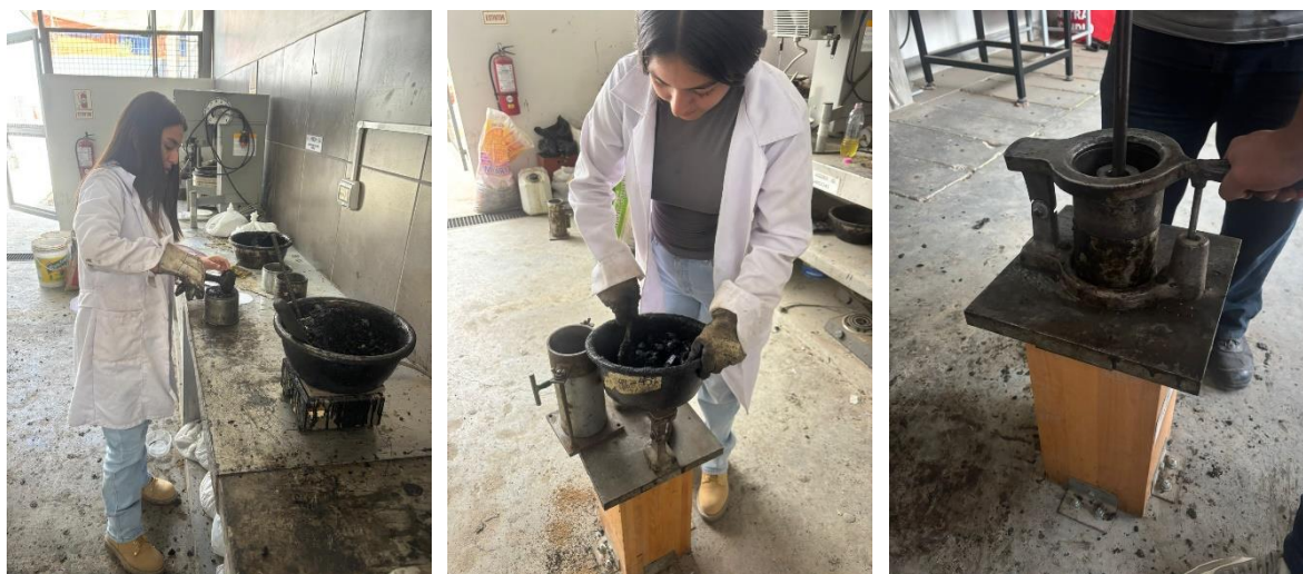
Ilustración 18 Elaboración de briquetas en porcentajes de 4%,4.5%,5%,5.5% y 6%
