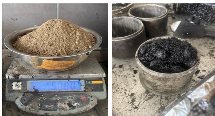
Ilustración 24 Afirmado y asfalto para la formación de capas
