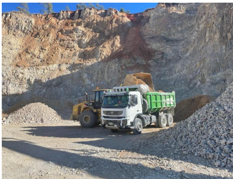
Ilustración 41: Carguío de material por cargador frontal
