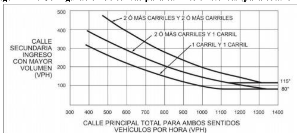
Imagen N° 7: Configuración de curvas para carriles existentes (para cuatro horas)
